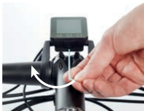
Abbildung 43: Alber Bordcomputer fixieren
