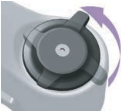
Abbildung 62: Druckstufeneinsteller weicher einstellen
