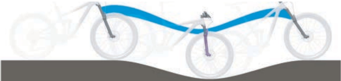
Abbildung 59: Zu weiche Federung der Federgabel am Berg
