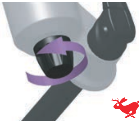
Abbildung 58: Zugstufendämpfer in Richtung Hase drehen
