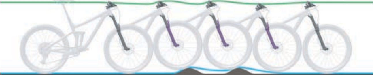
Abbildung 57: Zu langsames Ausfedern der Federgabel
