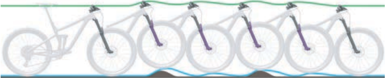
Abbildung 55: Zu schnelles Ausfedern der Federgabel
