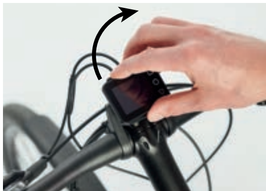
Abbildung 42: Alber Bordcomputer festdrehen
