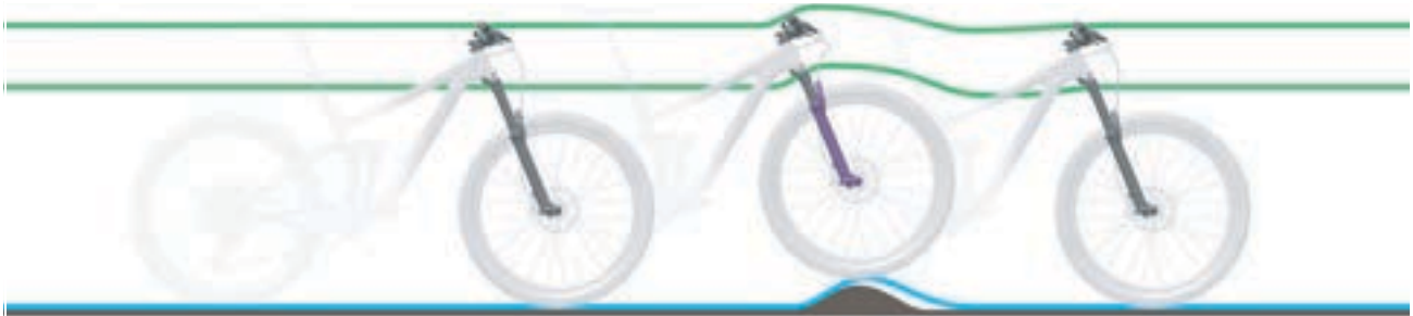
Abbildung 61: Zu harte Dämpfung der Federgabel bei Unebenheiten
