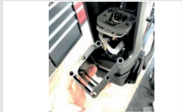
Abbildung 25: PowerTube Adapter herausziehen
