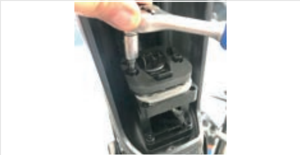
Abbildung 22: Akkuhalter Schrauben lösen
