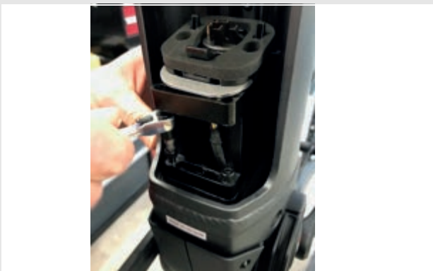
Abbildung 23: 4 mm 6-Kant-Schrauben entfernen
