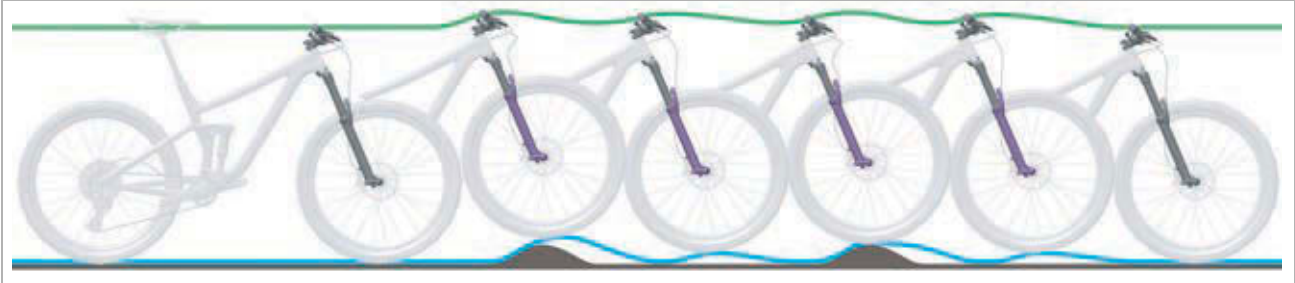
Afbeelding 191: Te snel uitveren van de verende voorvork
