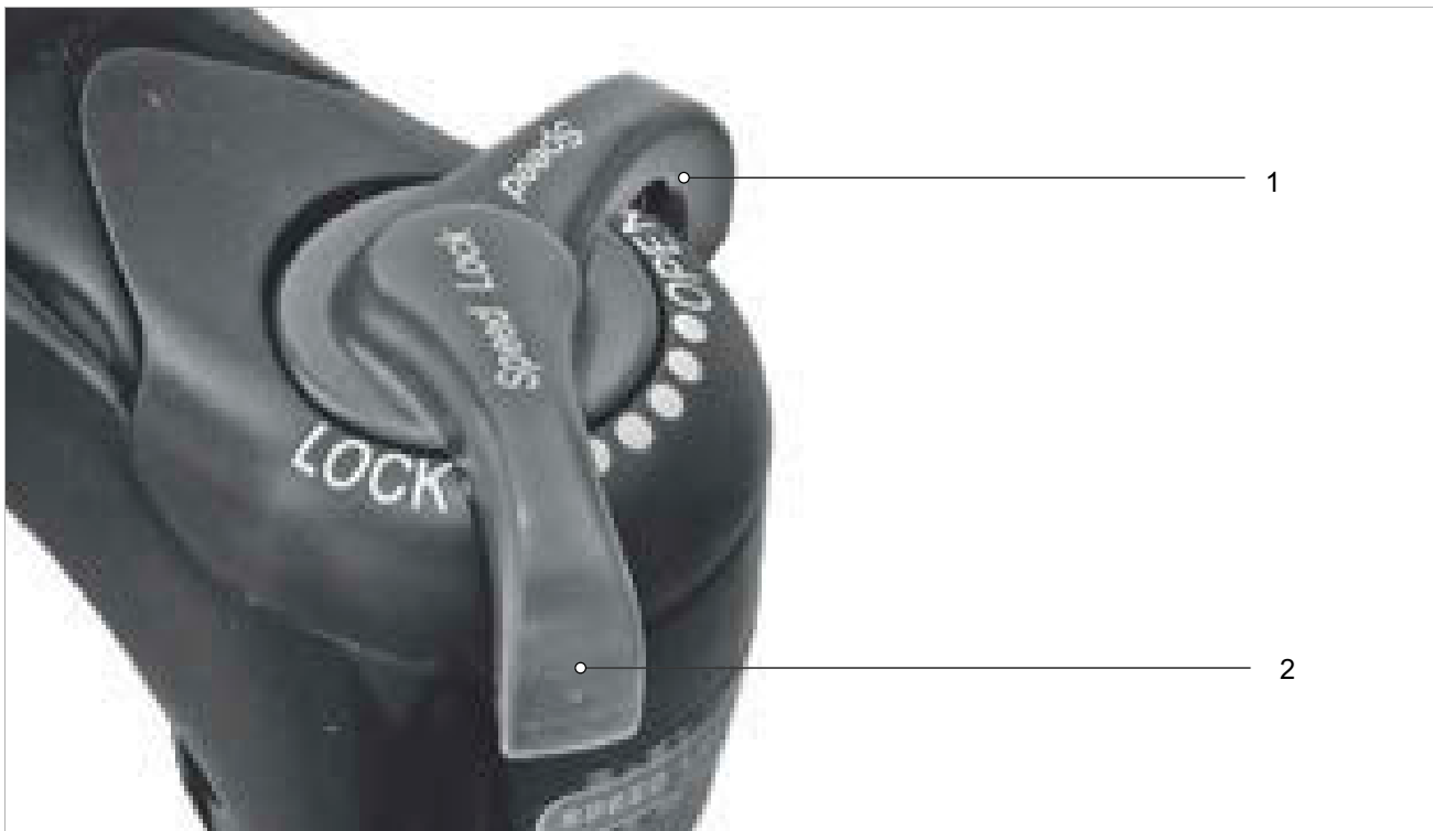
Afbeelding 165: SR SUNTOUR drukdemper in open (1) en gesloten (2) stand
