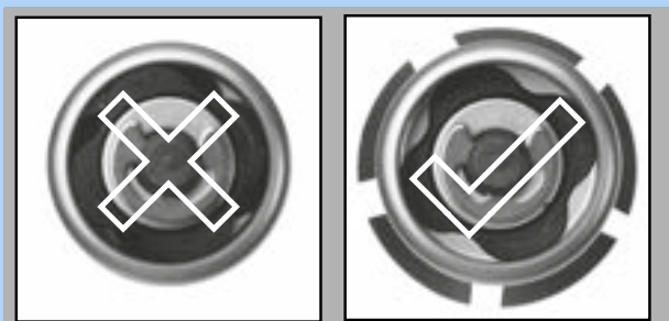
Afbeelding 96: Gesloten en geopende flens
