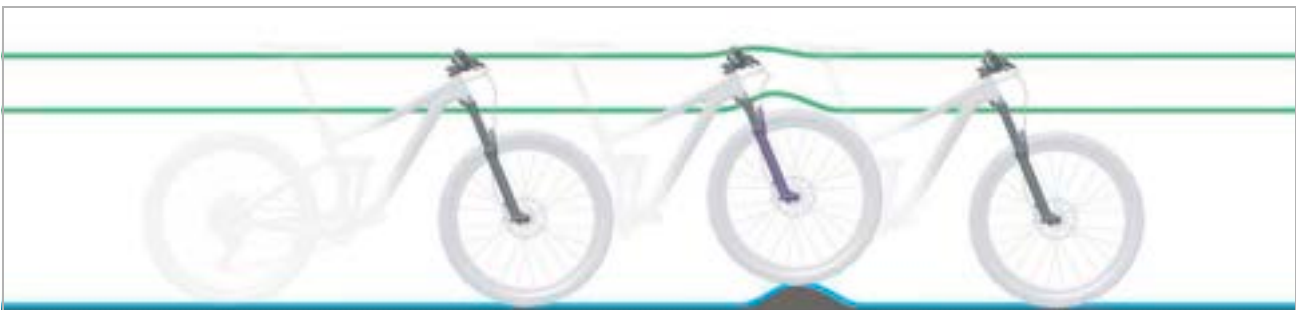
Afbeelding 14: Optimaal rijgedrag van de vork bij oneffenheden
