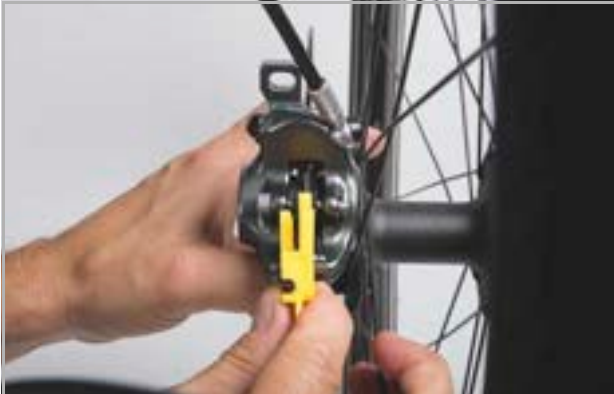
Afbeelding 179: Remvoering in gemonteerde toestand controleren met behulp van de transportbeveiliging
