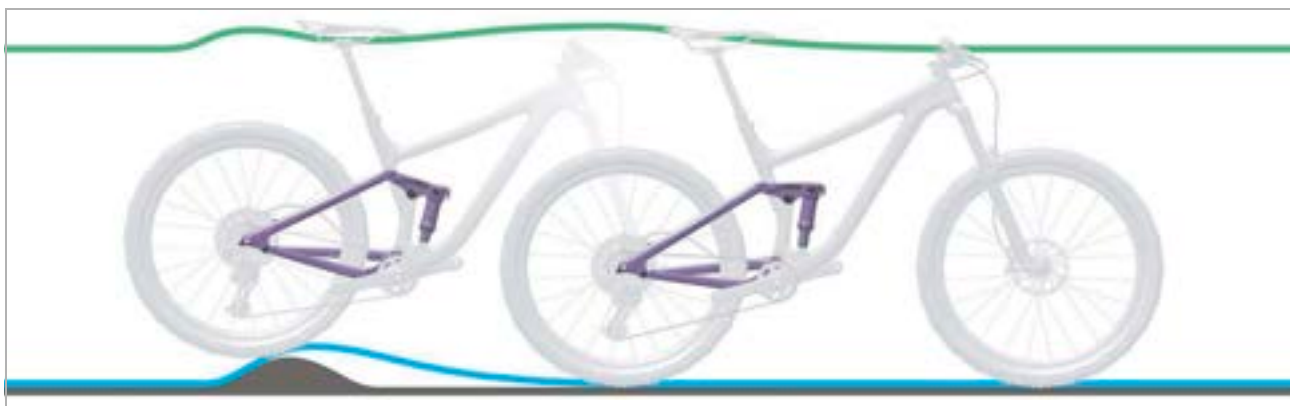
Figura 199: Smorzamento troppo duro dell'ammortizzatore del carro posteriore su asperità
