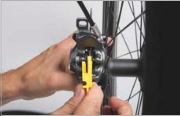
Figura 154: Controllo della guarnizione del freno nello stato montato mediante la sicura di trasporto
