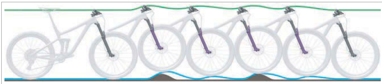
Figura 187: Corsa di estensione troppo veloce della forcella ammortizzata
