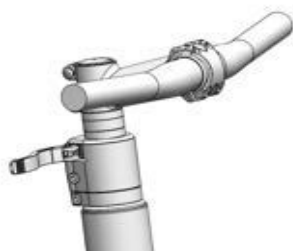
Figura 145: All Up con leva di serraggio dell'attacco manubrio aperta
