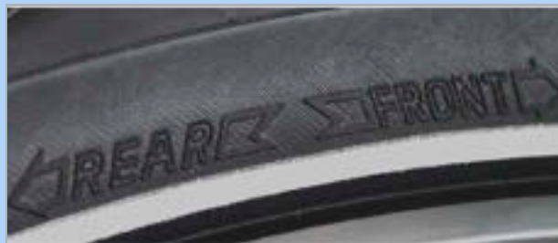
Figura 92: Freccia del senso di rotazione su pneumatici MTB
