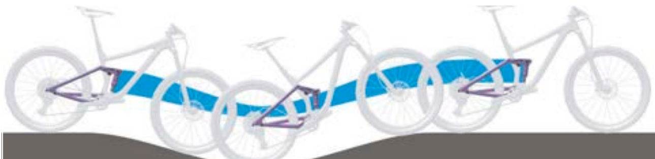
Figura 197: Sospensione dell'ammortizzatore del carro posteriore troppo morbida in salita
