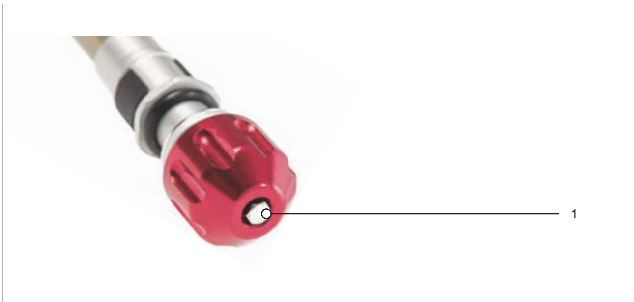
Figura 190: Esempio di vite del rebound (1) SR SUNTOUR
