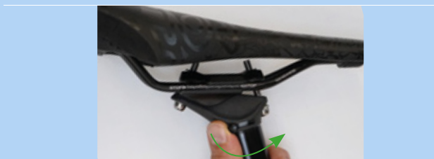
Illustration 213 : Ouvrir le réglage de la hauteur
