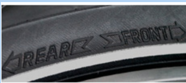
Illustration 70 : Flèche directionnelle sur les pneus VTT
