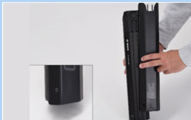
Illustration 68 : Enfoncer le capot de batterie sur la batterie
