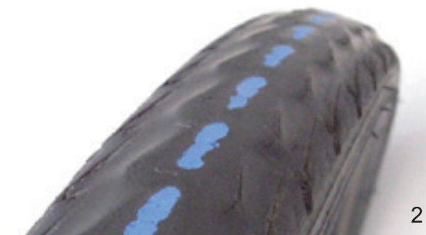
Illustration 149 : Pneu sans profil pouvant encore être utilisé (1) et pneu avec bande de protection visible (2) devant être changé
