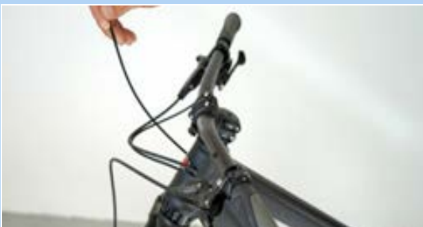
Illustration 221 : Accrocher le capuchon d'extrémité
