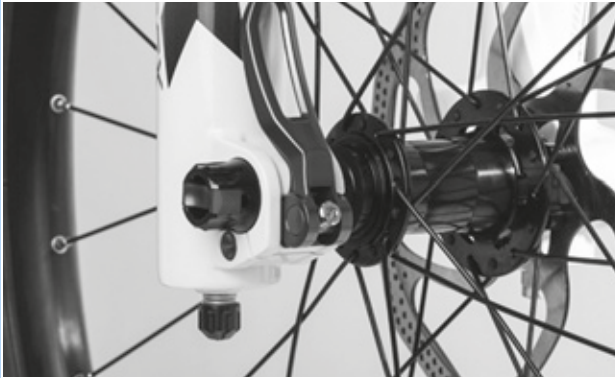
Illustration 159 : Régler la force de serrage de l'attache rapide
