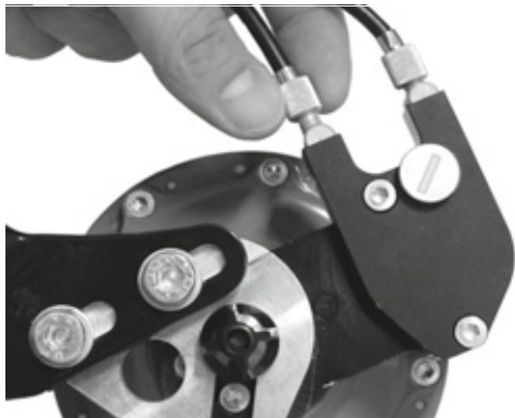
Illustration 155 : Sur les versions de moyeux ROHLOFF avec commande externe du changement de vitesse, le dispositif de réglage de la tension est situé sur le boîtier de câbles qui est placé sur le côté gauche.
