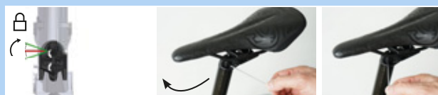
Illustration 199 : Fermer le réglage de la hauteur
