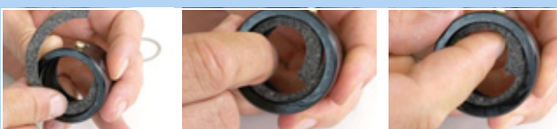
Illustration 210 : Insérer l'anneau de feutre
