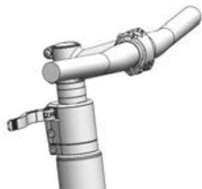
Illustration 142 : Exemple d'un All Up avec levier de serrage de la potence ouvert
