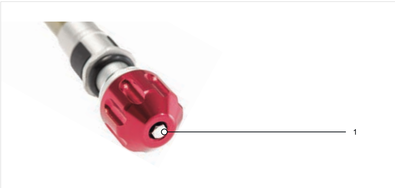
190. ábra: Példa: SR SUNTOUR húzófokozat csavar (1)
