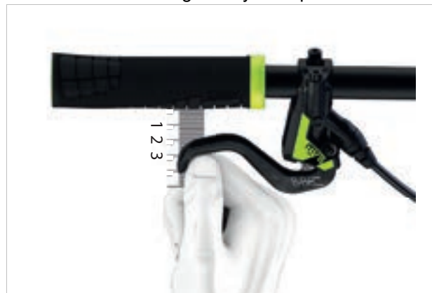
110. ábra: Kézifék pozicionálása
