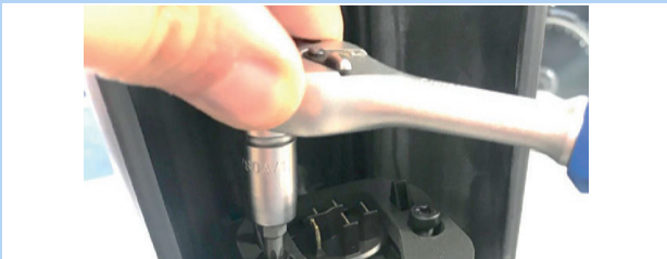
63. ábra: Akkumulátortartó csavarok oldása
