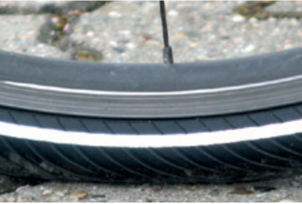
105. ábra: Helyes töltőnyomás. A gumiabroncs alakja a testsúly terhe alatt alig változik
