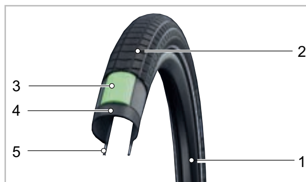
24. ábra: Nyitott gumiabroncsok felépítése
