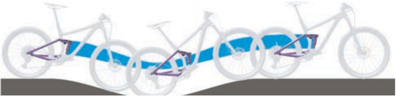
197. ábra: A hátsó lengéscsillapító túl puha rugózása hegymenetben
