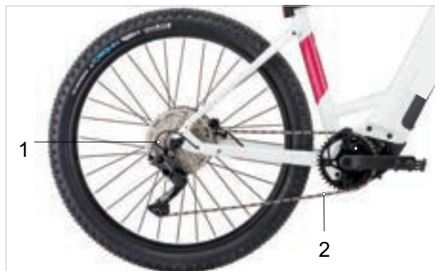
46. ábra: Külső váltóval felszerelt lánchajtás vázlata
