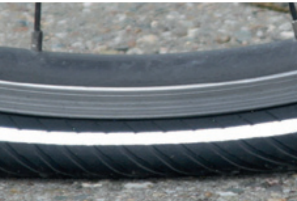
106. ábra: Túl alacsony töltőnyomás
