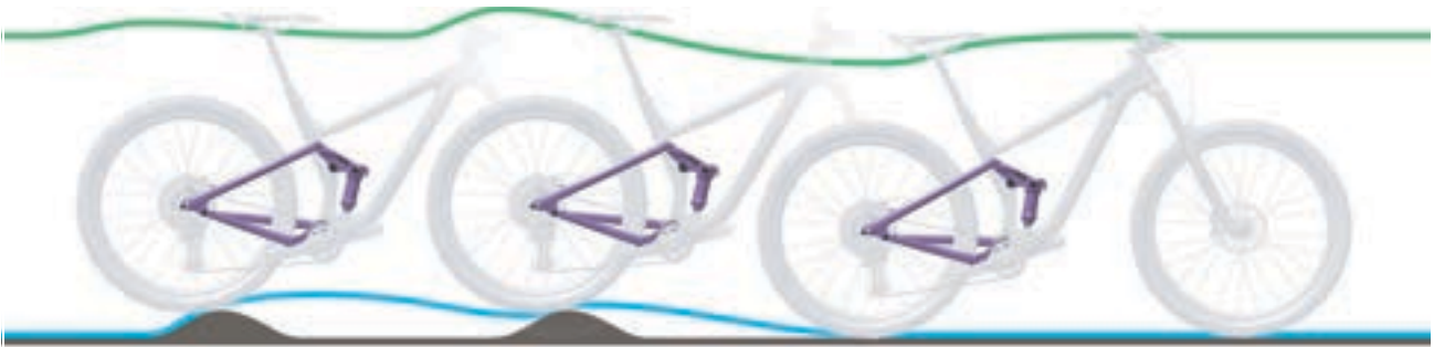
195. ábra: A hátsó lengéscsillapító túl lassú kirugózása
