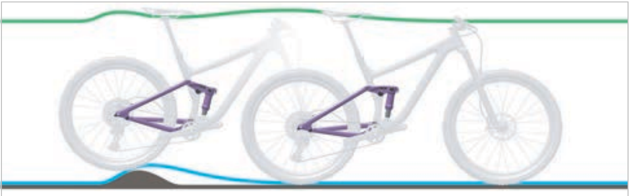
199. ábra: A hátsó lengéscsillapító túl kemény csillapítása egyenetlenségeknél
