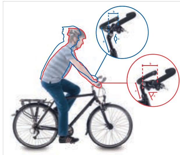
103. ábra: Városi kerékpár (kék) és túrakerékpár (piros) a szög változtatásával
