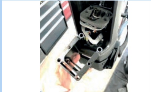
66. ábra: A PowerTube adapter kihúzása
