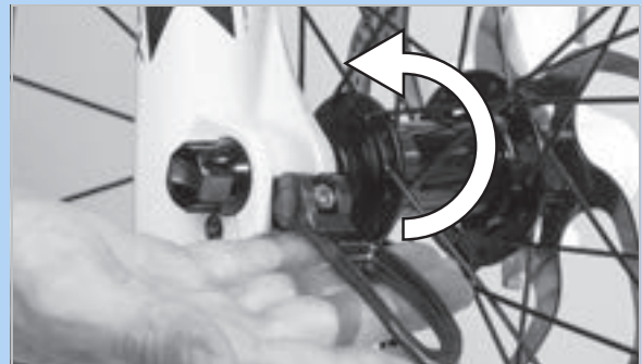
84. ábra: A gyorszár nyomása nyílrányban
