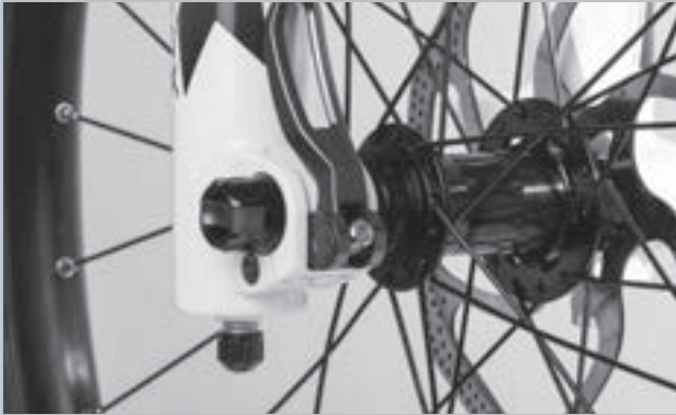
183. ábra: A gyorszár szorítóerejének beállítása
