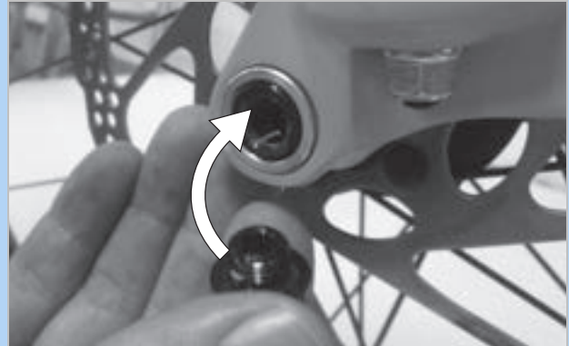
79. ábra: Rögzítőcsavar beszerelése
