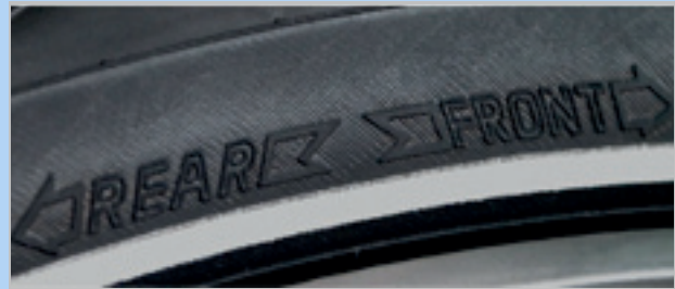
92. ábra: Futásirányjelző nyíl MTB gumiabroncsokon
