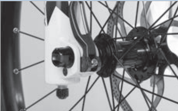
85. ábra: A gyorskioldó kar tökéletes helyzete
