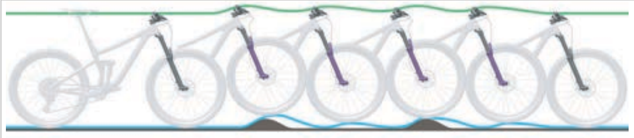
187. ábra: A teleszkópos villa túl gyors kirugózása
