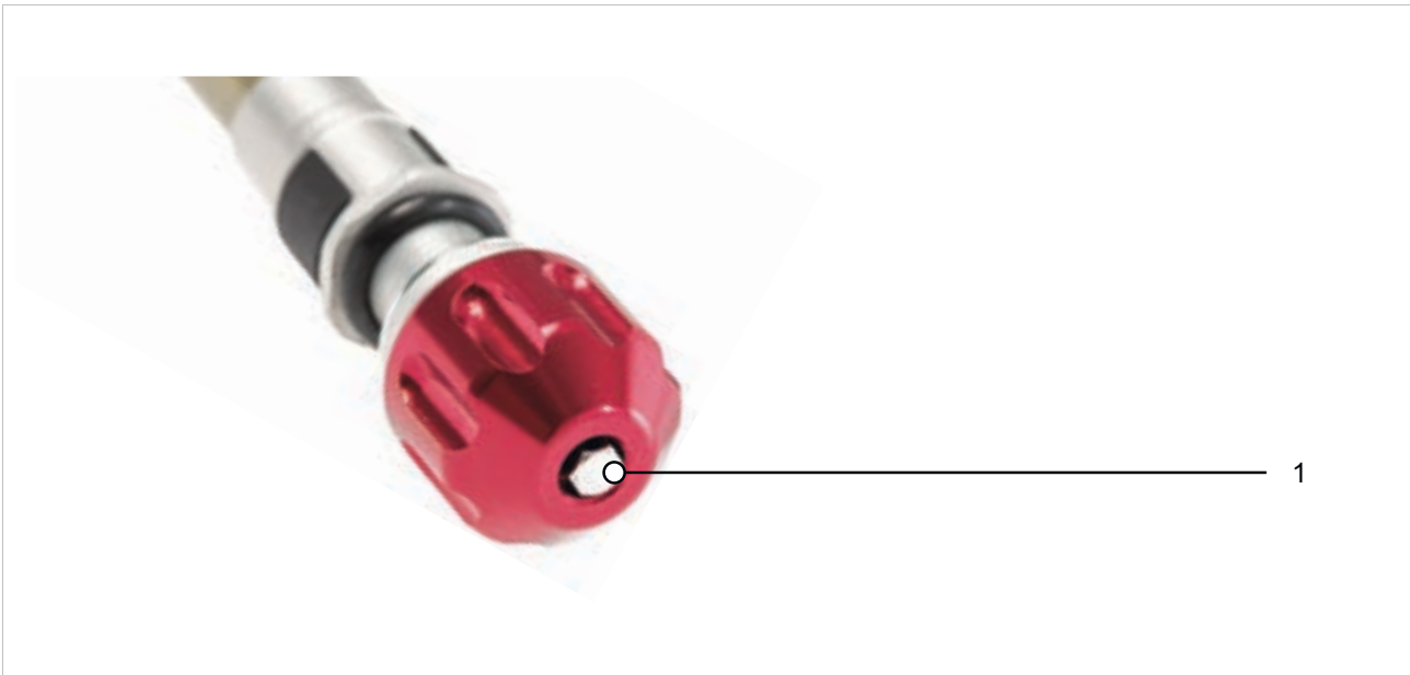
120. ábra: Példa: SR SUNTOUR húzófokozat csavar (1)
