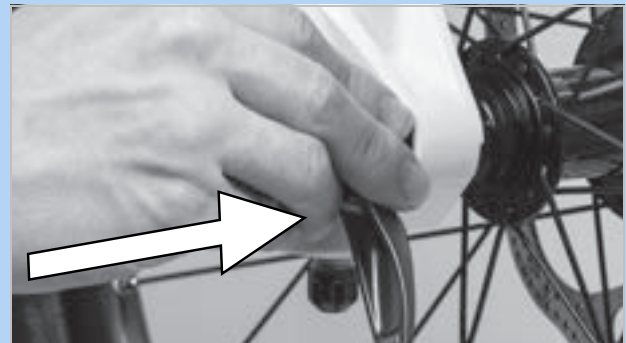
88. ábra: A gyorsár betolása nyilirányban
