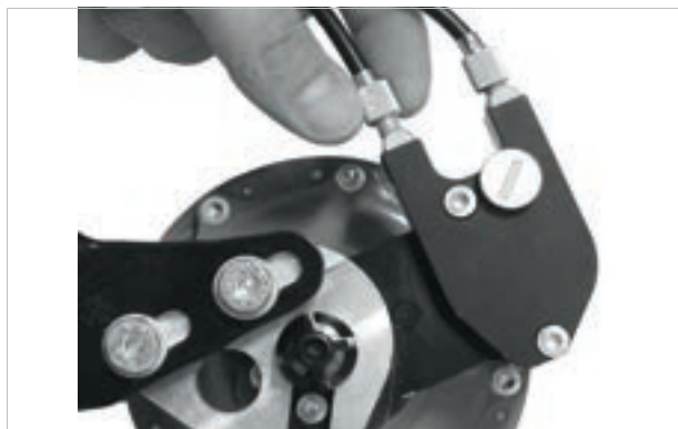
180. ábra: Külső váltóvezérléssel rendelkező ROHLOFF agyváltozatok húzásbeállítója a kötéldobozon van, ami a bal oldalon található
