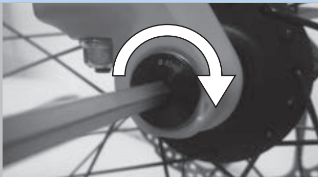
78. ábra: A tengely meghúzása nyílrányban
