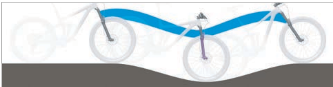
14. ábra: A villa optimális menetviselkedése dombos terepen
