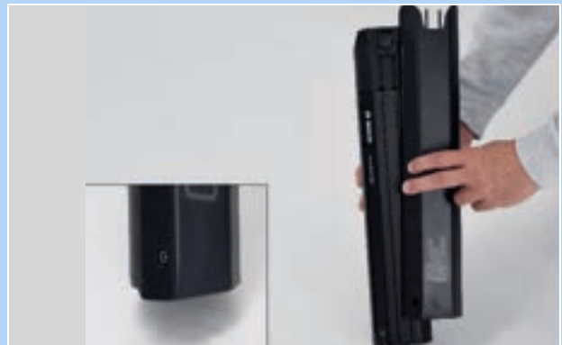
75. ábra: Az akkumulátorfedél rátolása az akkumulátorra
