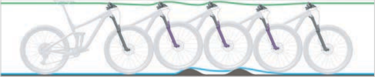
189. ábra: A teleszkópos villa túl lassú kirugózása
