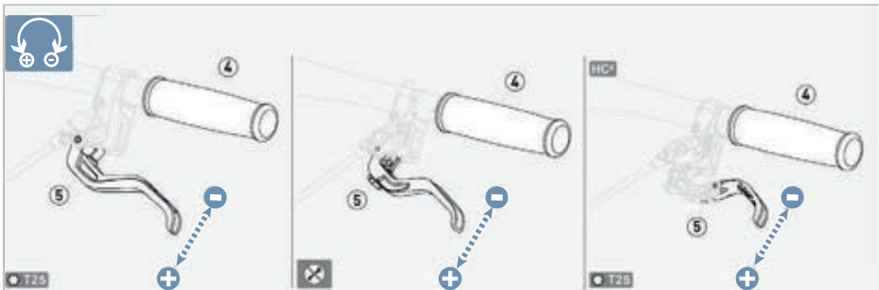
111. ábra: MAGURA kézfék markolatszélesség, a tárcsafék beállítása
