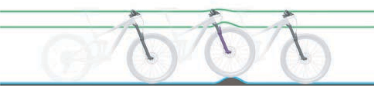
117. ábra: A villa optimális menetviselkedése egyenetlenségek esetén
