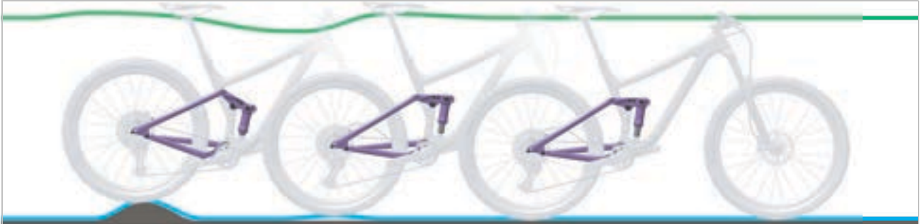
193. ábra: A hátsó lengéscsillapító túl gyors kirugózása
