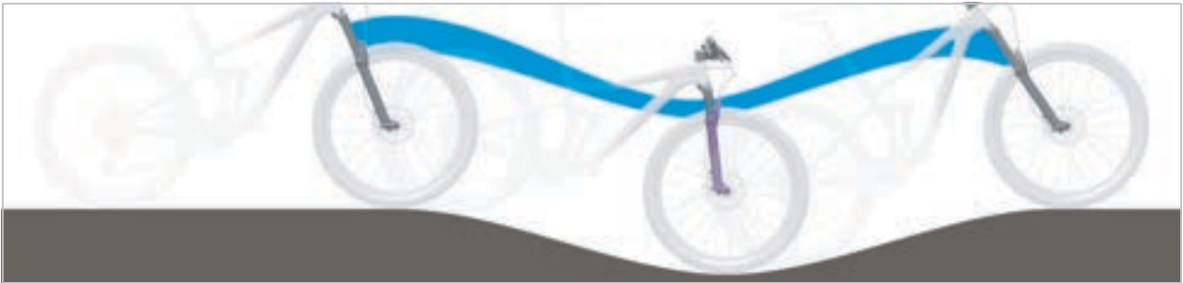
191. ábra: A teleszkópos villa túl puha rugózása hegymenetben
