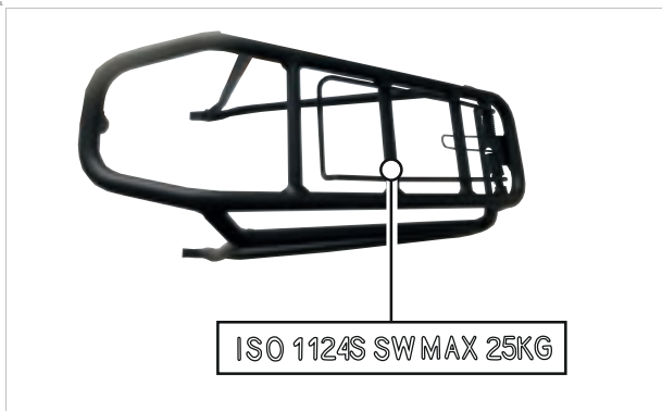
130. ábra: A csomagtartón fel van tüntetve a maximális teherbírása
