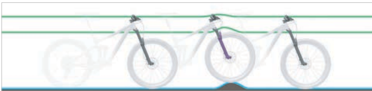
15. ábra: A villa optimális menetviselkedése egyenetlenségek esetén
