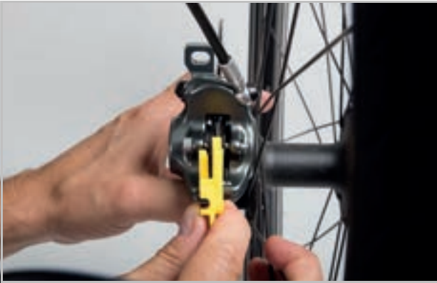
154. ábra: Fékbetét ellenőrzése beépített állapotban a szállítási rögzítés segítségével
