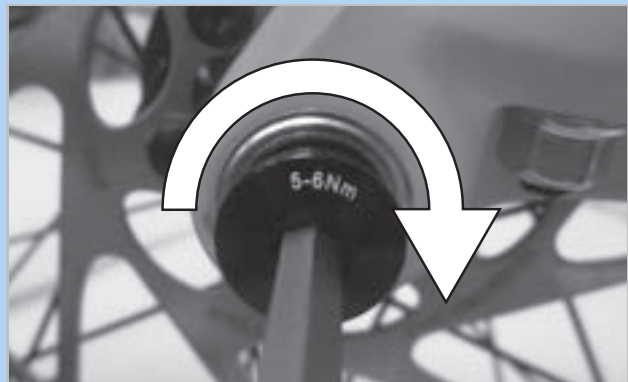
80. ábra: A rögzítőcsavar meghúzása
