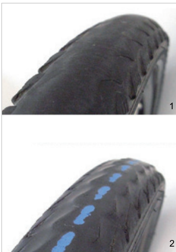
152. ábra: Profil nélküli gumiabroncs, amelyet cserélni lehet (1), és gumiabroncs áttetsző defektvédelemmel (2), amelyet cserélni kell
