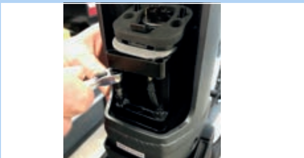
64. ábra: A 4 mm-es hatlapfejű csavarok eltávolítása
