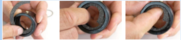
211. ábra: Filcgyűrű behelyezése
