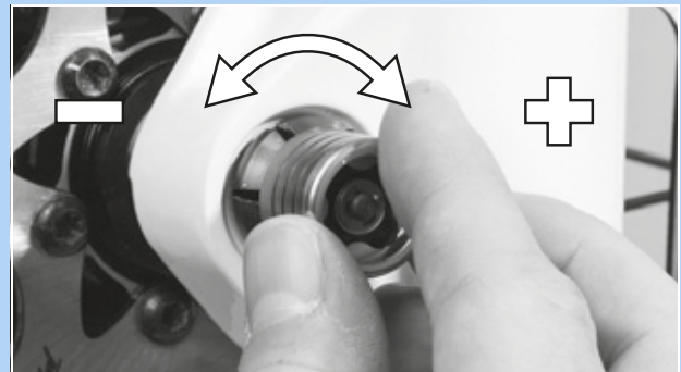
83. ábra: A feszítés beállítása
