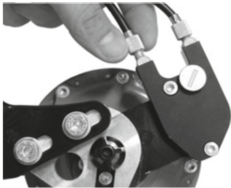
156. ábra: Külső váltóvezérléssel rendelkező Rohloff agyváltozatok húzásbeállítója a kötéldobozon van, ami a bal oldalon található
