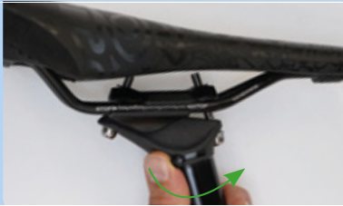
214. ábra: Magasságállítás nyitása
