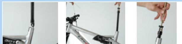
191. ábra: Tubus szelepfedél rögzítése
