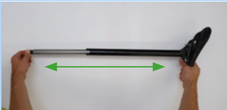
215. ábra: Nyeregcső széthúzása
