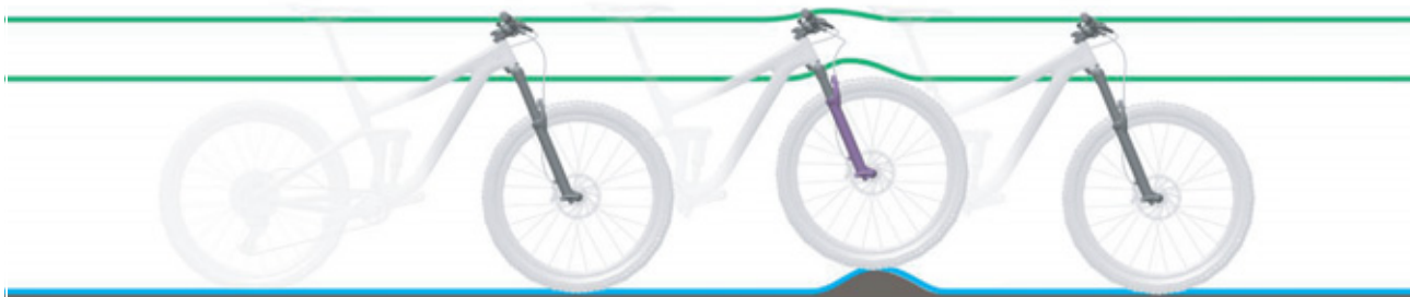
10. ábra: A villa optimális menetviselkedése egyenetlenségek esetén
