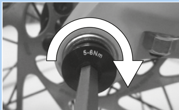
74. ábra: A rögzítőcsavar meghúzása
