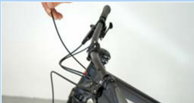
222. ábra: Végsapka beakasztása
