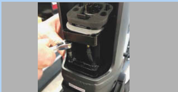
Illustration 71 : Retirer les vis à 6 pans de 4 mm
