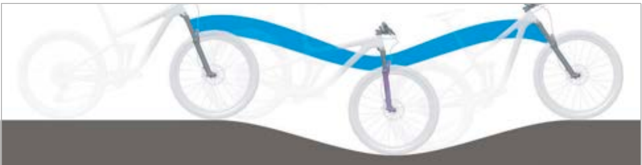
Illustration 13 : Comportement optimal de la fourche en terrain vallonné
