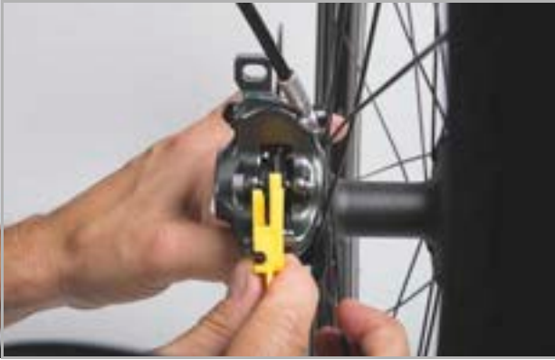
Illustration 179 : Contrôler la plaquette de frein montée à l'aide de la cale de transport
