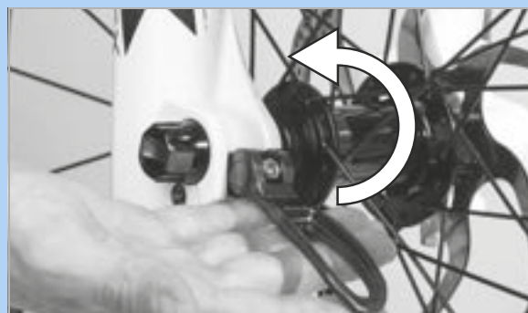
Illustration 93 : Enfoncez le levier d'attache rapide dans le sens de la flèche
