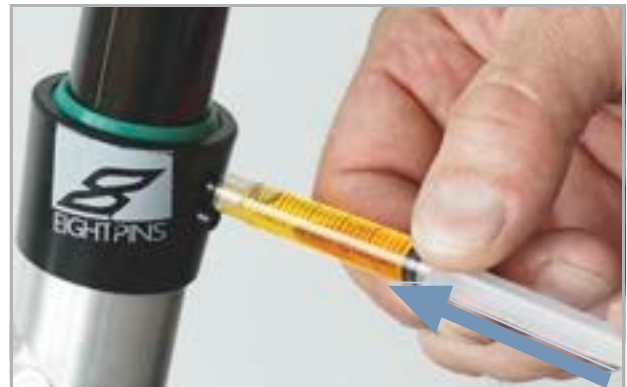
Illustration 175 : Lubrifier une tige de selle eightpins
