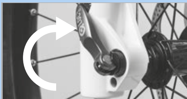
Illustration 99 : Fermer l'attache rapide
