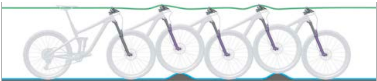
Illustration 15 : Comportement optimal de la fourche
