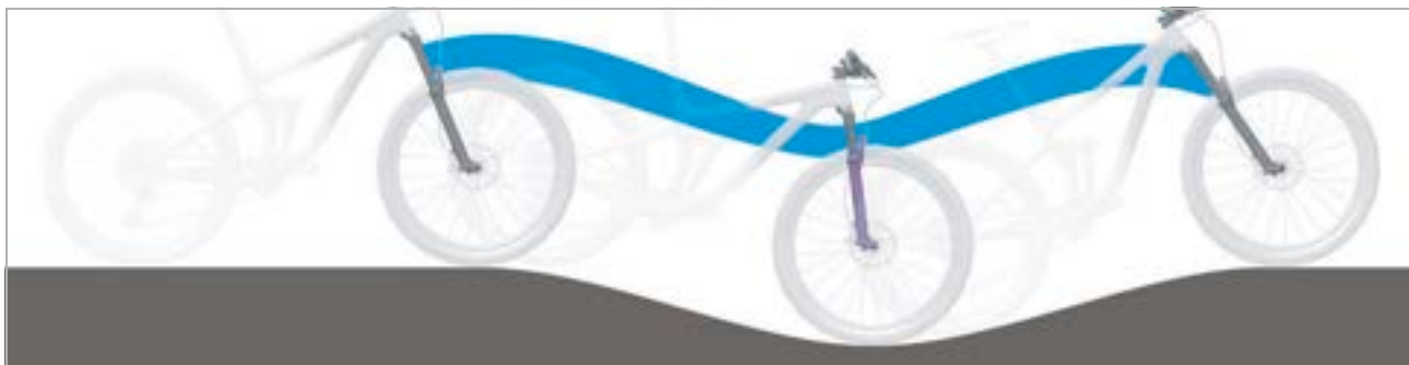
Illustration 140 : Comportement optimal de la fourche en terrain vallonné
