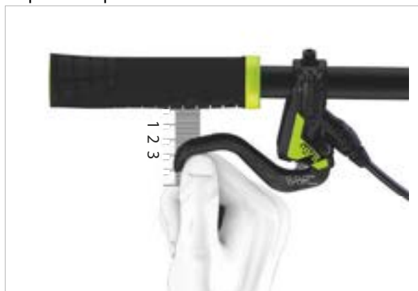
Illustration 132 : Positionnement du frein à main
