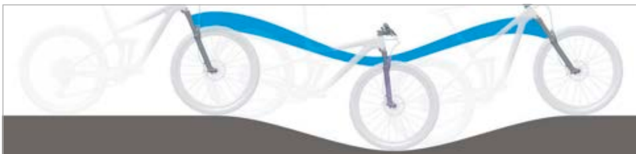
Illustration 195 : Suspension trop souple de la fourche suspendue dans les côtes
