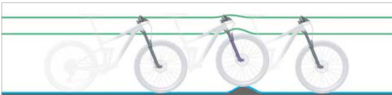
Illustration 141 : Comportement optimal de la fourche sur les irrégularités
