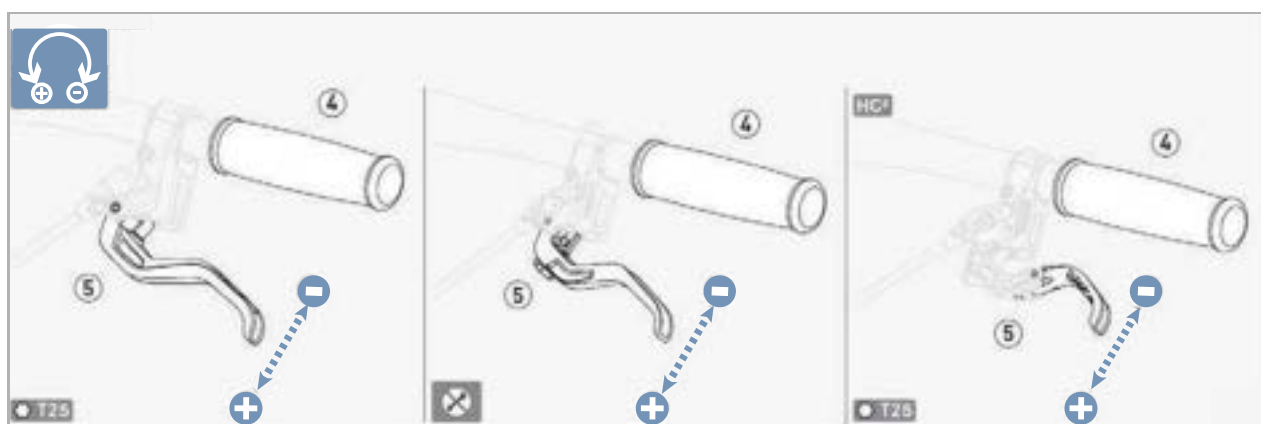
Illustration 133 : Régler la garde d'un levier de frein à disque MAGURA
