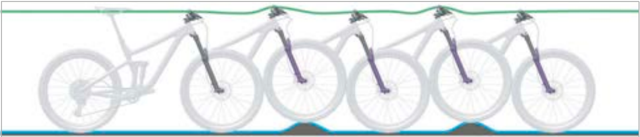
Illustration 12 : Comportement optimal de la fourche
