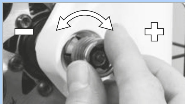
Illustration 98 : Régler la force de serrage
