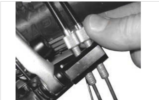
Illustration 183 : Sur les versions de moyeux ROHLOFF avec commande interne du changement de vitesse, le dispositif de réglage de la tension est situé sur le contre-support de tension.
