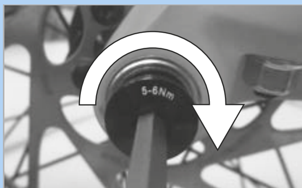
Illustration 89 : Serrer la vis de blocage
