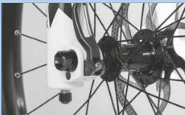
Illustration 94 : Position parfaite du levier de serrage
