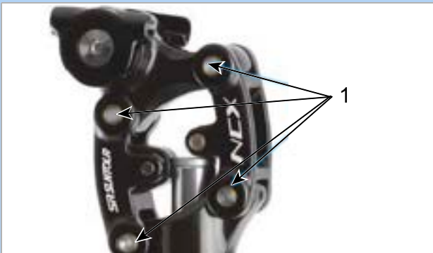
Illustration 189 : Points de lubrification de la tige de selle suspendue SR SUNTOUR
