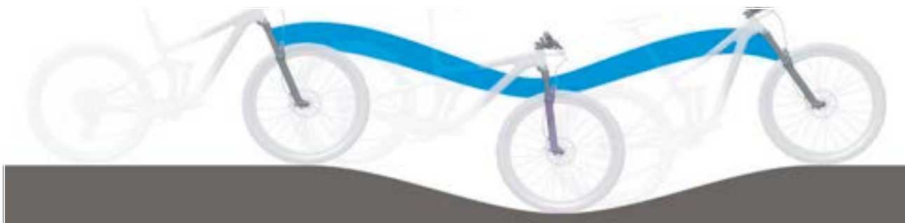
Illustration 162 : Comportement optimal en terrain vallonné
