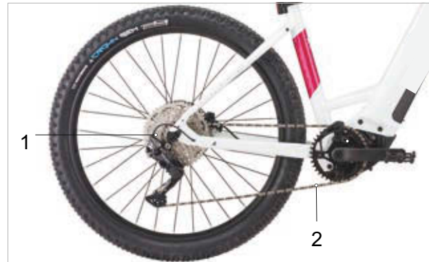
Illustration 42 : Schéma de l'entraînement à chaîne avec dérailleur
