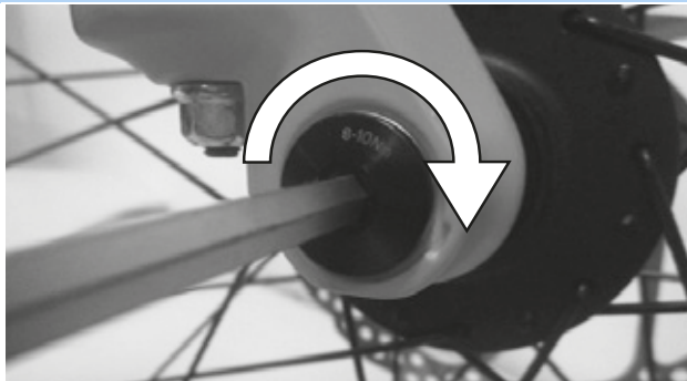
52. ábra: A tengely meghúzása nyílrányban
