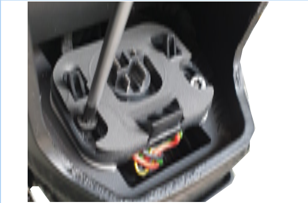
46. ábra: Akkumulátortartó csavarok oldása
