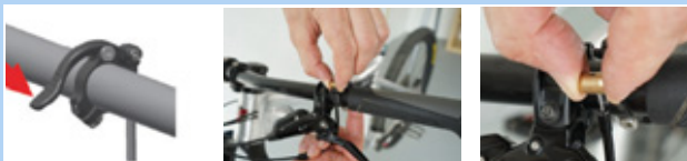
142. ábra: Tubus kiszérése
