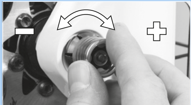
63. ábra: A feszítés beállítása
