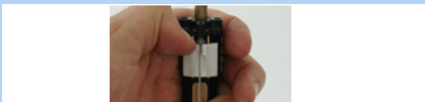
166. ábra: Fehér működtető kapcsoló lefelé tolása
