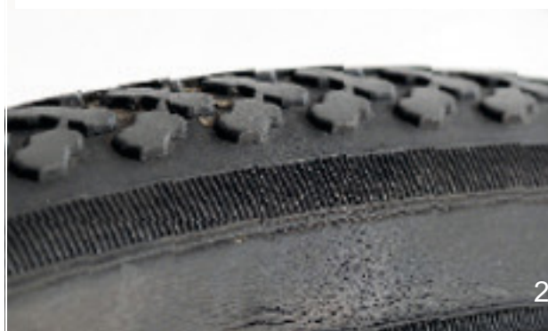
128. ábra: Példák kifáradási repedésekre (1) és öregedési repedésekre (2)
