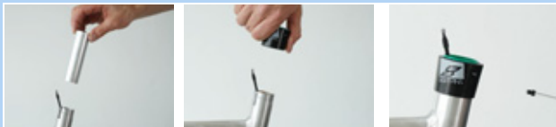
164. ábra: Siklópersely és külső hüvely beépítése
