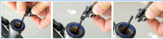
181. ábra: Bovden eltávolítása
