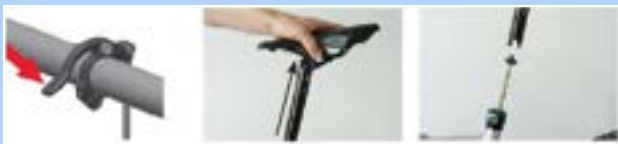
141. ábra: A nyeregcső kihúzása
