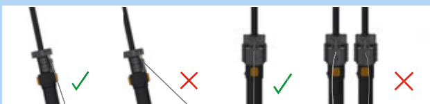
167. ábra: Helyesen és hibásan beállított bovdent
