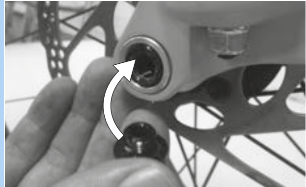
53. ábra: A gyorskioldó kar betolása a tengelybe
