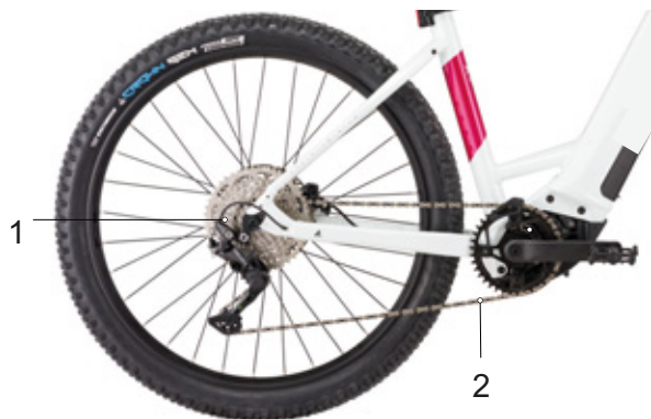
27. ábra: Külső váltóval felszerelt lánchajtás vázlata
