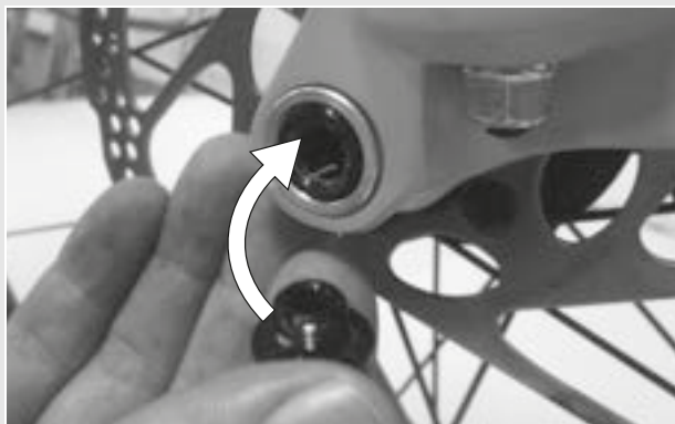
Illustration 37 : Enfoncer le levier d'attache rapide dans l'axe
