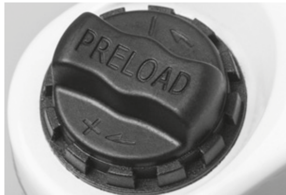
Illustration 64 : Molette de réglage de la course de suspension négative sur la couronne de la fourche de suspension
