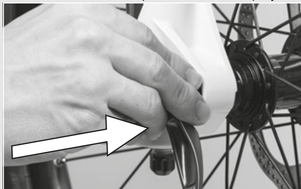
Illustration 48 : Enfoncez l'attache rapide
