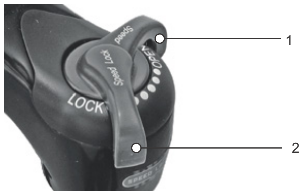
Illustration 81 : Dispositif de réglage de la compression Suntour avec les positions OPEN (1) et LOCK (2)
