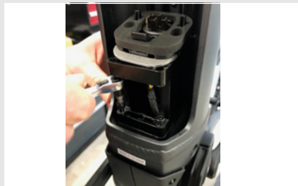
Illustration 23 : Retirer les vis à 6 pans de 4 mm
