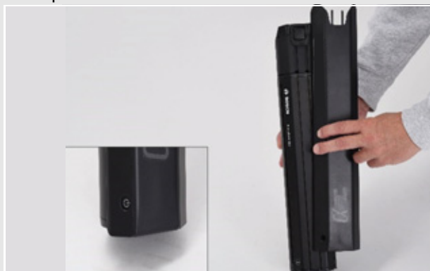
Illustration 34 : Enfoncer le capot de batterie sur la batterie
