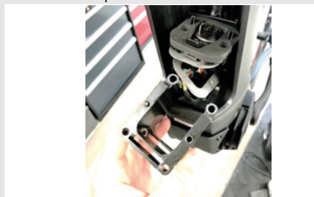
Illustration 25 : Retirer l'adaptateur PowerTube
