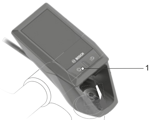
Illustration 74 : Position de la touche Marche/Arrêt (ordinateur de bord)
