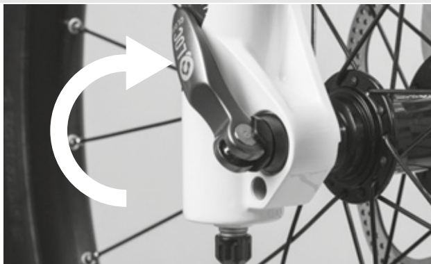
Illustration 50 : Fermer l'attache rapide
