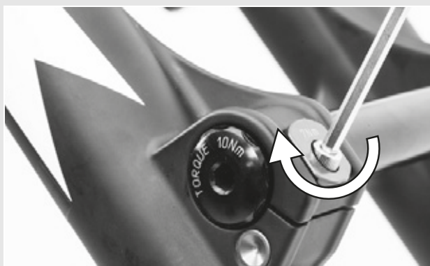
Illustration 40 : Serrer le collier de blocage
