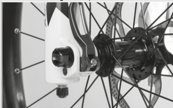
Illustration 45 : Position parfaite du levier de serrage
