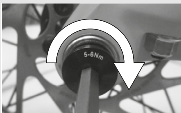
Illustration 31 : Serrer la vis de blocage
