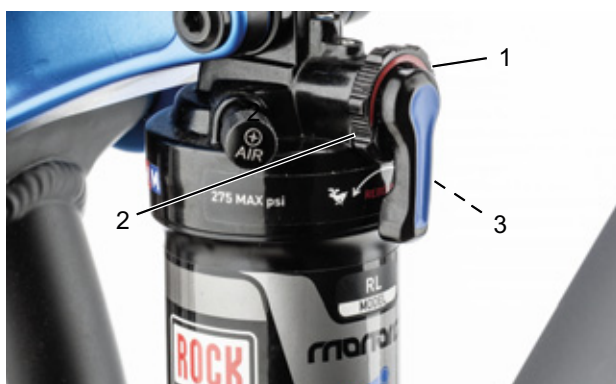
Illustration 82 : Régler la dureté de l'amortisseur de détente (1) de l'amortisseur arrière
