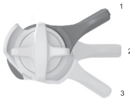
Illustration 77 : Dispositif de réglage de la compression FOX sur l'amortisseur arrière avec les positions OUVERT (1), MOYEN (2) et DUR (3)
