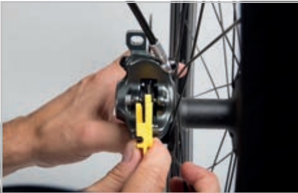
Abbildung 187: Bremsbelag im eingebauten Zustand mithilfe der Transportsicherung prüfen
