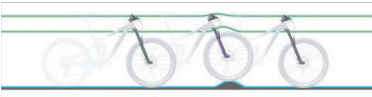
Abbildung 158: Hart und weich eingestellter Druckstufen-Dämpfer
