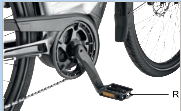
Abbildung 100: R-Pedal im rechten Kurbelarm
