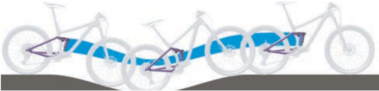
Abbildung 237: Zu weiche Federung des Hinterbau-Dämpfers am Berg
