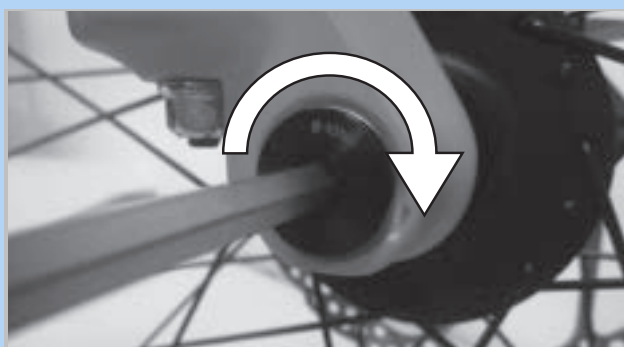
Abbildung 83: Achse in Pfeilrichtung anziehen
