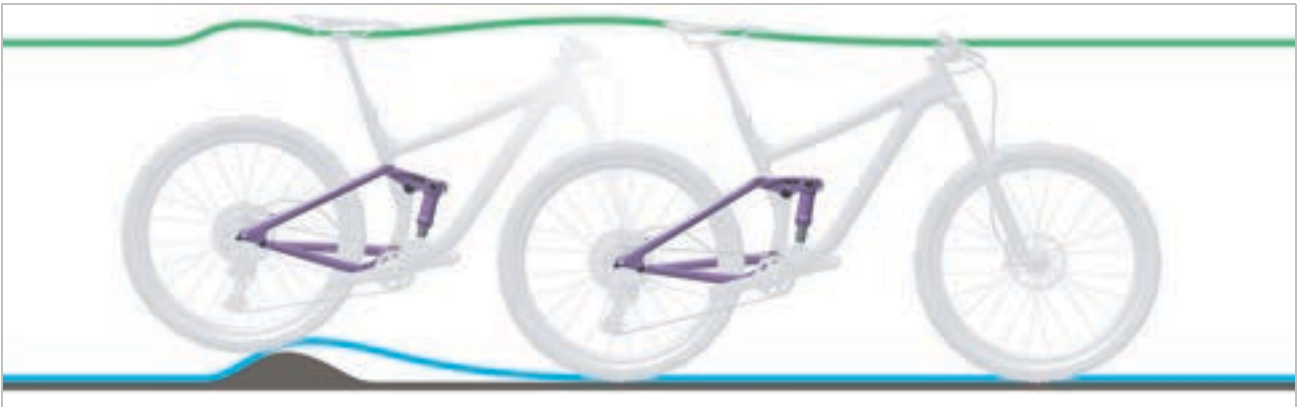
Abbildung 239: Zu harte Dämpfung des Hinterbau-Dämpfers bei Unebenheiten
