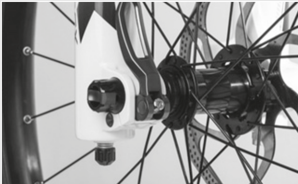
Afbeelding 36: Perfecte stand van de spanhendel
