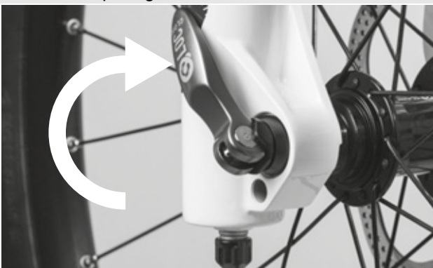
Paveikslėlis 37: Ekscentriko uždarymas
