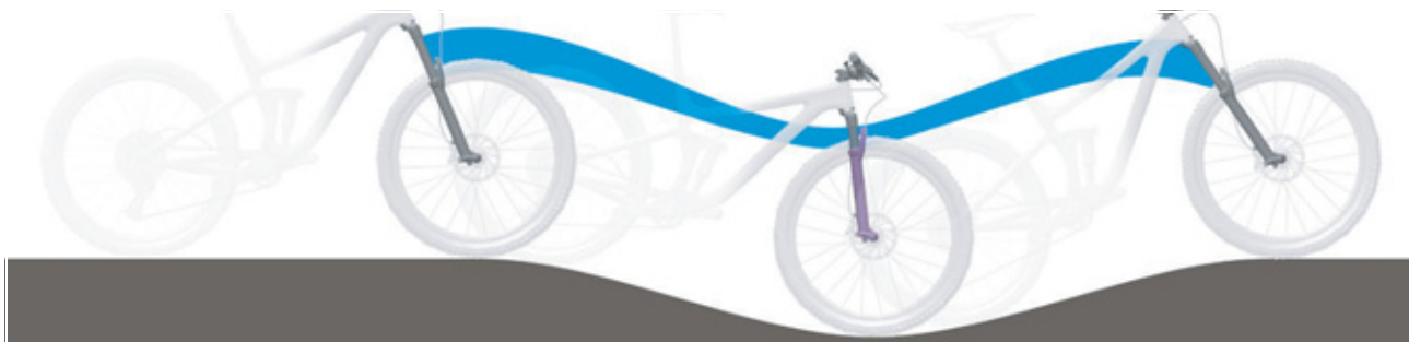
Paveikslėlis 93: Ant kalno šakių amortizavimas per minkštas
