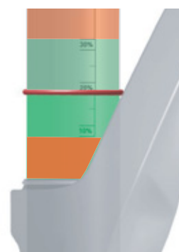
Paveikslėlis 58: Normatyvinis SAG diapazonas (žalias) ir draudžiamas AG diapazonas
