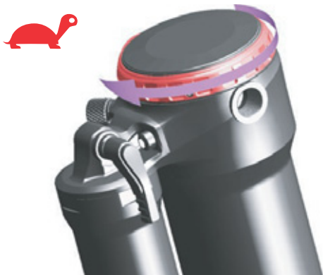
Paveikslėlis 98: Atšokimo pakopos reguliatoriaus pasukimas link vėžlio
