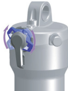
Paveikslėlis 71: Kompresijos reguliatorių nustatykite kietesnėje padėtyje
