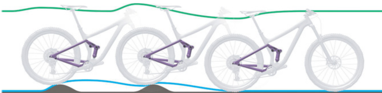
Paveikslėlis 99: Per lėtas galinio amortizatoriaus atšokimas
