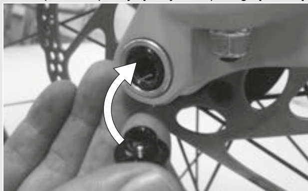
Paveikslėlis 24: Ekscentriko įstūmimas į ašį
