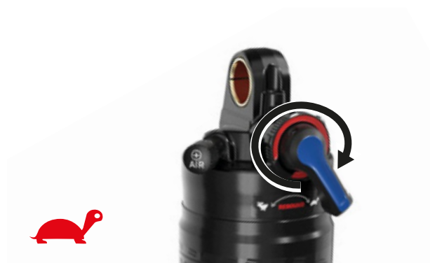
Paveikslėlis 66: Atšokimo greičio sumažinimas
