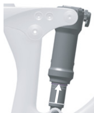
Paveikslėlis 60: Žiedinės tarpinės pastūmimas ant galinio amortizatoriaus
