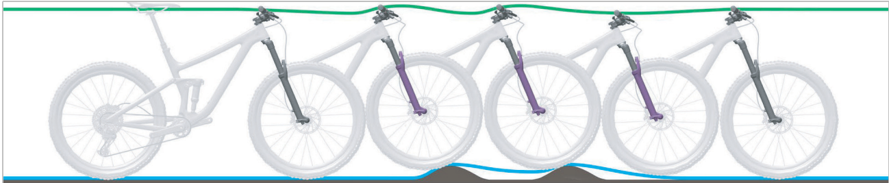
Abbildung 280: Zu langsames Ausfedern der Federgabel
