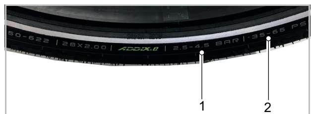
Abbildung 240: Angabe Fülldruck in bar (1) und psi (2)
