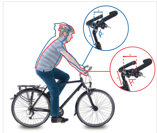
Abbildung 156: Citybike (blau) und Trekkingrad Position (rot) durch Winkeländerung
