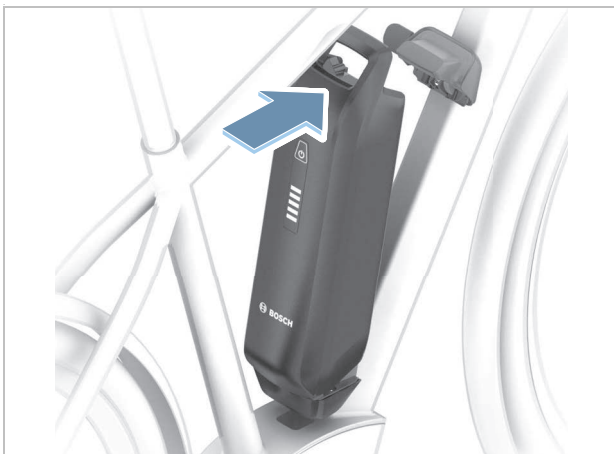
Abbildung 206: PowerPack Akku nach oben klappen
