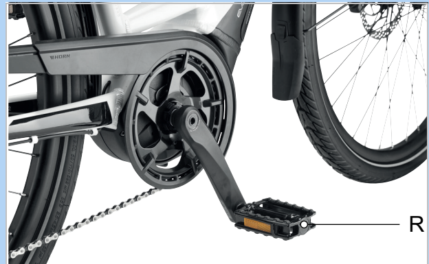
Abbildung 134: R-Pedal im rechten Kurbelarm
