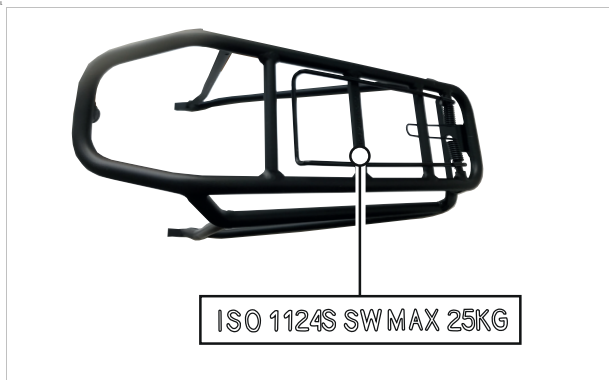
Abbildung 198: Auf dem Gepäckträger ist seine maximale Tragfähigkeit ausgewiesen
