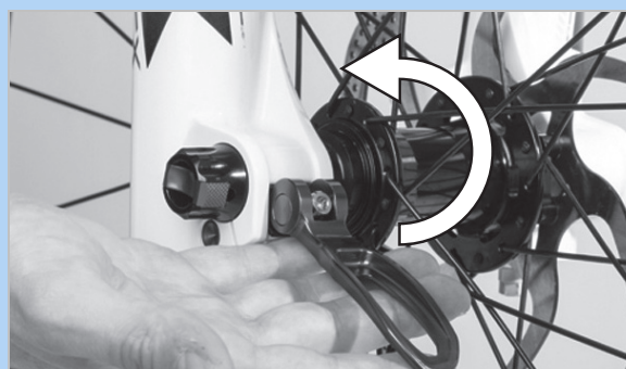
Abbildung 125: Schnellspannhebel in Pfeilrichtung drücken
