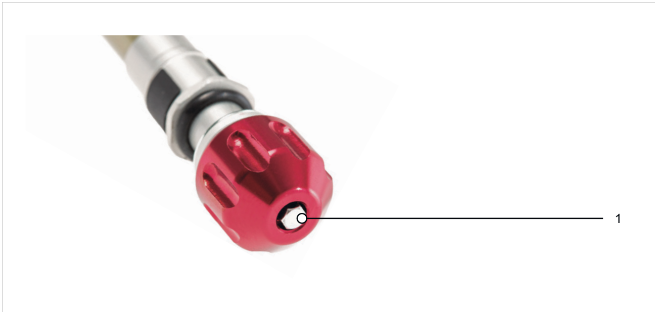
Abbildung 174: Beispiel SR SUNTOUR Zugstufen-Einsteller (Federgabel) (1)
