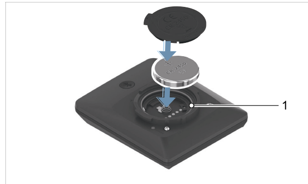
Abbildung 183: Batterie einlegen mit korrekt ausgerichtetem Dichtgummi (1)
