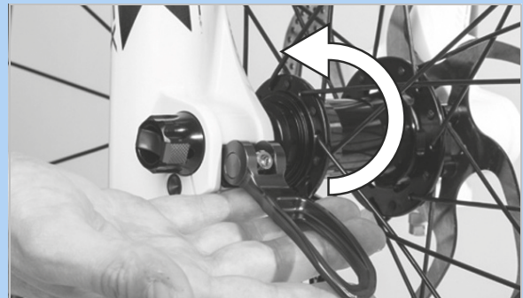
123. ábra: A gyorszár nyomása nyírányban
