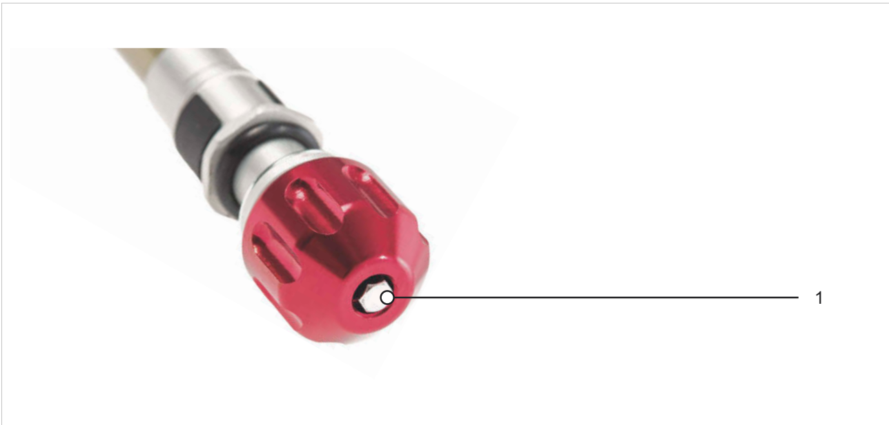
172. ábra: Példa: SR SUNTOUR húzófokozat-beállító (teleszkópos villa) (1)
