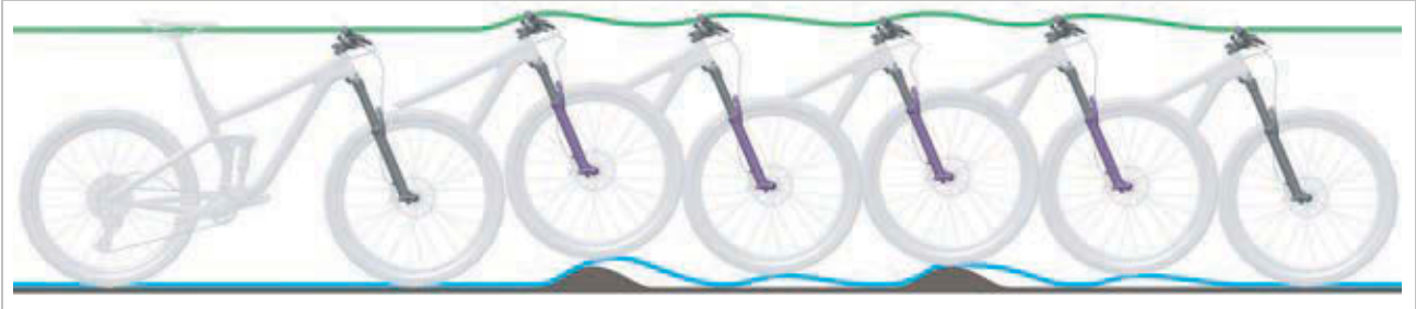
276. ábra: A teleszkópos villa túl gyors kirugózása
