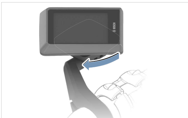
183. ábra: A kijelző elforgatása az óramutató járásával egyező irányban
