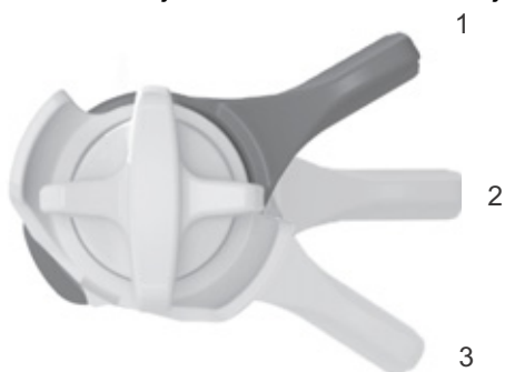
Obr. 76: Nastavovací šroub komprese FOX na tlumiči zadního odpružení s polohami OTEVŘENÁ (1), STŘEDNÍ (2) a TVRDÁ (3)
