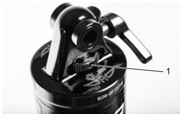
Obr. 62: Nastavovací šroub odskoku Suntour (1) na tlumiči zadního odpružení
