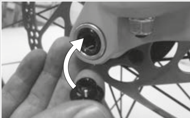
Obr. 28: Zasuňte páku rychloupínáku do osy
