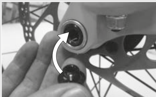
Illustration 27 : Enfoncer le levier d'attache rapide dans l'axe
