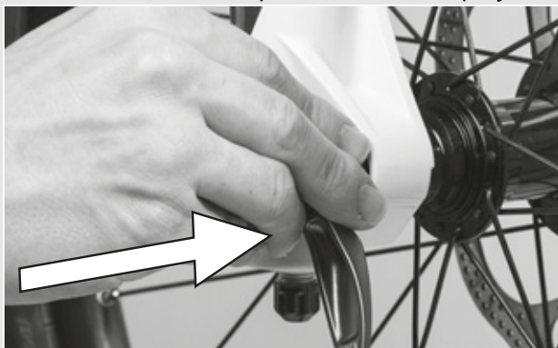
Illustration 38 : Enfoncez l'attache rapide
