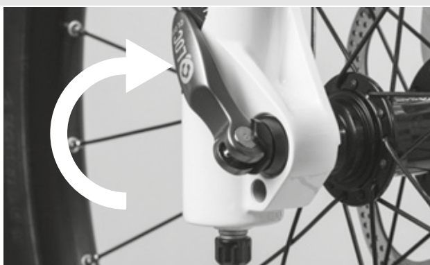
Illustration 40 : Fermer l'attache rapide
