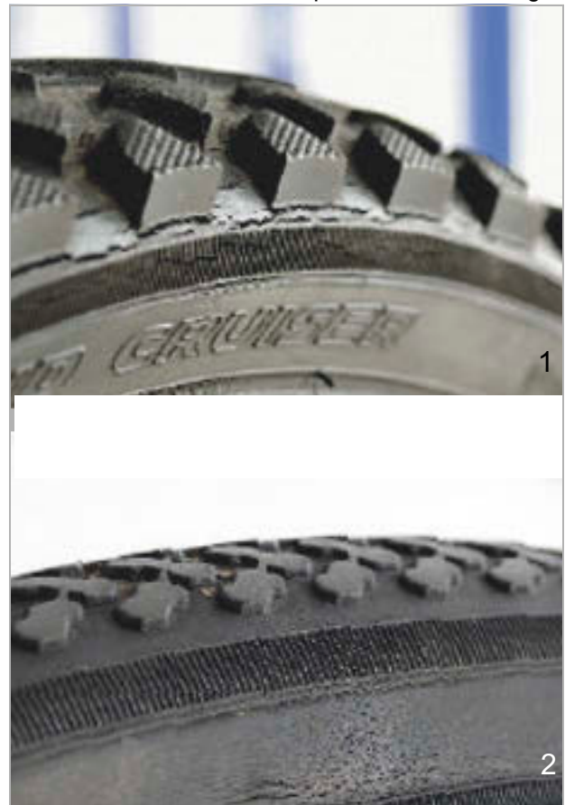
Illustration 195 : Exemples de fissures de fatigue (1) et de fissures d'âge (2)
