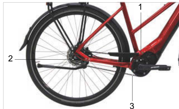
Illustration 55 : Schéma de l'entraînement à courroie
