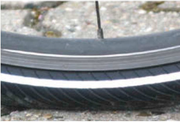
Illustration 127 : Pression correcte. Le pneu se déforme à peine sous le poids du corps.
