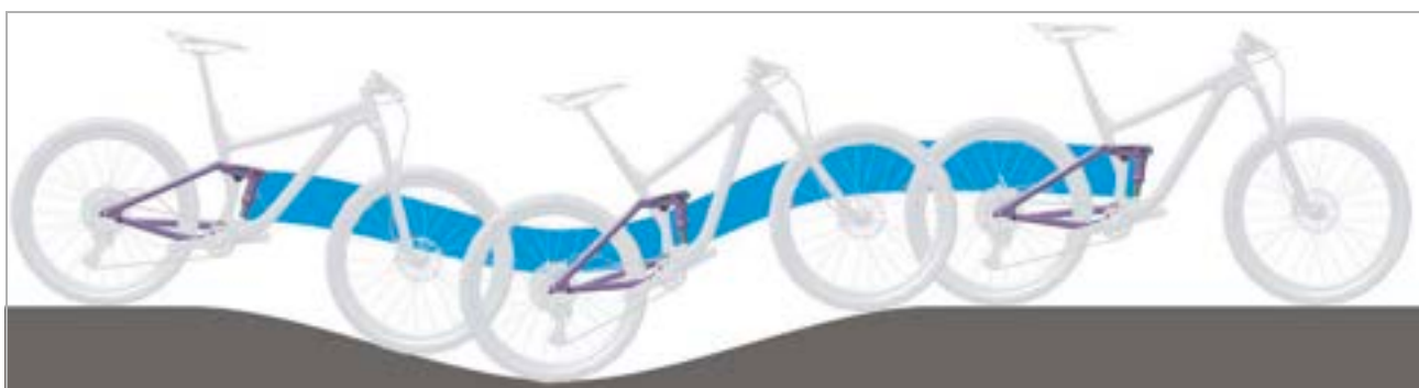
Illustration 9 : Comportement optimal de l'amortisseur arrière en terrain vallonné
