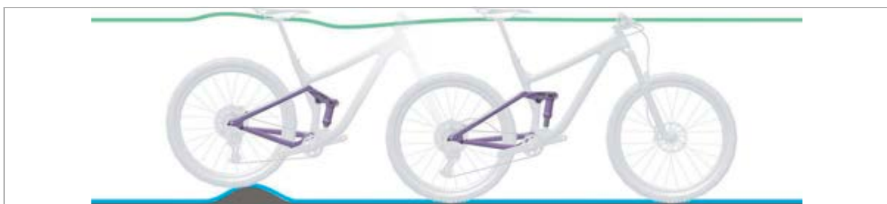
Illustration 141 : Comportement optimal de l'amortisseur arrière sur des irrégularités
