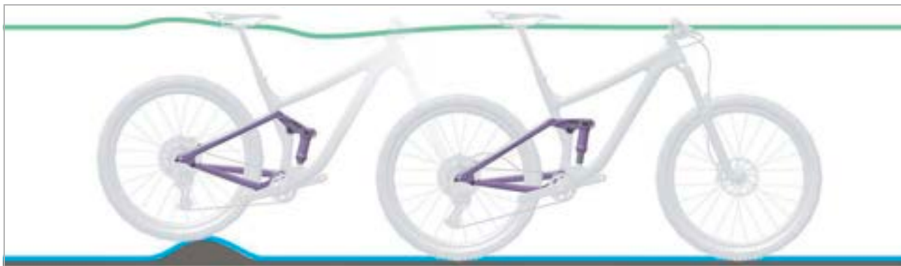
Illustration 168 : Comportement optimal de l'amortisseur arrière sur des irrégularités
