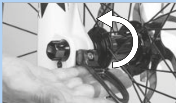
Illustration 91 : Enfoncez le levier d'attache rapide dans le sens de la flèche
