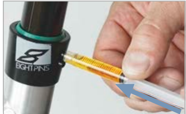
Illustration 192 : Lubrifier une tige de selle eightpins
