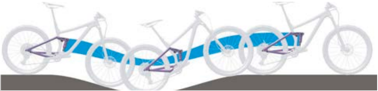
Illustration 238 : Suspension trop souple de l'amortisseur arrière dans les côtes
