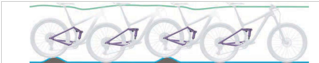
Illustration 139 : Comportement optimal de l'amortisseur arrière
