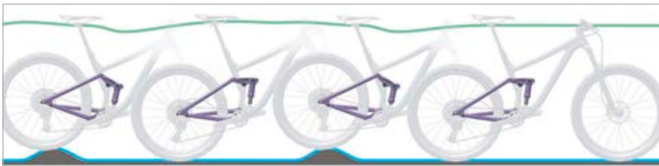
Illustration 8 : Comportement optimal de l'amortisseur arrière
