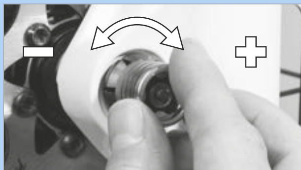
Illustration 96 : Régler la force de serrage
