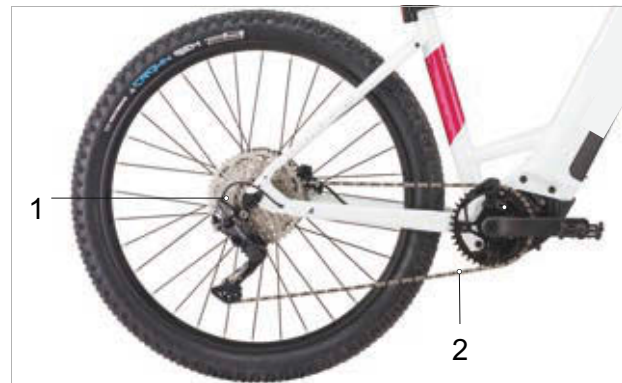
Illustration 54 : Schéma de l'entraînement à chaîne avec dérailleur
