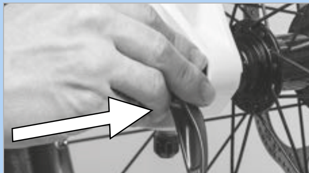
Illustration 95 : Enfoncez l'attache rapide dans le sens de la flèche
