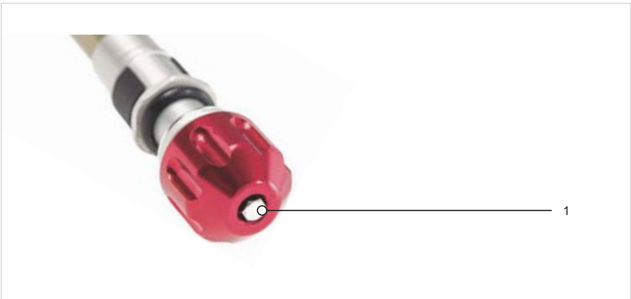
Illustration 231 : Exemple d'une vis de détente SR SUNTOUR (1)
