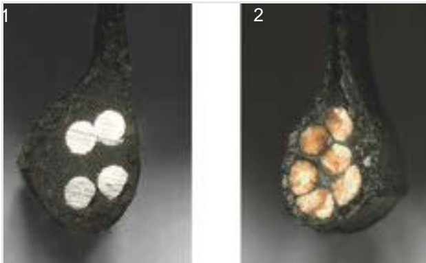
Illustration 33 : tringle en acier (1) et tringle en Kevlar (2)
