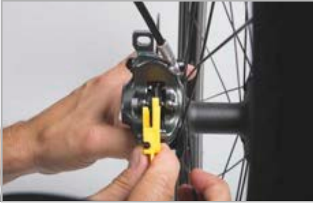
Illustration 196 : Contrôler la plaquette de frein montée à l'aide de la cale de transport
