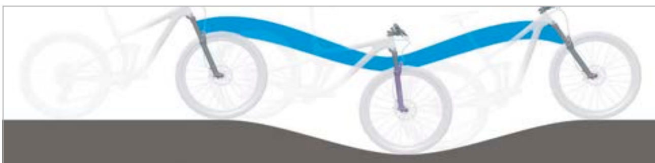
Illustration 166 : Comportement optimal en terrain vallonné
