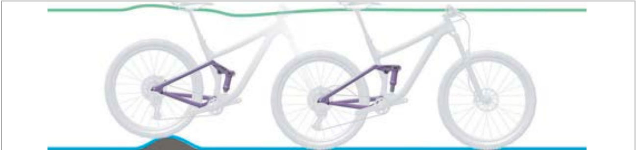
Illustration 7 : Comportement optimal de l'amortisseur arrière sur des irrégularités
