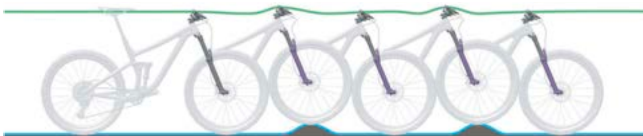
Illustration 143 : Comportement optimal de la fourche
