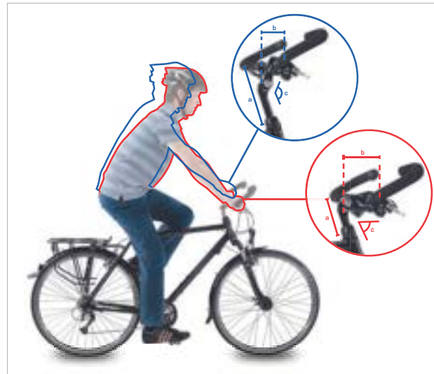
Illustration 125 : Position sur vélo de ville (en bleu) et sur vélo tout chemin (en rouge) avec modification de l'angle
