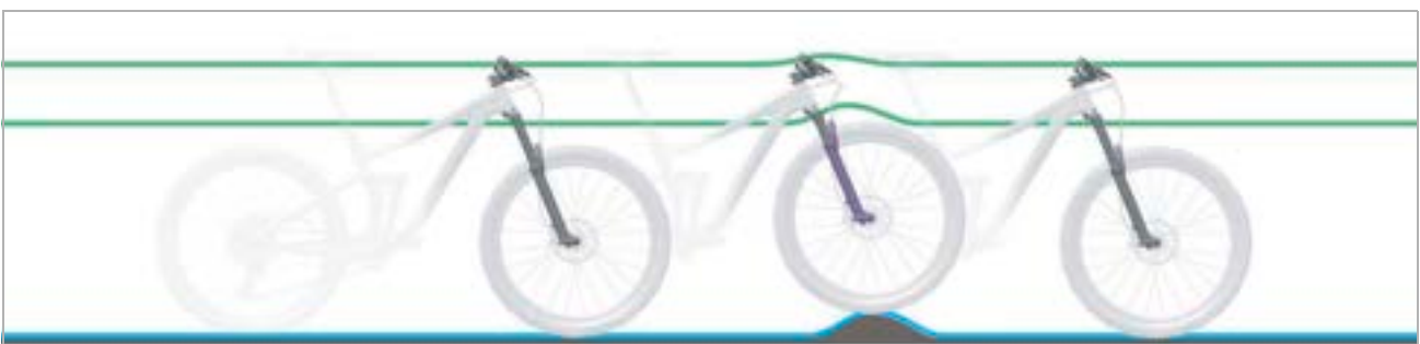
Illustration 20 : Comportement optimal de la fourche sur les irrégularités
