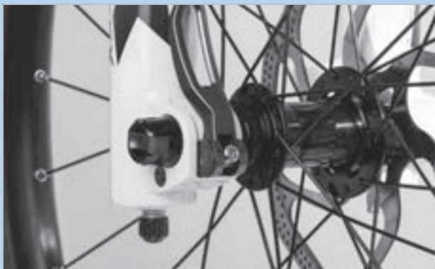
Illustration 61 : Position parfaite du levier de serrage
