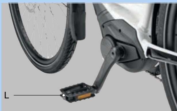
Illustration 70 : Pédale L dans le bras de manivelle gauche
