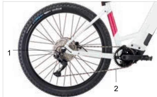
Illustration 39 : Schéma de l'entraînement à chaîne avec dérailleur
