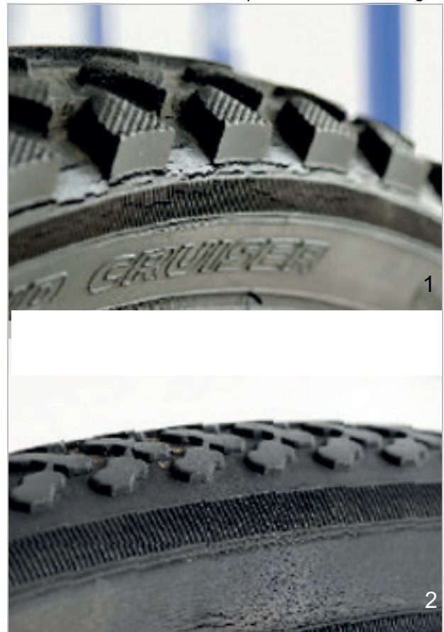
Illustration 139 : Exemples de fissures de fatigue (1) et de fissures d'âge (2)
