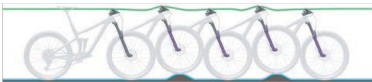
Illustration 104 : Comportement optimal de la fourche
