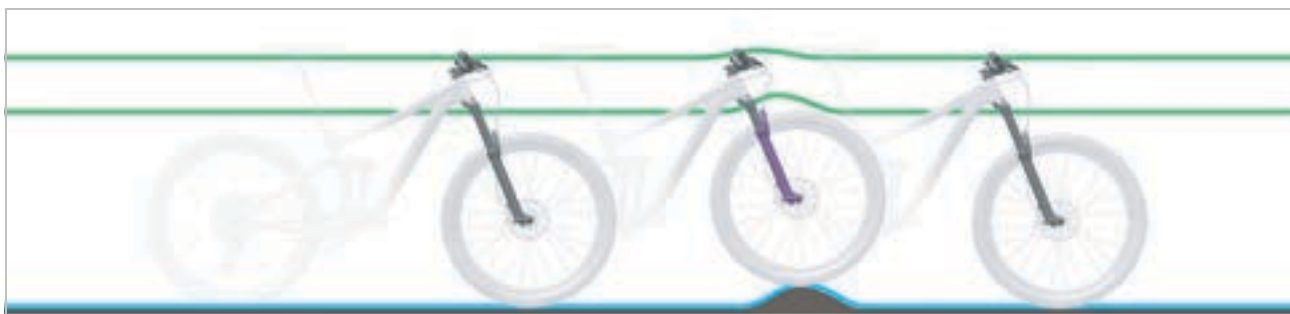
Illustration 106 : Comportement optimal de la fourche sur les irrégularités
