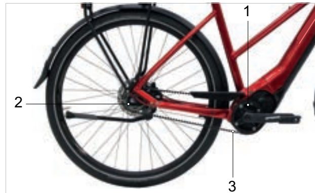
Illustration 40 : Schéma de l'entraînement à courroie
