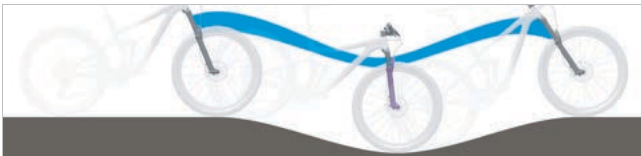
Illustration 176 : Suspension trop souple de la fourche suspendue dans les côtes
