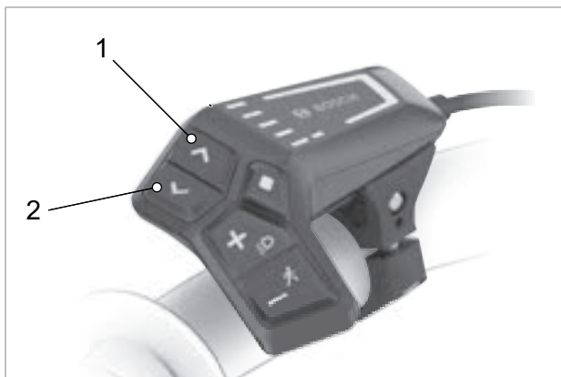
Illustration 125 : Position de la touche d'augmentation de la luminosité (2) et de la touche de réduction de la luminosité (1)
