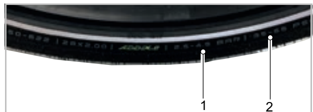
Illustration 137 : Indication de pression des pneus en bar (1) et psi (2)
