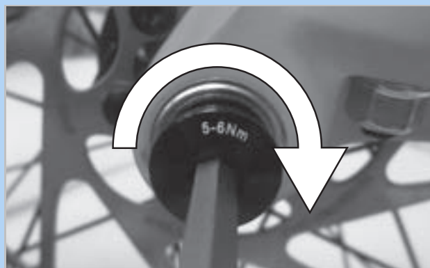
Illustration 56 : Serrer la vis de blocage
