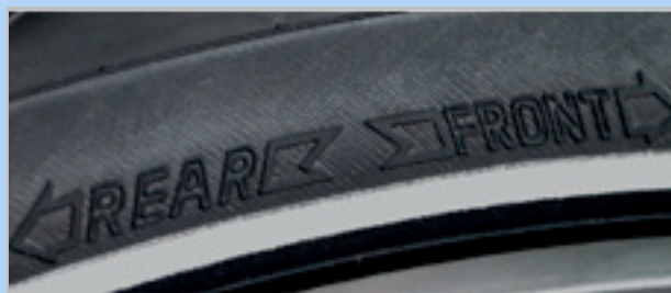
Illustration 68 : Flèche directionnelle sur les pneus VTT
