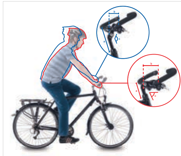
Illustration 94 : Position sur vélo de ville (en bleu) et sur vélo tout chemin (en rouge) avec modification de l'angle
