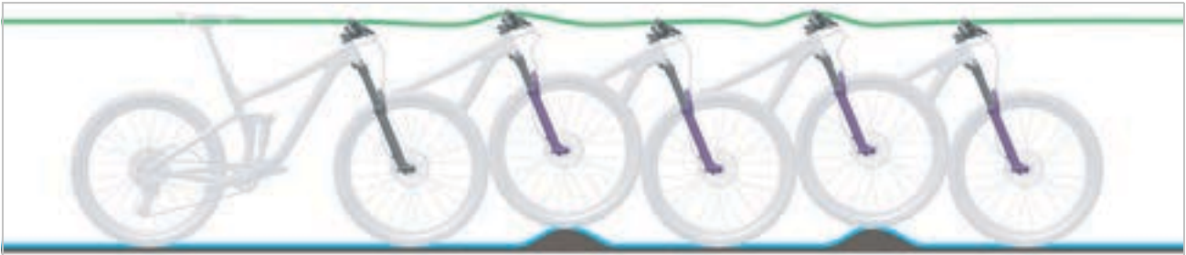
Illustration 12 : Comportement optimal de la fourche
