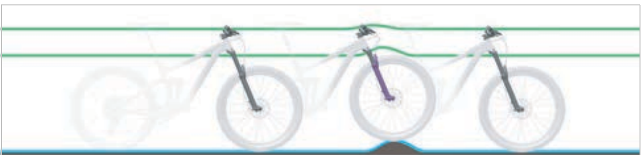
Illustration 14 : Comportement optimal de la fourche sur les irrégularités
