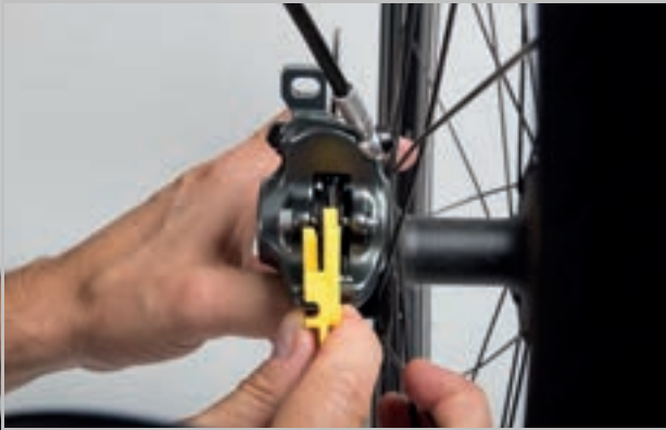
Illustration 140 : Contrôler la plaquette de frein montée à l'aide de la cale de transport
