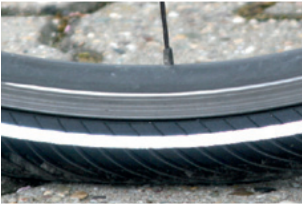
Illustration 96 : Pression correcte. Le pneu se déforme à peine sous le poids du corps.
