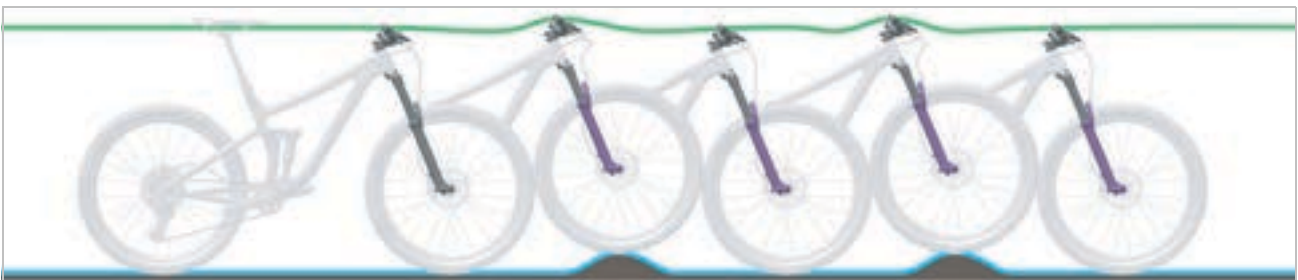
Illustration 15 : Comportement optimal de la fourche
