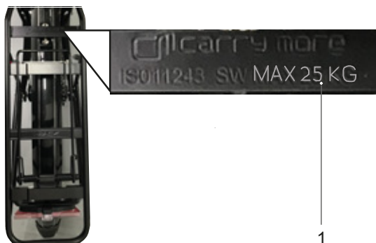
Illustration 99 : La capacité de charge maximale (1) est indiquée sur le porte-bagages.
