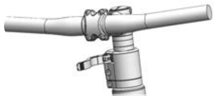
Illustration 96 : Exemple d'un All Up avec levier de serrage de la potence ouvert
