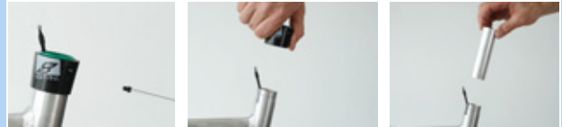
Illustration 176 : Démonter l'enveloppe extérieure et la douille de glissement
