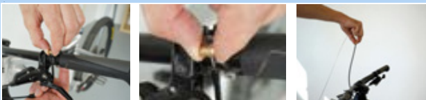
Illustration 173 : Détacher la télécommande
