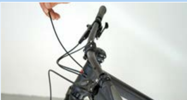
Illustration 193 : Accrocher le capuchon d'extrémité
