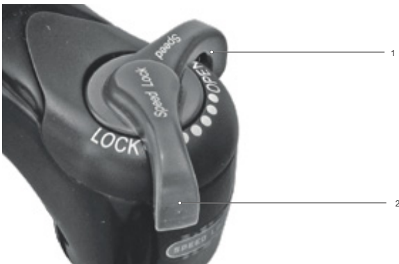
Illustration 201 : Régler le dispositif de réglage de la compression sur un niveau plus dur
