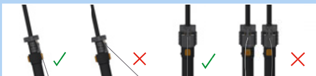
Illustration 161 : Câble Bowden correct et incorrect
