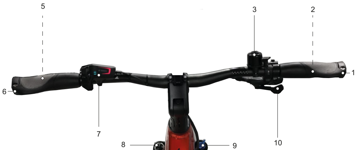
Illustration 33 : Vue détaillée d'un guidon avec BOSCH Kiox300, exemple
