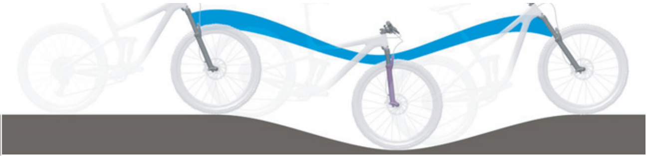
Illustration 200 : Suspension trop souple de la fourche suspendue dans les côtes
