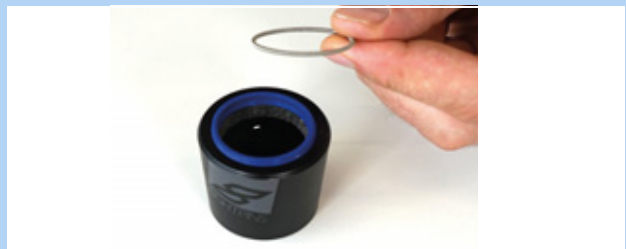
Illustration 178 : Rondelle élastique retirée
