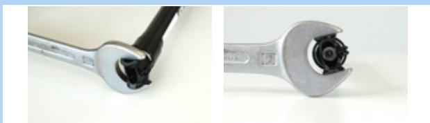
Illustration 155 : Empêcher l'interface de montage de tourner
