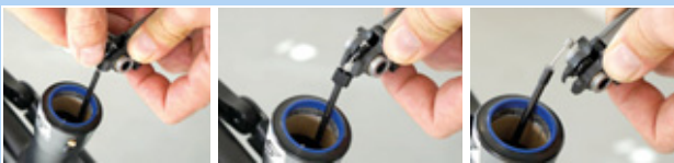
Illustration 175 : Retirer le câble Bowden
