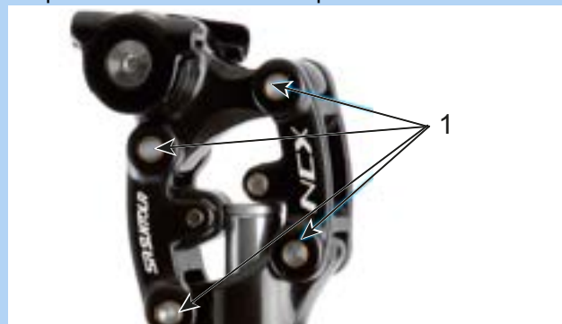
Illustration 133 : Points de lubrification de la tige de selle suspendue SR Suntour
