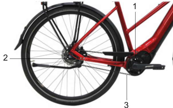
Illustration 27 : Schéma de l'entraînement à courroie
