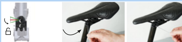
Illustration 134 : Placer le mécanisme de réglage de la hauteur en « position ouverte »
