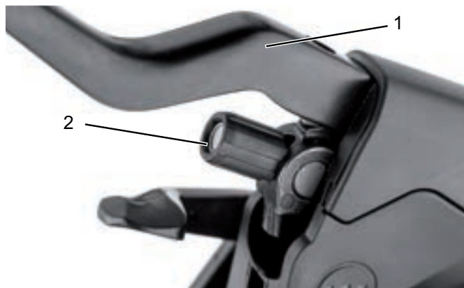
Abbildung 65: Bremshebel (1) der hydraulisch betätigten Felgenbremse mit Einstellschraube (2)
