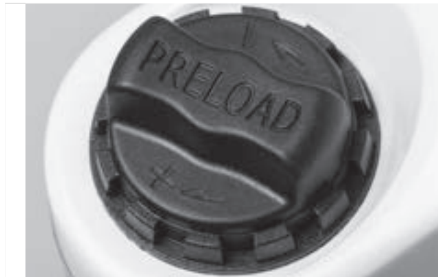
Abbildung 44: Einstellrad des Negativen Federwegs auf der Krone der Federgabel
