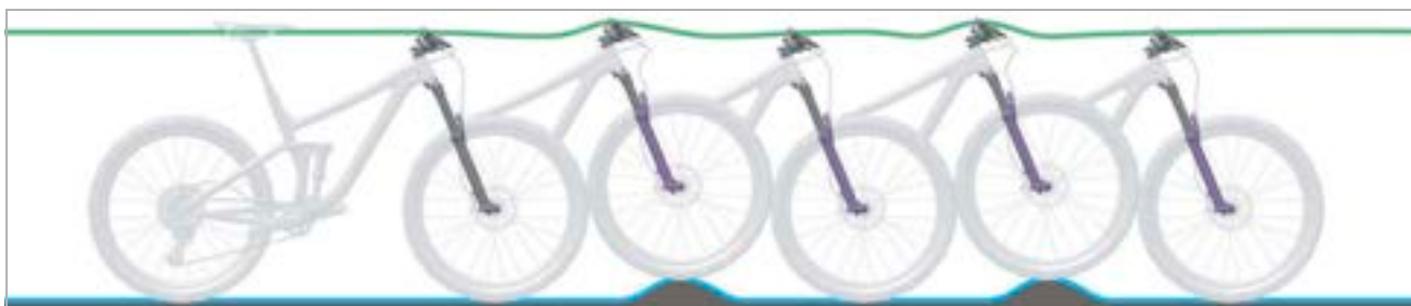
15. ábra: A villa optimális menetviselkedése
