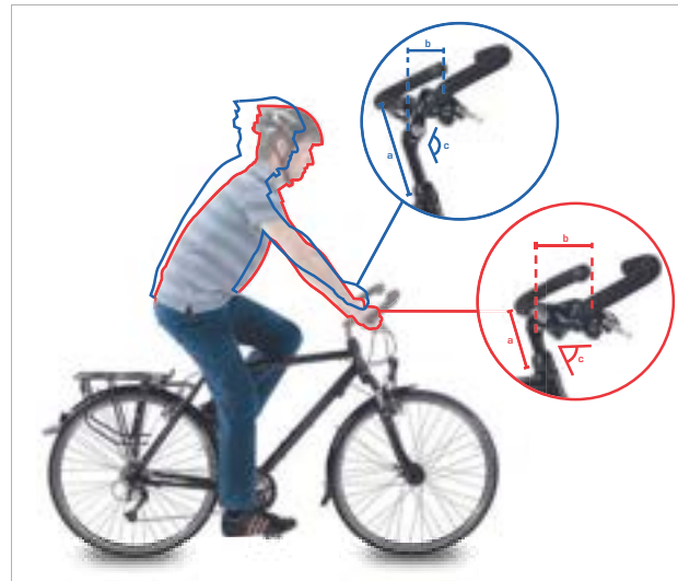
124. ábra: Városi kerékpár (kék) és túrakerékpár (piros) a szög változtatásával
