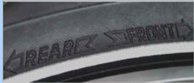
98. ábra: Futásirányjelző nyíl MTB gumiabroncsokon
