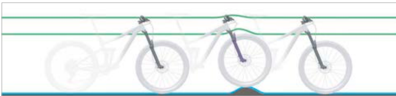
14. ábra: A villa optimális menetviselkedése egyenetlenségek esetén
