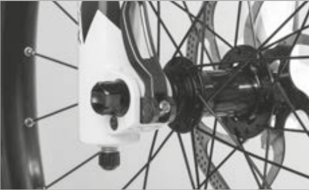
215. ábra: A gyorszár szorítóerejének beállítása
