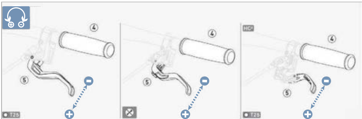
132. ábra: MAGURA kézfék markolatszélesség, a tárcsafék beállítása
