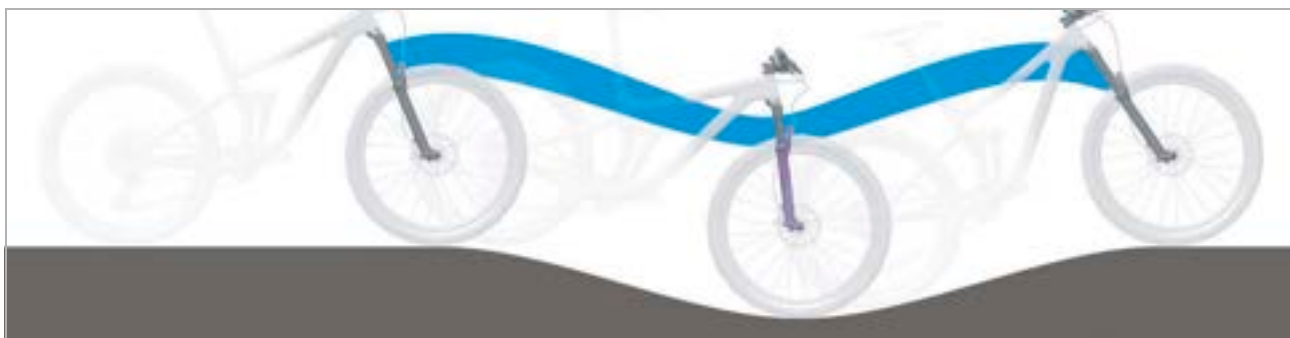
13. ábra: A villa optimális menetviselkedése dombos terepen
