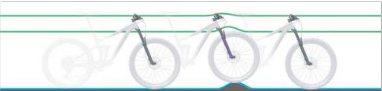
138. ábra: A villa optimális menetviselkedése egyenetlenségek esetén
