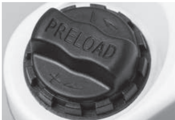
Abbildung 44: Einstellrad des Negativfederwegs auf der Krone der Federgabel
