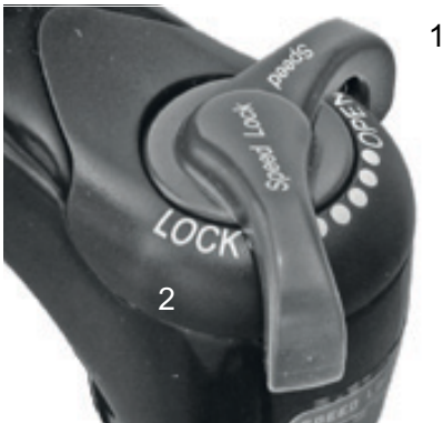
Abbildung 53: Suntour-Druckstufen-Einsteller mit den Positionen OPEN (1) und LOCK (2)
