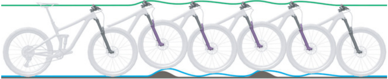
Figura 204: Corsa di estensione troppo veloce della forcella ammortizzata
