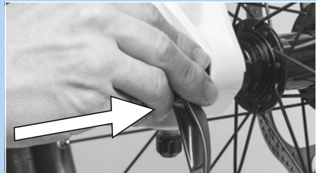
54. ábra: A gyorsár betolása nyilirányban
