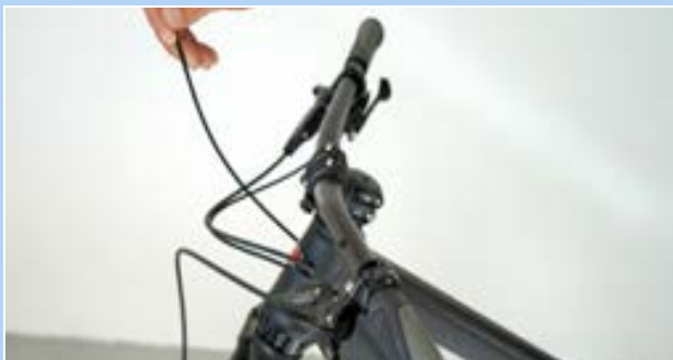
191. ábra: Végsapka beakasztása
