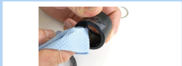
144. ábra: Külső hüvely tisztítása
