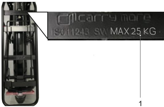
99. ábra: A csomagtartón fel van tüntetve maximális teherbírása (1)
