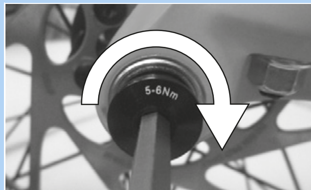
46. ábra: A rögzítőcsavar meghúzása
