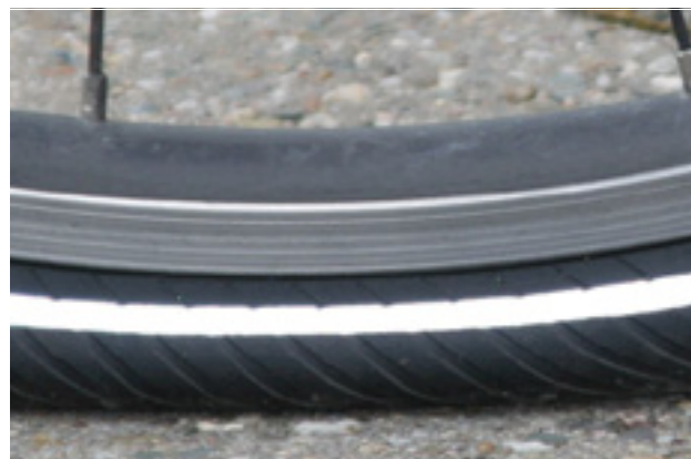
79. ábra: Túlontúl alacsony töltőnyomás
