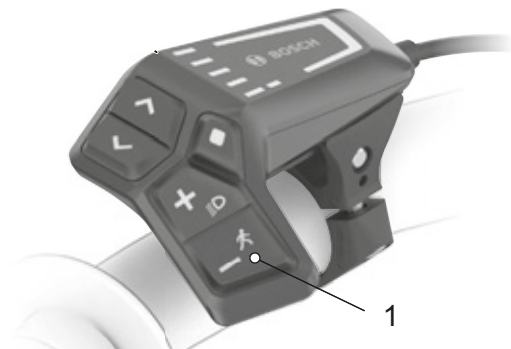
107. ábra: A tolási rásegítés gomb elhelyezkedése (1)
