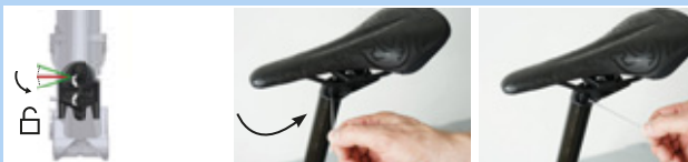
132. ábra: A magasságállító működtető beállítása „nyitott” állásba
