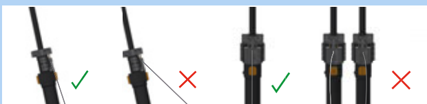
159. ábra: Helyesen és hibásan beállított bovdent
