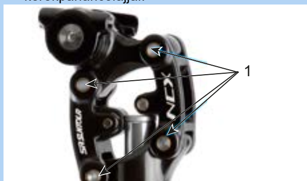
131. ábra: SR kenőpontok Suntour rugós nyeregcső
