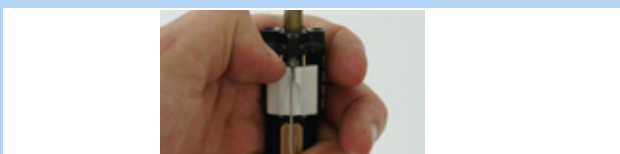
158. ábra: Fehér működtető kapcsoló lefelé tolása
