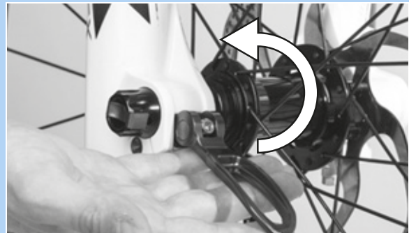
50. ábra: A gyorsár nyomása nyílrányban
