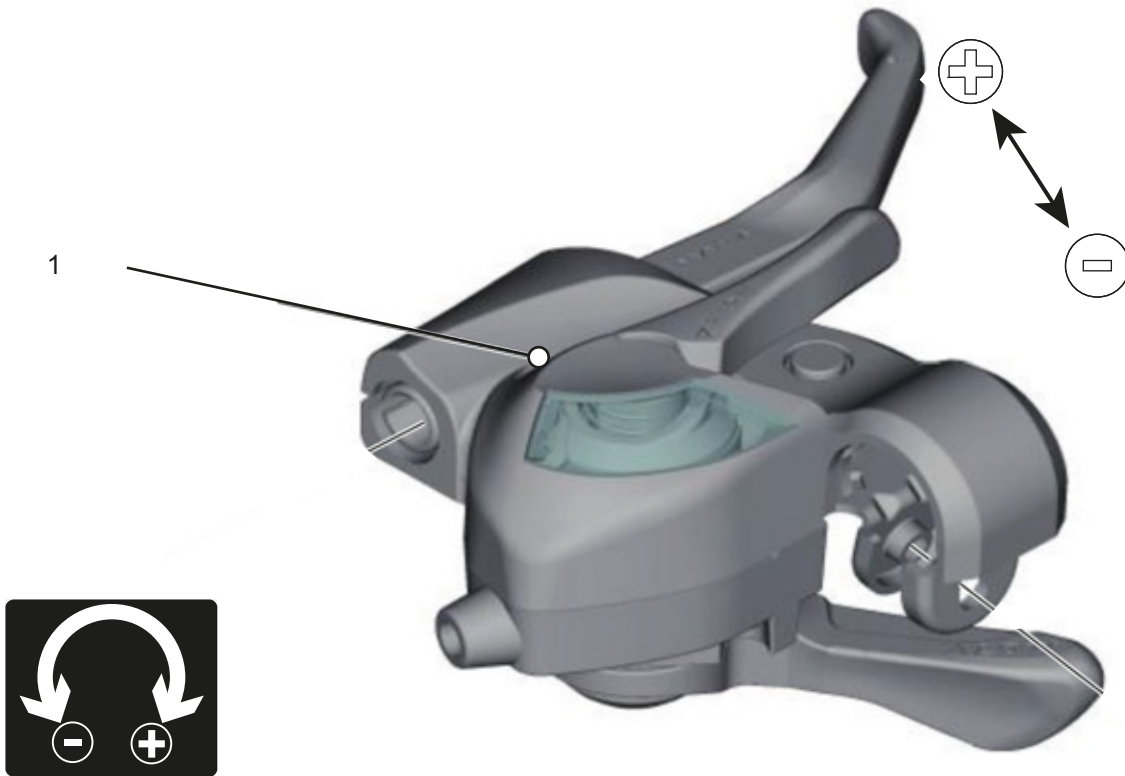
86. ábra: Állítócsavar (1) helyzete
