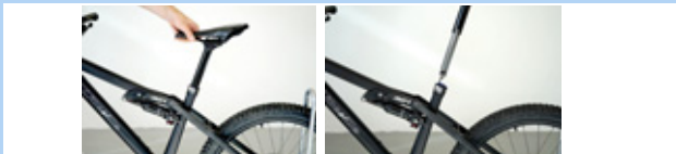
172. ábra: A nyeregcső eltávolítása
