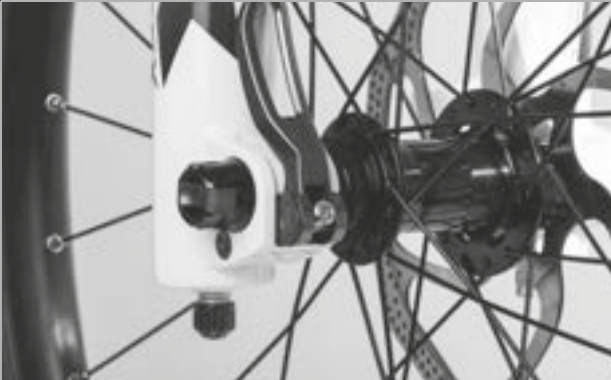
Figura 94: Corretta posizione della leva di serraggio
