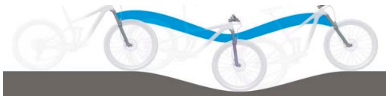
Figura 162: Comportamento di marcia ottimale su un terreno con dossi
