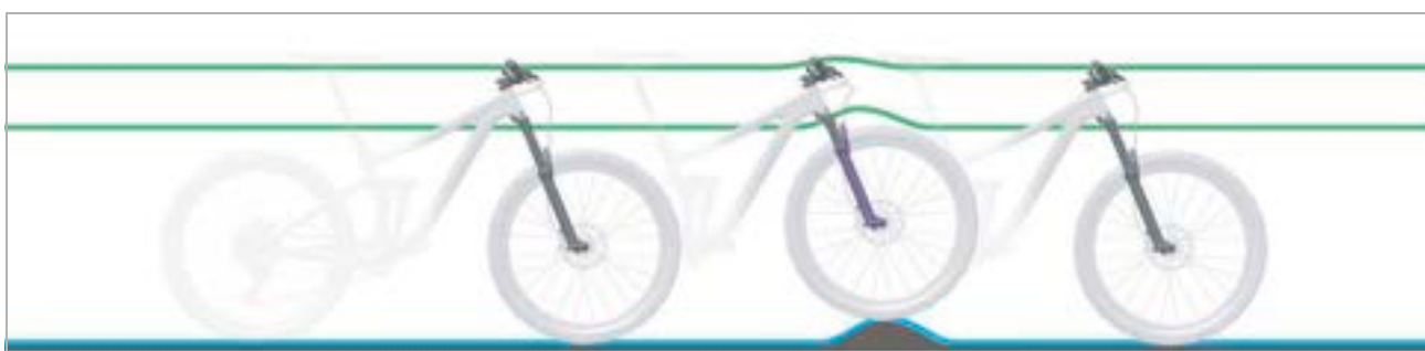
Figura 141: Comportamento di marcia ottimale della forcella su un terreno con asperità
