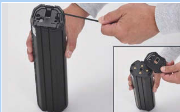
Figura 79: Smontaggio dell'interfaccia superiore
