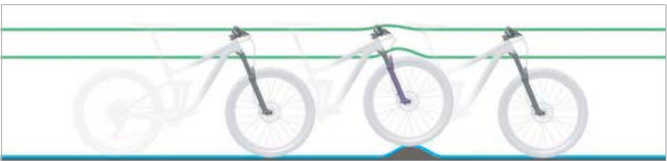
Figura 14: Comportamento di marcia ottimale della forcella su un terreno con asperità
