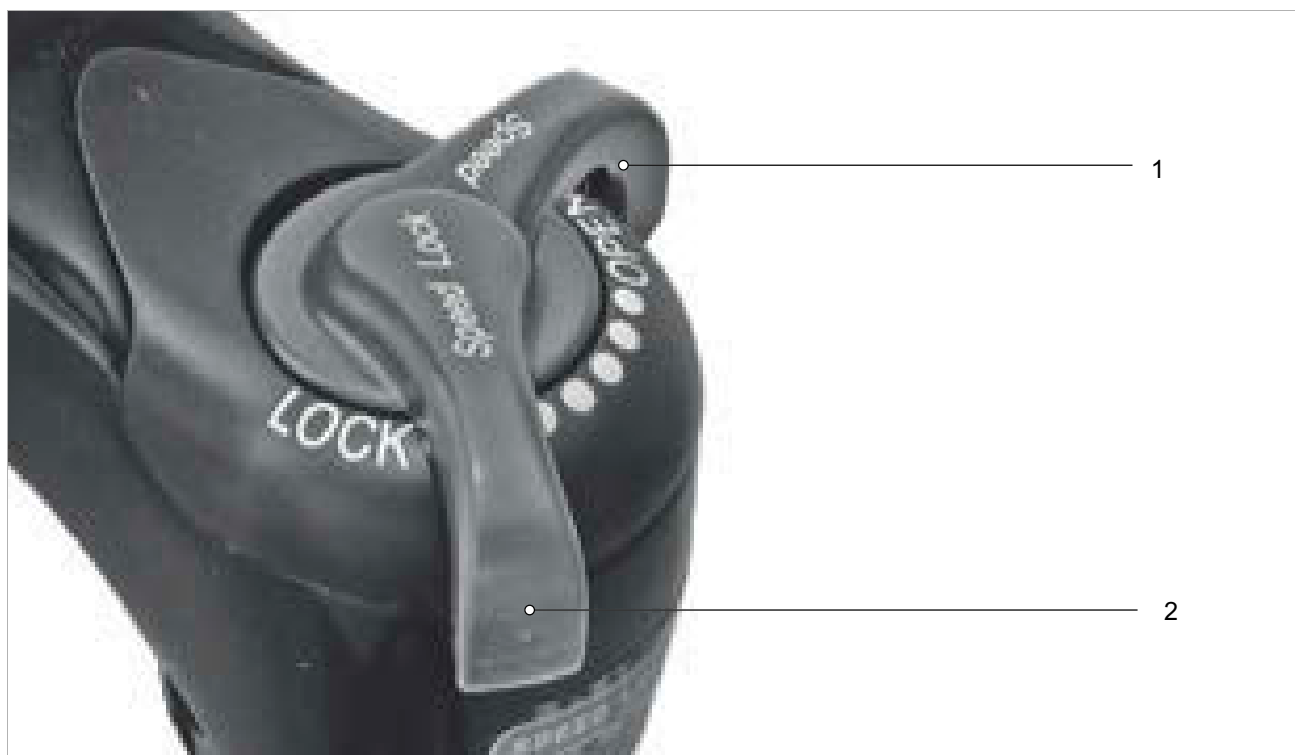
Figura 165: Ammortizzatore a stadi di pressione SR SUNTOUR in posizione aperta (1) e chiusa (2)
