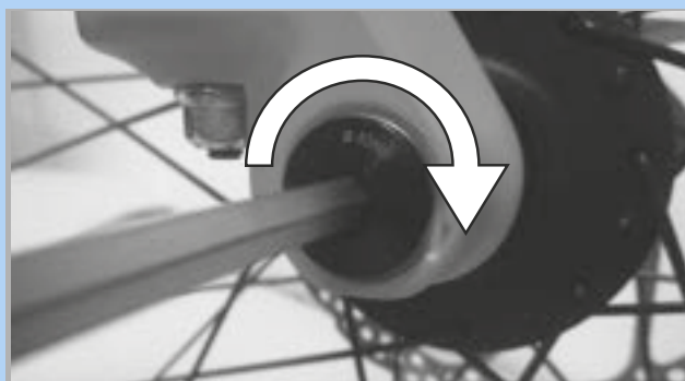
Figura 87: Serraggio del perno nel verso della freccia
