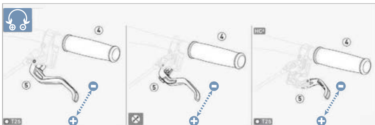
Figura 133: Regolazione dell'ampiezza di presa del freno a mano MAGURA con freno a disco
