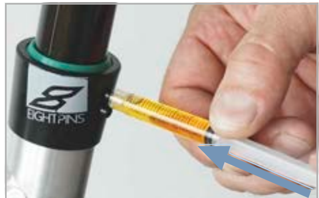
Figura 175: Lubrificazione del cannotto reggisella Eightpins
