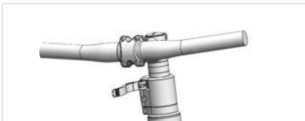
Figura 149: Esempio: All Up con leva di serraggio dell'attacco manubrio aperta
