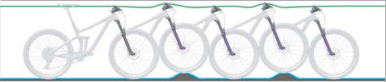
Figura 12: Comportamento di marcia ottimale della forcella
