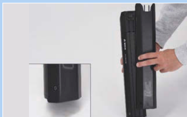
Figura 82: Applicazione della copertura della batteria sulla batteria
