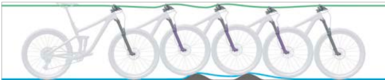
Figura 193: Corsa di estensione troppo lenta della forcella ammortizzata
