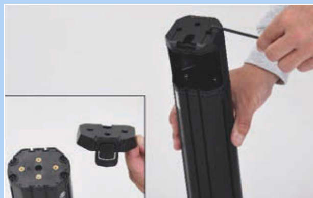
Figura 81: Avvitamento della piastra di montaggio della batteria
