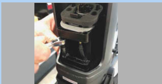
Figura 71: Rimozione delle viti a testa esagonale da 4 mm
