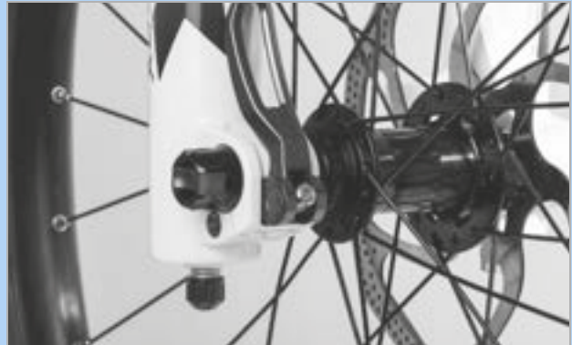
Figura 187: Regolazione della forza di serraggio del bloccaggio rapido
