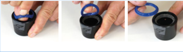
Figura 179: Estrazione del parapolvere
