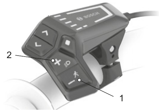
Figura 108: Ubicazione del pulsante più e del pulsante meno
