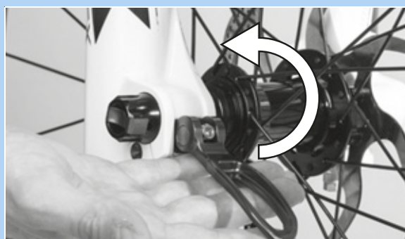
Figura 50: Spinta della leva del bloccaggio rapido nel verso della freccia
