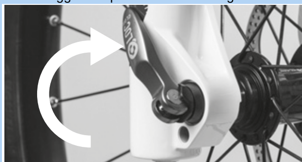
Figura 56: Chiusura del bloccaggio rapido
