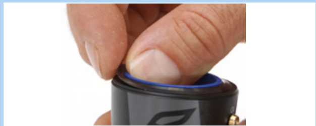
Figura 177: Estrazione dell'anello a labbro di tenuta
