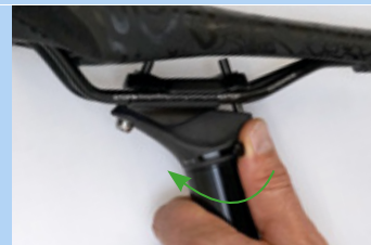
Figura 190: Chiusura della regolazione in altezza
