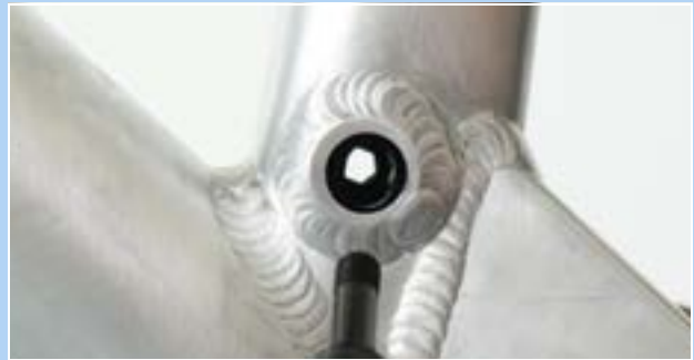
Figura 194: Foro dell'interfaccia Postpin
