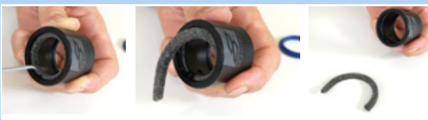
Figura 180: Rimozione dell'anello di feltro
