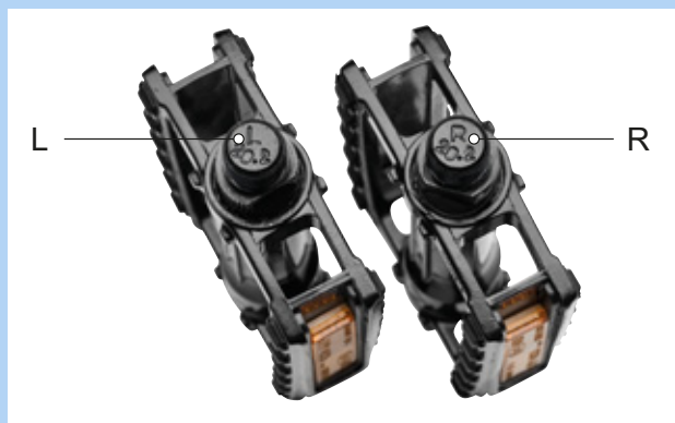
Figura 57: Esempio: identificazione dei pedali
