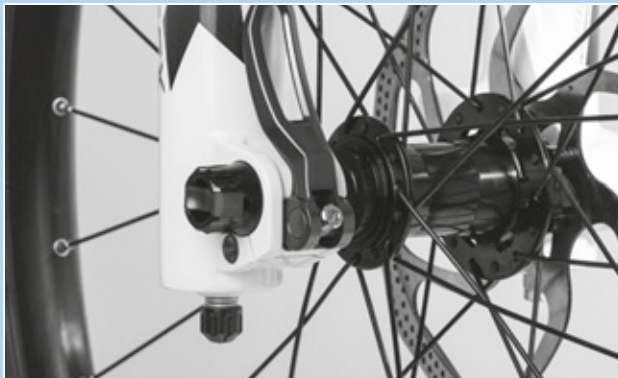
Figura 131: Regolazione della forza di serraggio del bloccaggio rapido
