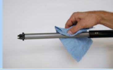
Figura 187: Pulizia della scanalatura di guida longitudinale
