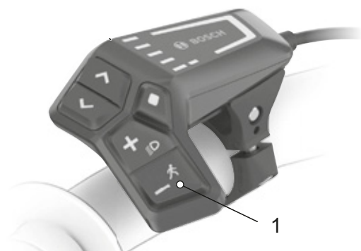
Figura 107: Ubicazione del tasto della funzione di assistenza di spinta (1)
