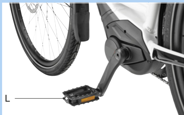
Figura 58: Pedale L nel braccio sinistro della pedivella
