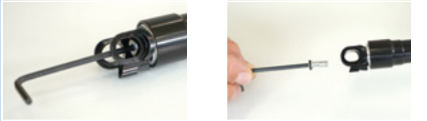
Figura 154: Svitamento del cappuccio della valvola
