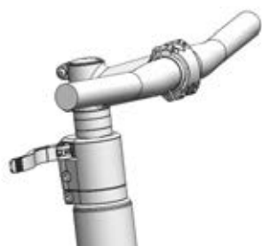
Figura 114: Esempio: All Up con leva di serraggio dell'attacco manubrio aperta
