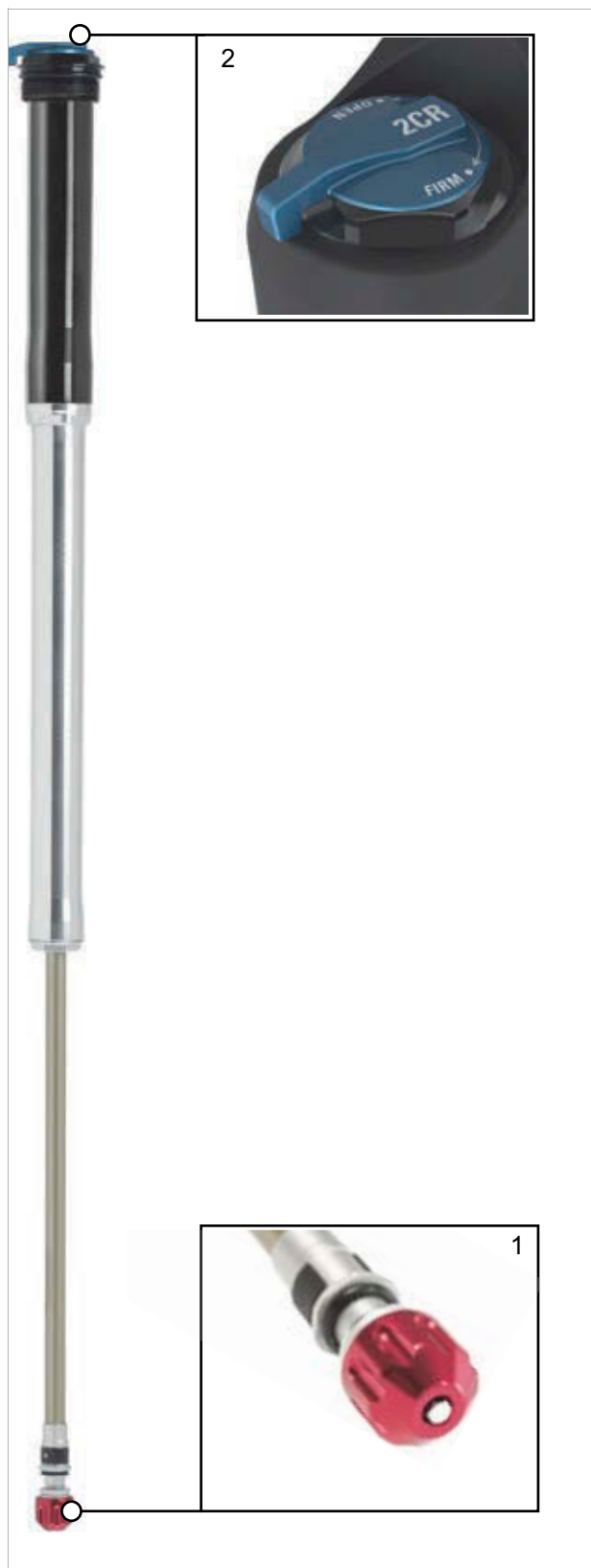
Figura 19: Terminali di comando di 2CR-PCS
