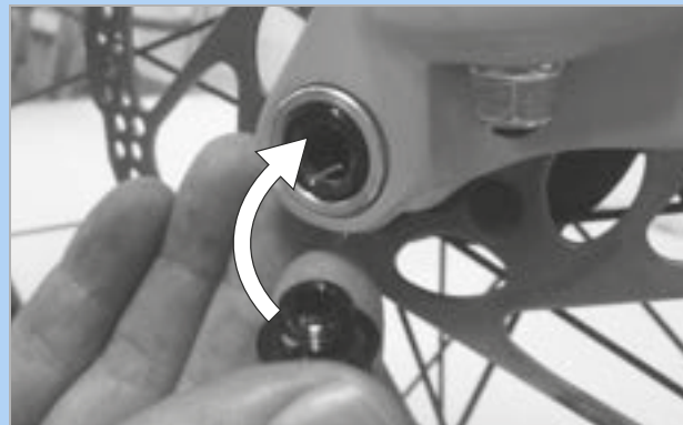
Figura 85: Applicazione della vite di sicurezza
