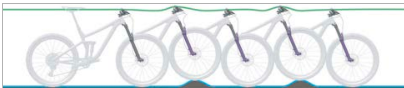
Figura 136: Comportamento di marcia ottimale della forcella
