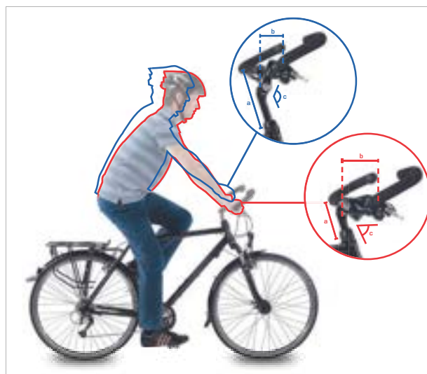
Figura 124: Posizione per bicicletta da città (blu) e per bicicletta da trekking (rosso) tramite modifica dell'angolo
