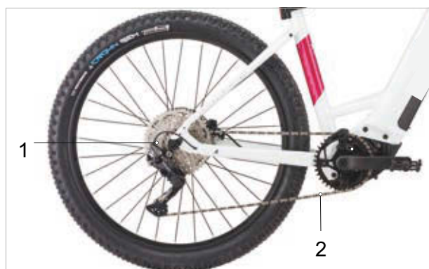
Figura 48: Schema della struttura a catena con cambio a catena
