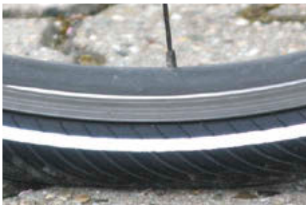
Figura 126: Corretta pressione di gonfiaggio. Lo pneumatico quasi non si deforma sotto il peso corporeo
