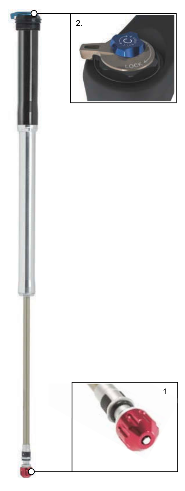
Figura 21: Terminali di comando di LOR
