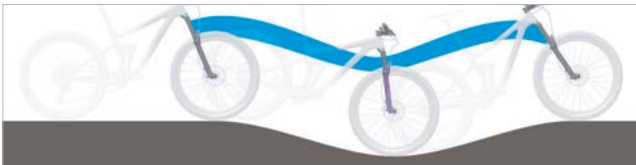
Figura 137: Comportamento di marcia ottimale della forcella su un terreno con dossi
