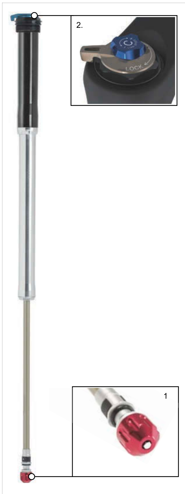
Figura 22: Terminali di comando di LO
