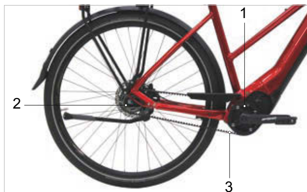
Figura 49: Schema della trasmissione a cinghia
