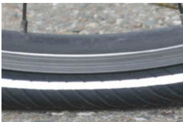
Figura 127: Pressione di gonfiaggio insufficiente
