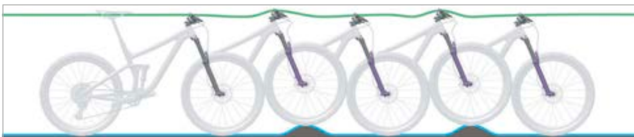
Figura 15: Comportamento di marcia ottimale della forcella
