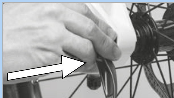
Figura 94: Inserimento del bloccaggio rapido nel verso della freccia
