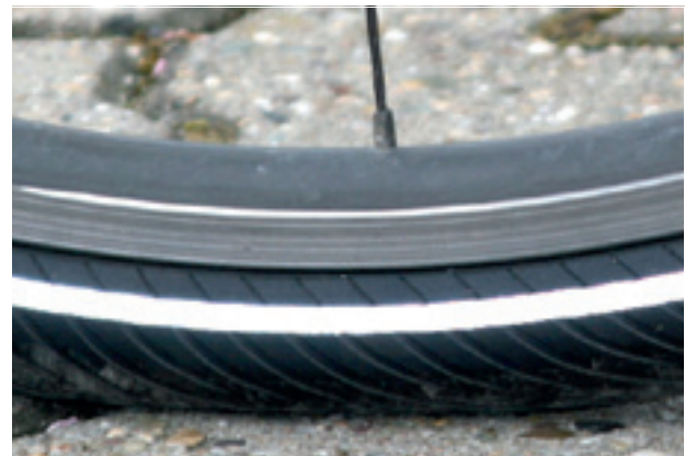
Abbildung 83: Korrekter Fülldruck. Der Reifen ist unter der Last des Körpergewichts kaum verformt.
