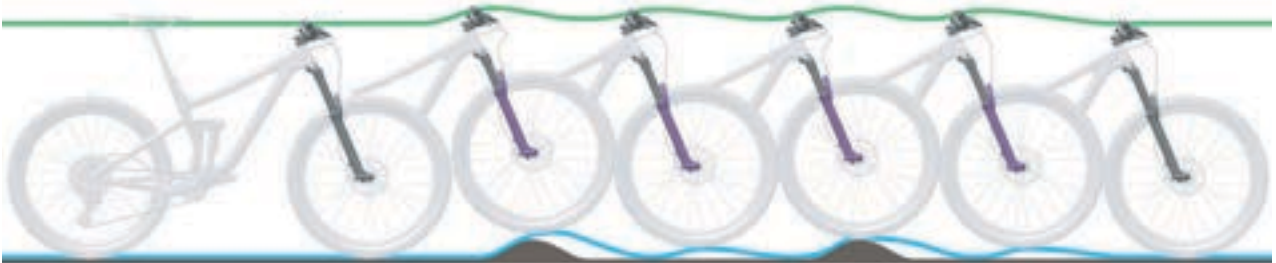
Abbildung 194: Zu schnelles Ausfedern der Federgabel
