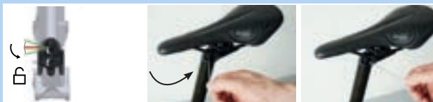
Abbildung 132: Höhenverstellungsbetätigung in „Geöffnete Stellung“ bringen
