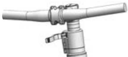
Abbildung 95: Beispiel All Up mit geöffnetem Vorbau-Spannhebel
