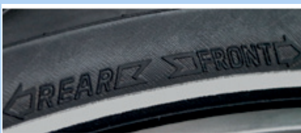
Abbildung 41: Laufrichtungspfeil auf MTB Reifen
