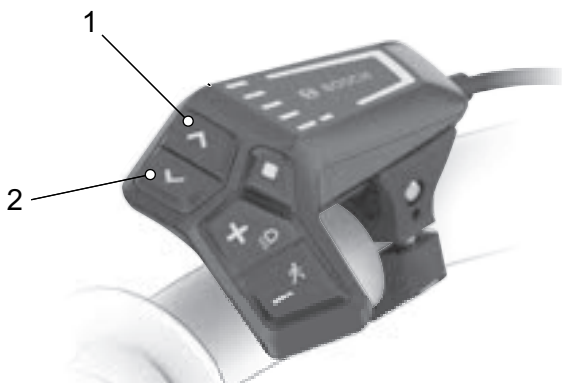
Abbildung 105: Lage Helligkeit erhöhen-Taste (2) und Helligkeit vermindern-Taste (1)
