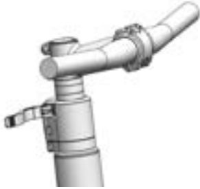
Abbildung 113: Beispiel All Up mit geöffnetem Vorbau-Spannhebel
