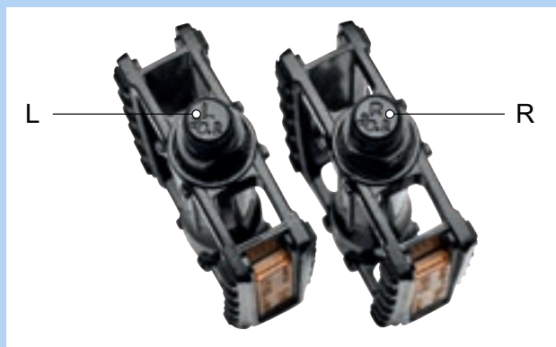
Abbildung 56: Beispiel Kennzeichnung von Pedalen
