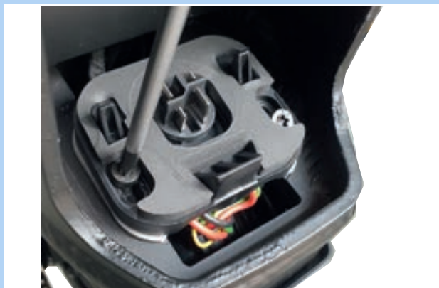
Abbildung 37: Akkuhalter Schrauben lösen
