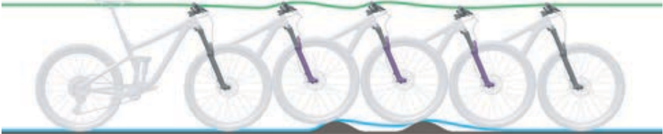
Abbildung 196: Zu langsames Ausfedern der Federgabel
