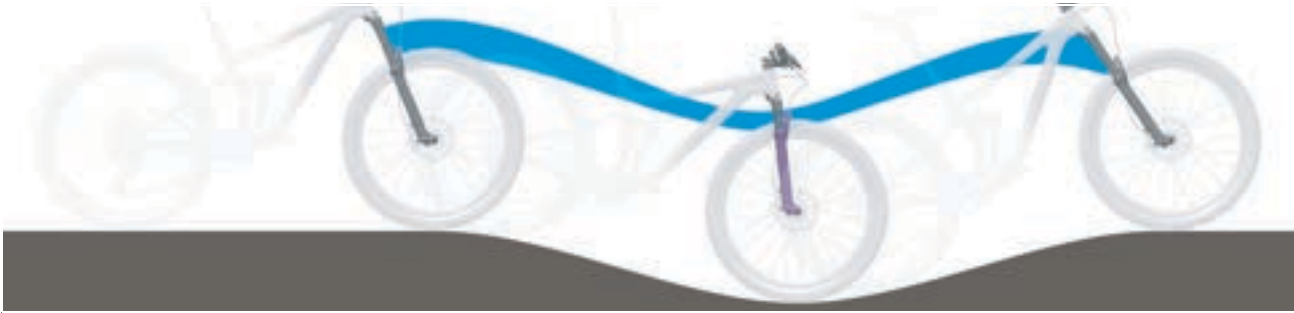
Abbildung 198: Zu weiche Federung der Federgabel am Berg
