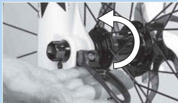
Abbildung 49: Schnellspannhebel in Pfeilrichtung drücken
