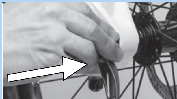
Abbildung 53: Schnellspanner in Pfeilrichtung einschieben
