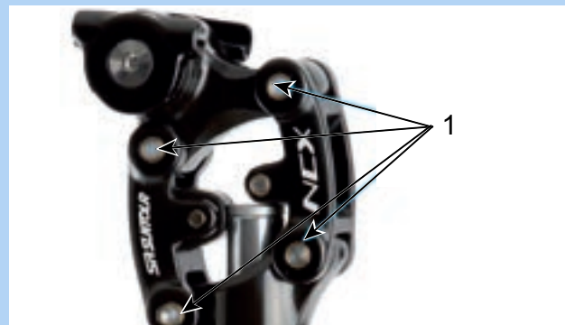
Abbildung 131: Schmierpunkte SR Suntour Feder-Sattelstütze
