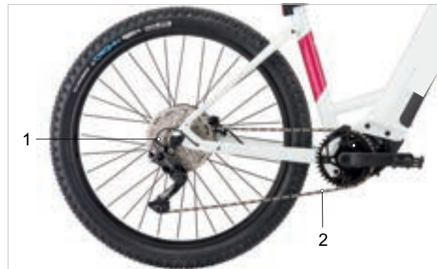
Abbildung 47: Schema Kettenantrieb mit Kettenschaltung
