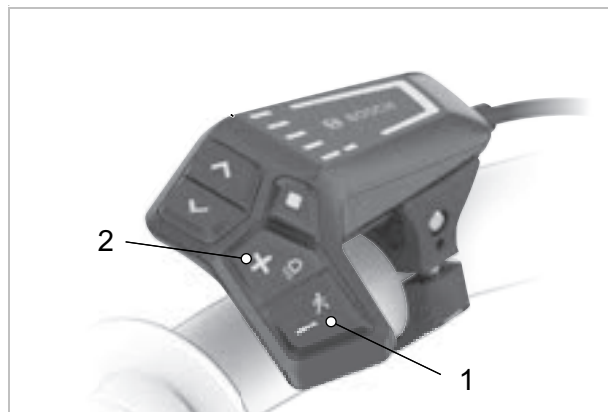
Abbildung 168: Lage Plus-Taster und Minus-Taster
