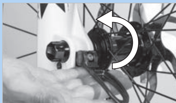
Abbildung 89: Schnellspannhebel in Pfeilrichtung drücken
