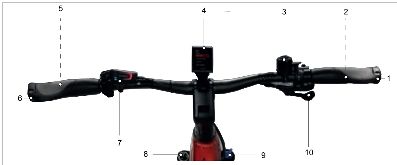
Abbildung 54: Detailansicht Lenker mit BOSCH Kiox300, Beispiel
