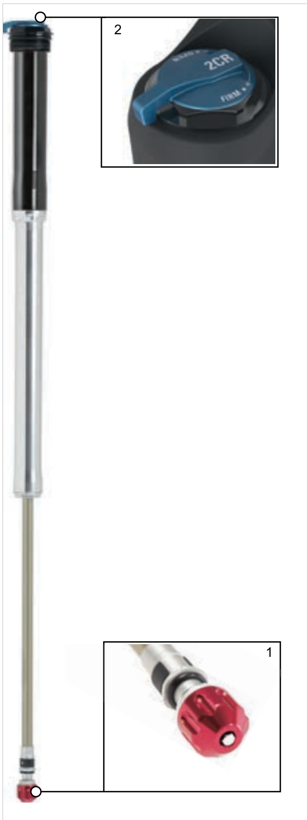
Abbildung 18: Bedienelemente des 2CR-PCS
