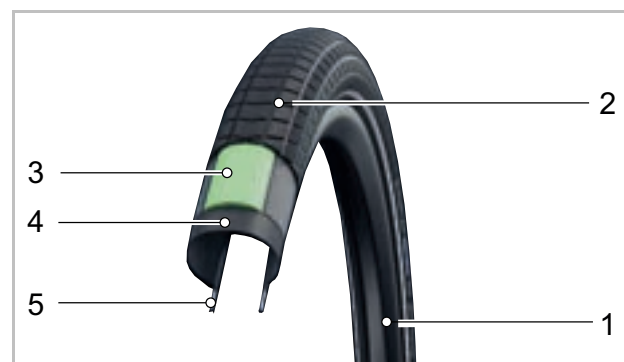
Abbildung 26: Aufbau offener Reifen
