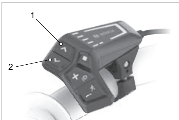
Abbildung 166: Lage Helligkeit erhöhen-Taste (2) und Helligkeit vermindern-Taste (1)
