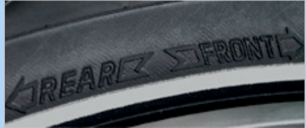
Abbildung 97: Laufrichtungspfeil auf MTB-Reifen
