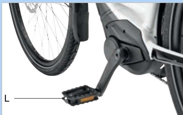
Abbildung 99: L-Pedal im linken Kurbelarm
