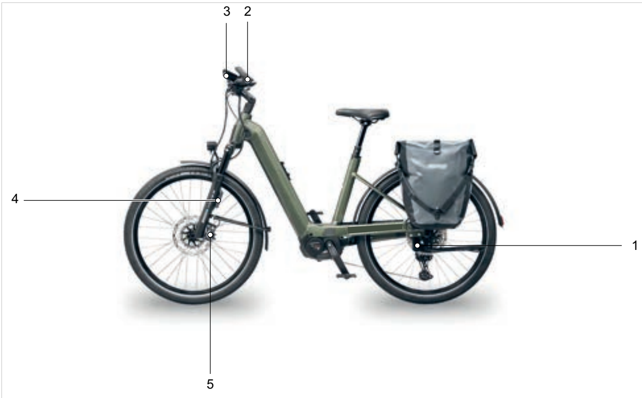
Abbildung 45: Komponenten BOSCH ABS
