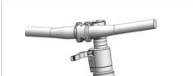
Abbildung 150: Beispiel All Up mit geöffnetem Vorbau-Spannhebel
