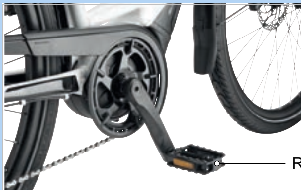
Abbildung 100: R-Pedal im rechten Kurbelarm
