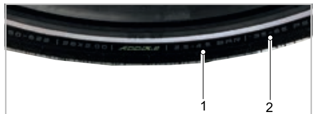
Abbildung 184: Angabe Fülldruck in bar (1) und psi (2)
