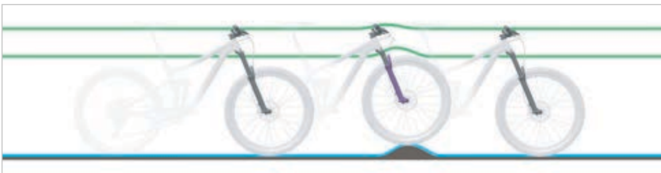
Abbildung 158: Hart und weich eingestellter Druckstufen-Dämpfer
