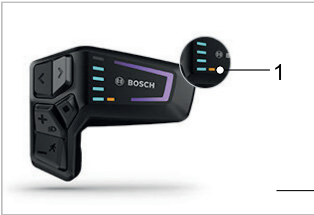
Abbildung 56: Beispiel Lage ABS Kontrollleuchte (1) auf dem LED-Remote
