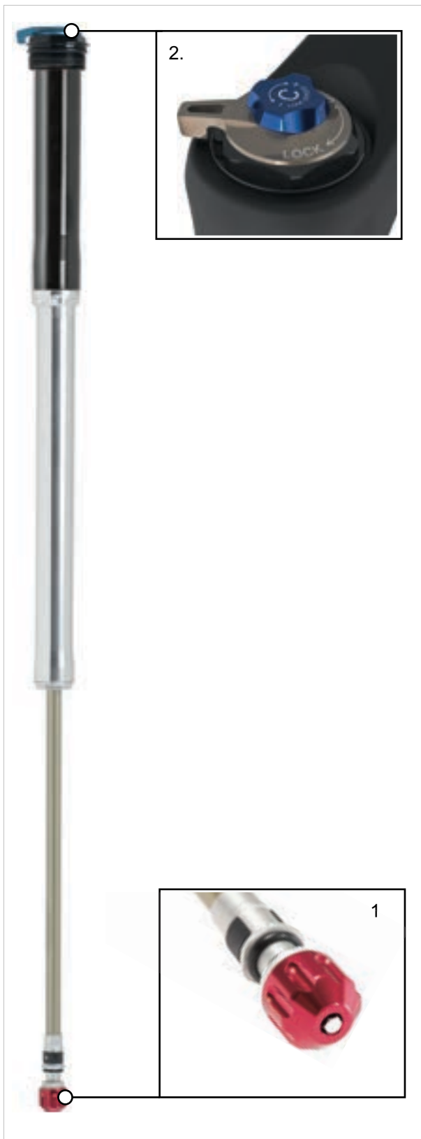
Abbildung 22: Bedienelemente des RL
