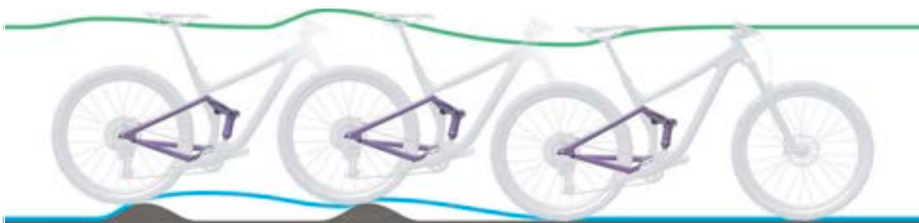
Figura 236: Corsa di estensione troppo lenta dell'ammortizzatore del carro posteriore
