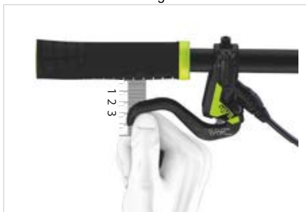
Figura 132: Posizionamento del freno a mano
