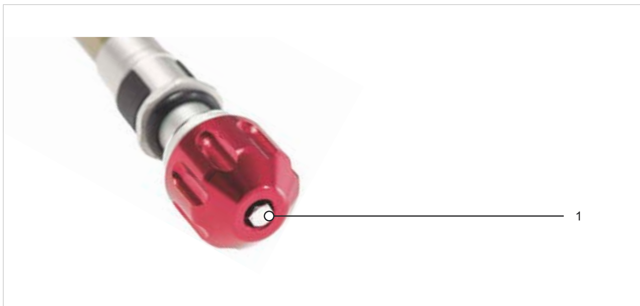
Figura 229: Esempio di vite del rebound (1) SR SUNTOUR
