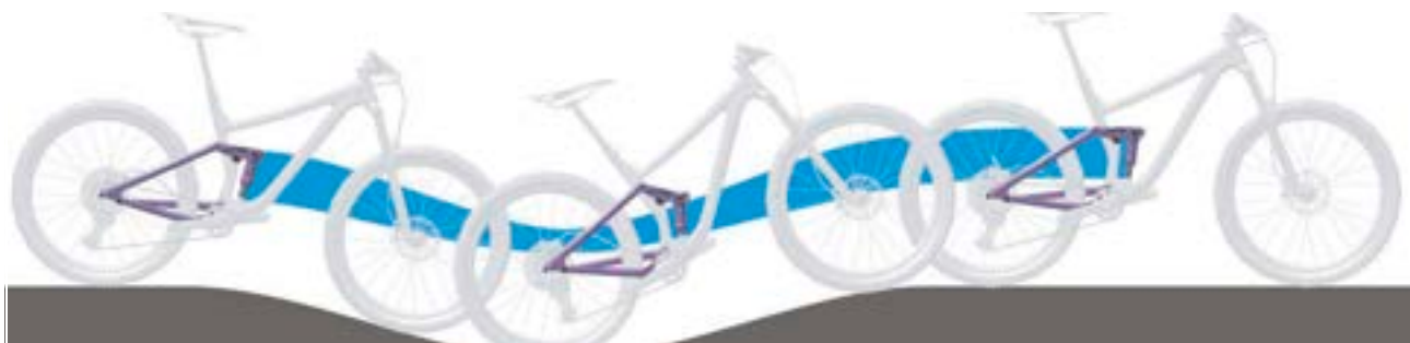
Figura 238: Sospensione dell'ammortizzatore del carro posteriore troppo morbida in salita
