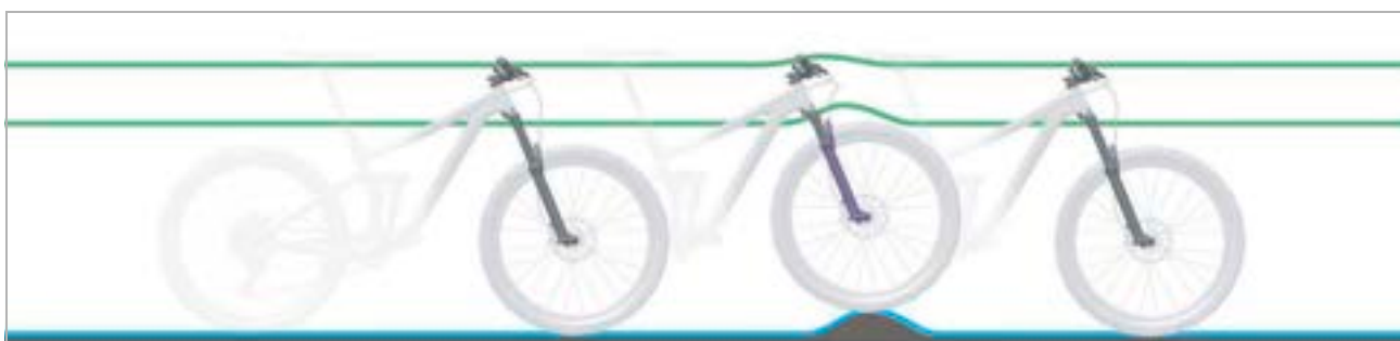
Figura 20: Comportamento di marcia ottimale della forcella su un terreno con asperità
