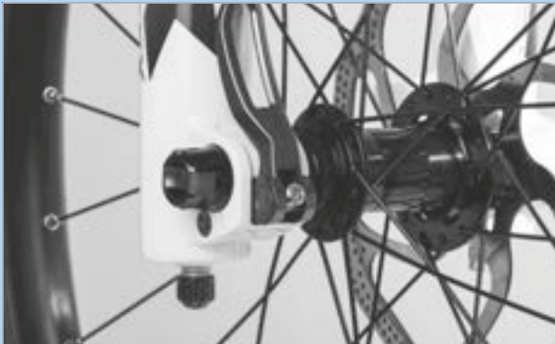
Figura 92: Corretta posizione della leva di serraggio
