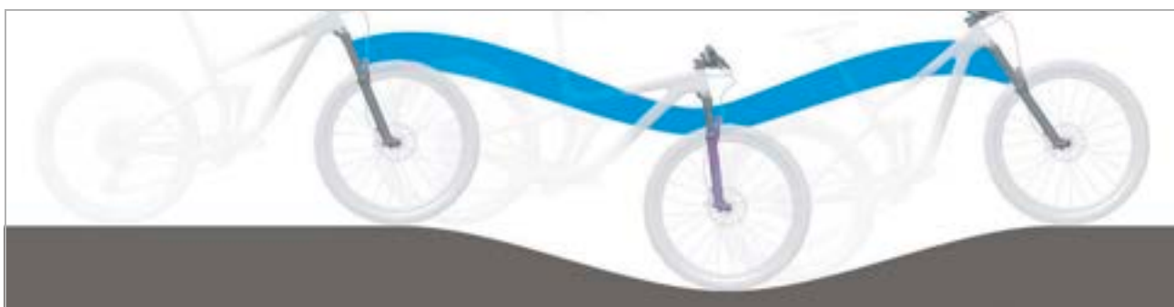
Figura 19: Comportamento di marcia ottimale della forcella su un terreno con dossi
