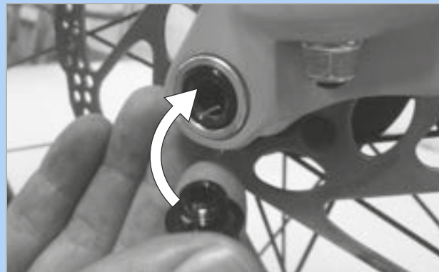
Figura 86: Applicazione della vite di sicurezza
