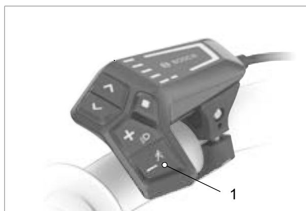
Figura 178: Ubicazione del tasto della funzione di assistenza di spinta (1)
