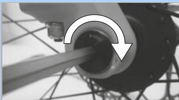
Figura 85: Serraggio del perno nel verso della freccia
