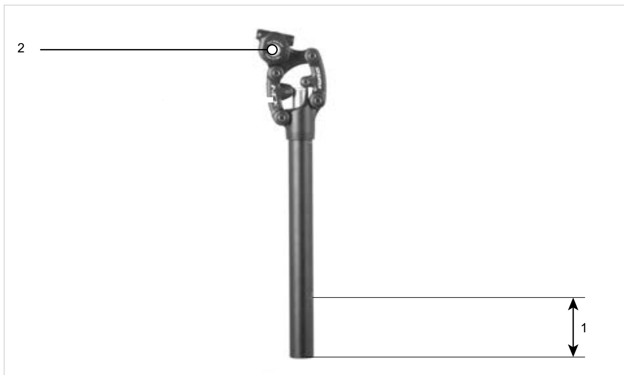
Figura 48: Struttura del canotto reggisella by.schulz G2
