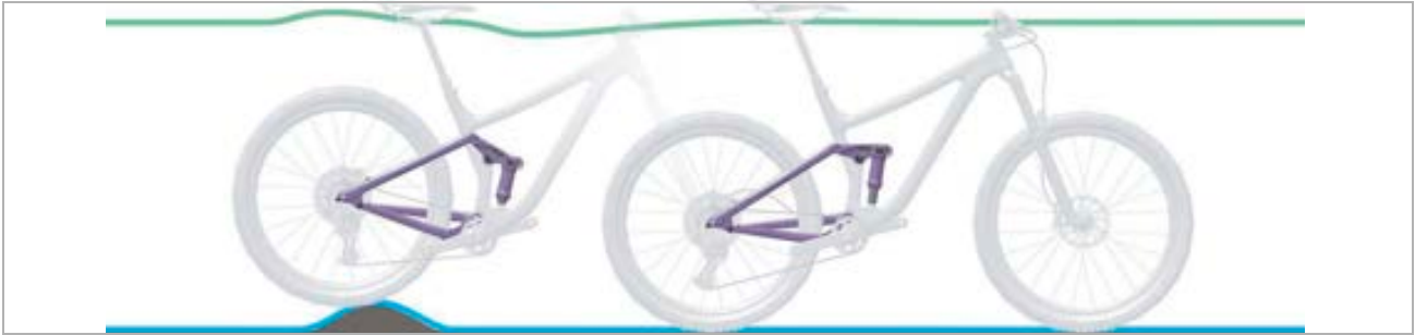
Figura 7: Comportamento di marcia ottimale dell'ammortizzatore del carro posteriore su asperità
