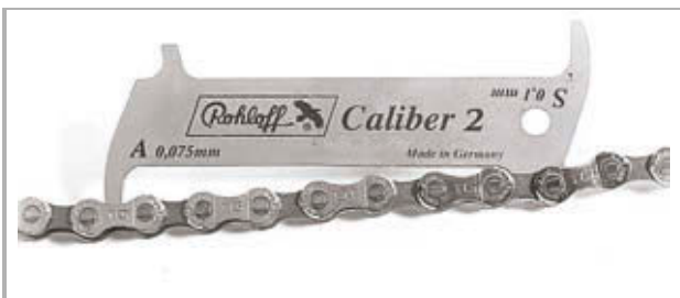
Figura 201: Esempio di calibro di misura dell'usura ROHLOFF
