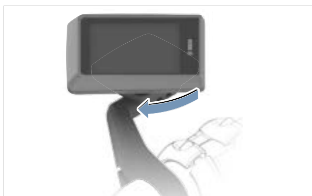
Figura 153: Rotazione del display in senso orario
