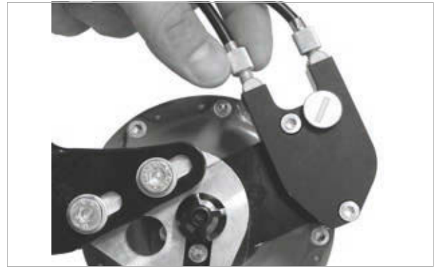
Figura 221: Le versioni del mozzo ROHLOFF con comando esterno del cambio hanno i regolatori del tensionamento sulla scatola dei cavi situata sul lato sinistro
