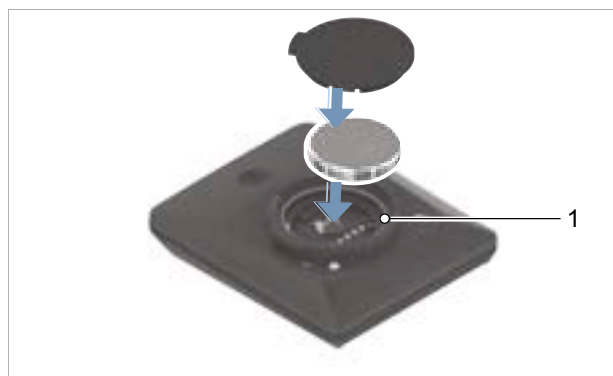
Figura 151: Inserimento della batteria con guarnizione di gomma (1) posizionata correttamente
