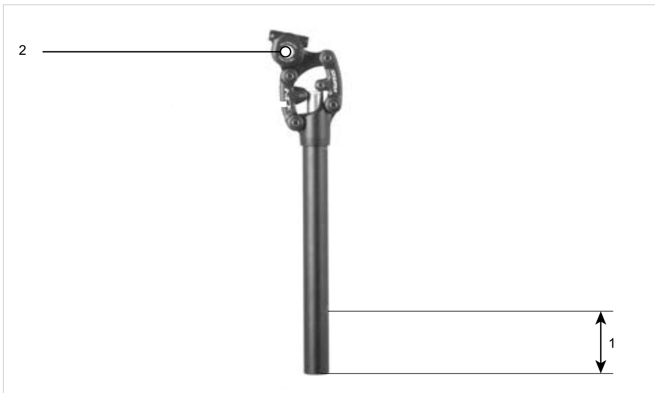
Figura 81: Dimensioni cannotto reggisella SR SUNTOUR, NCX
