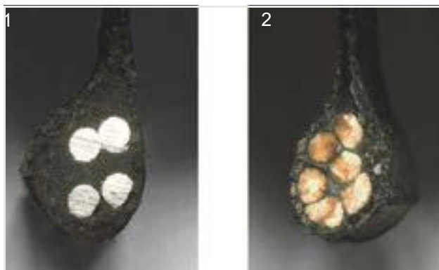
Figura 33: Cerchietto in acciaio (1) e cerchietto in Kevlar (2)
