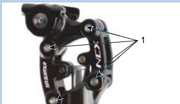
Figura 226: Punti di lubrificazione del canotto reggisella ammortizzato SR SUNTOUR
