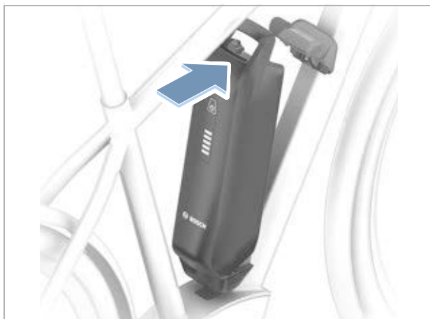
Figura 173: Ribaltamento della batteria PowerPack verso l'alto
