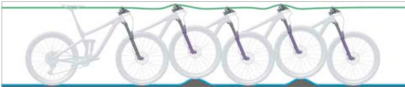
Figura 18: Comportamento di marcia ottimale della forcella
