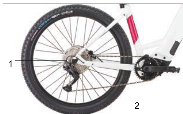
Figura 54: Schema della struttura a catena con cambio a catena
