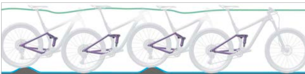
Figura 145: Comportamento di marcia ottimale dell'ammortizzatore del carro posteriore
