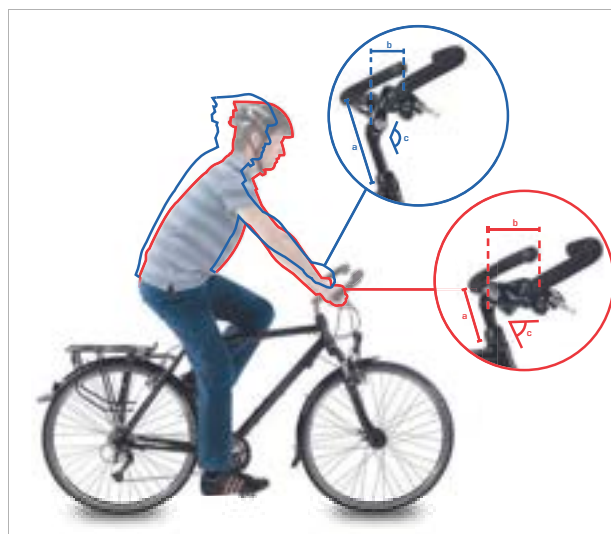
Figura 125: Posizione per bicicletta da città (blu) e per bicicletta da trekking (rosso) tramite modifica dell'angolo
