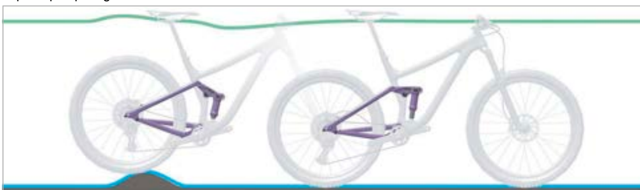
Figura 168: Comportamento di marcia ottimale dell'ammortizzatore del carro posteriore su asperità
