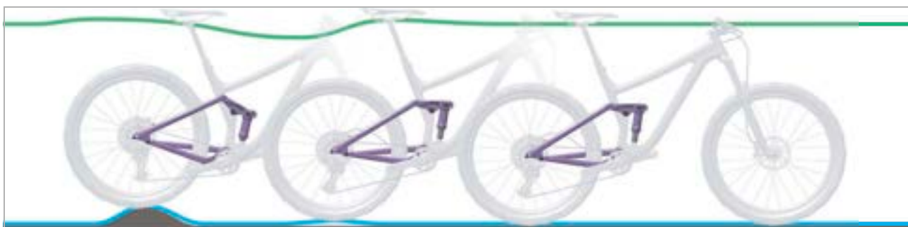
Figura 234: Corsa di estensione troppo veloce dell'ammortizzatore del carro posteriore
