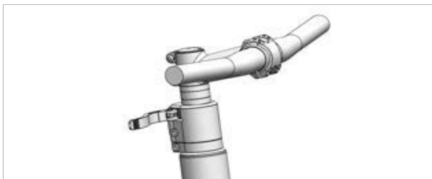
Figura 186: Esempio: All Up con leva di serraggio dell'attacco manubrio aperta
