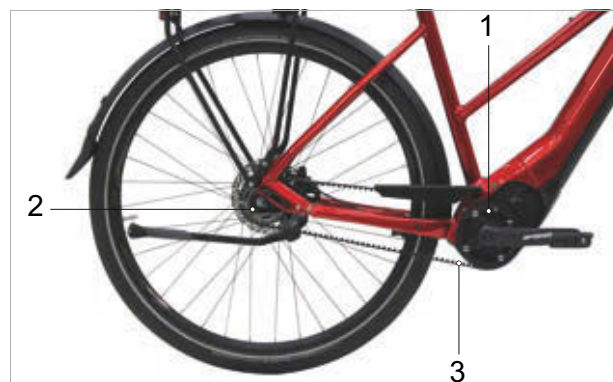
Figura 55: Schema della trasmissione a cinghia
