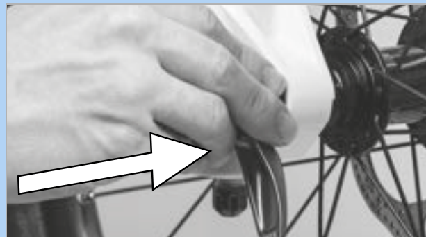
Figura 95: Inserimento del bloccaggio rapido nel verso della freccia
