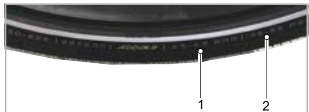
Figura 193: Pressione di gonfiaggio in bar (1) e in psi (2)
