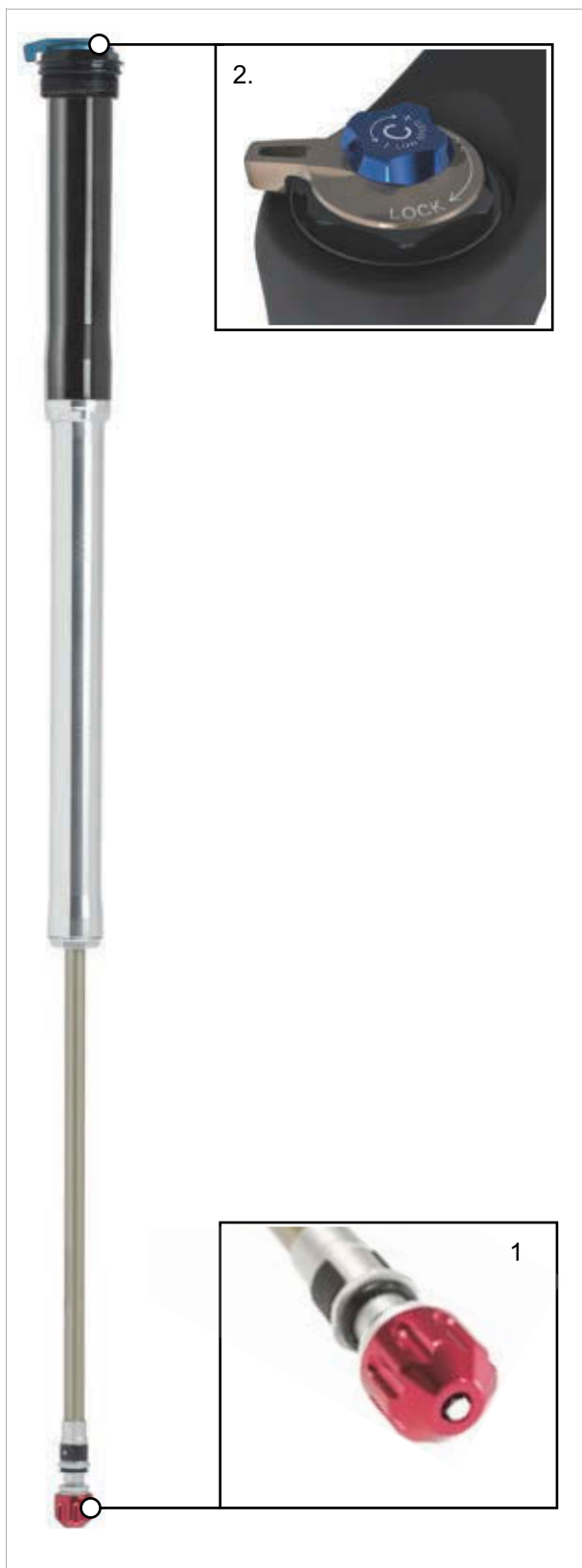
Figura 28: Terminali di comando di RL
