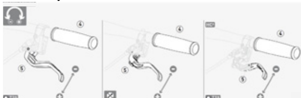
Illustration 42 : Régler la garde d'un levier de frein à disque Magura
