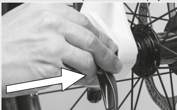
Illustration 27 : Enfoncez l'attache rapide
