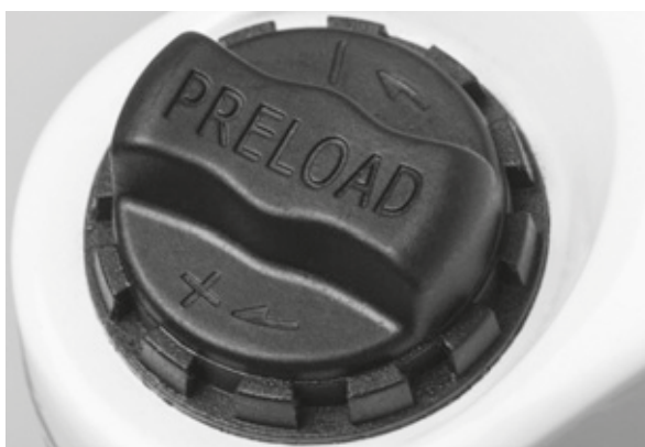
Illustration 44 : Molette de réglage de la course de suspension négative sur la couronne de la fourche de suspension
