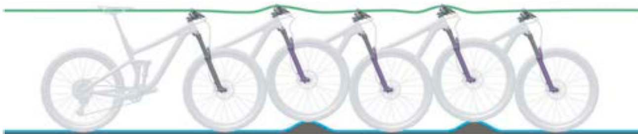
Afbeelding 119: Optimaal rijgedrag van de vork
