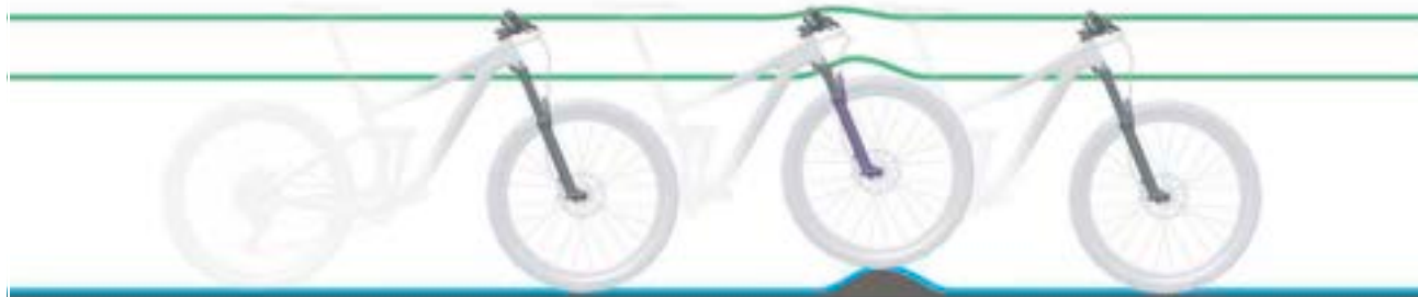
Afbeelding 117: Optimaal rijgedrag van de vork bij oneffenheden
