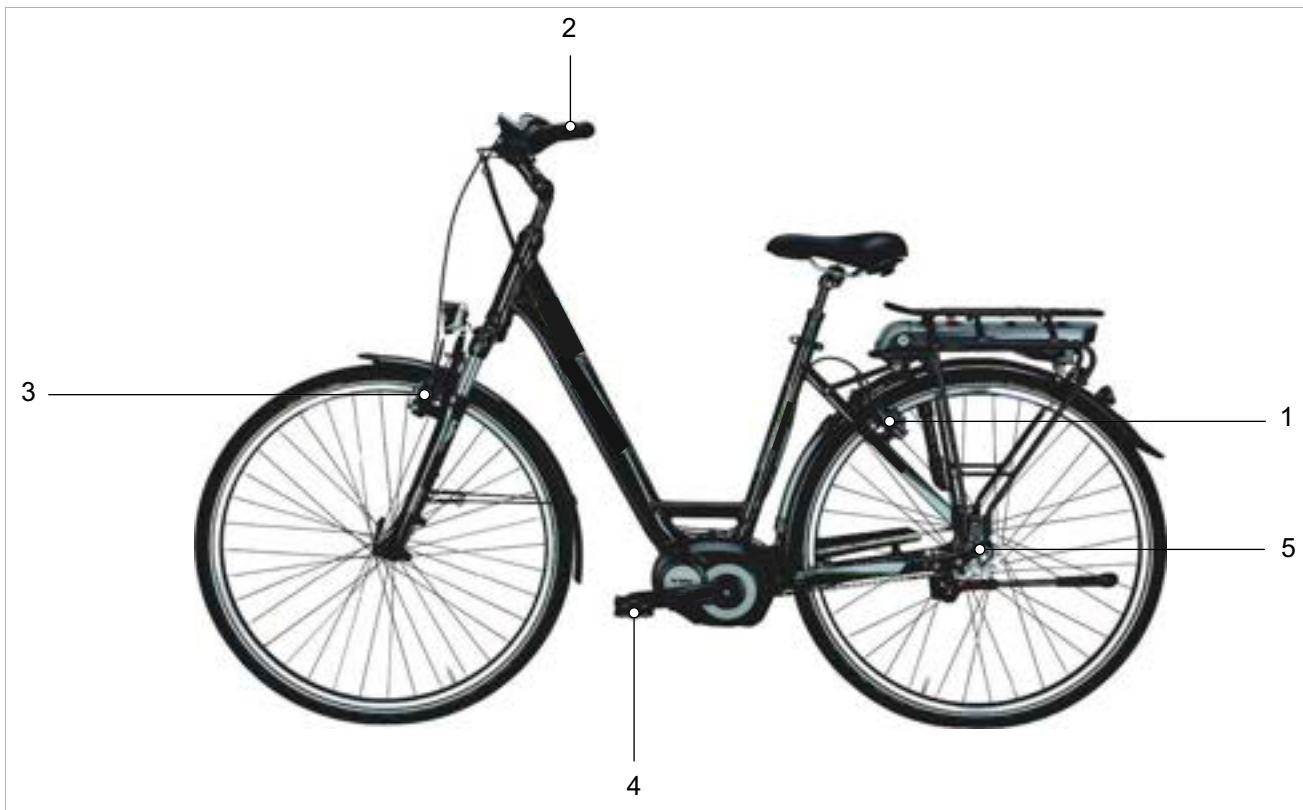
Afbeelding 44: Remsysteem met terugtraprem, voorbeeld
