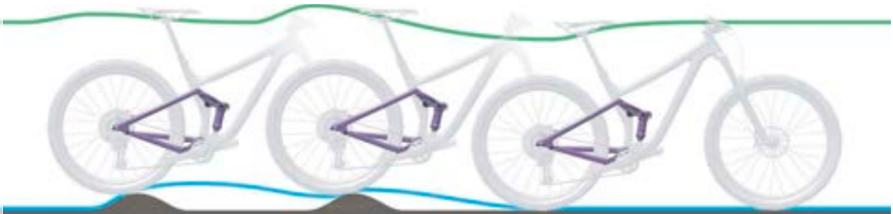
Afbeelding 195: Te langzaam uitveren van de achterbouwdemper
