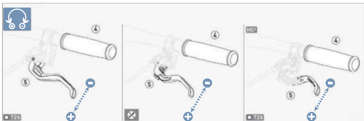
Afbeelding 111: Grijpafstand handrem MAGURA schijfrem afstellen
