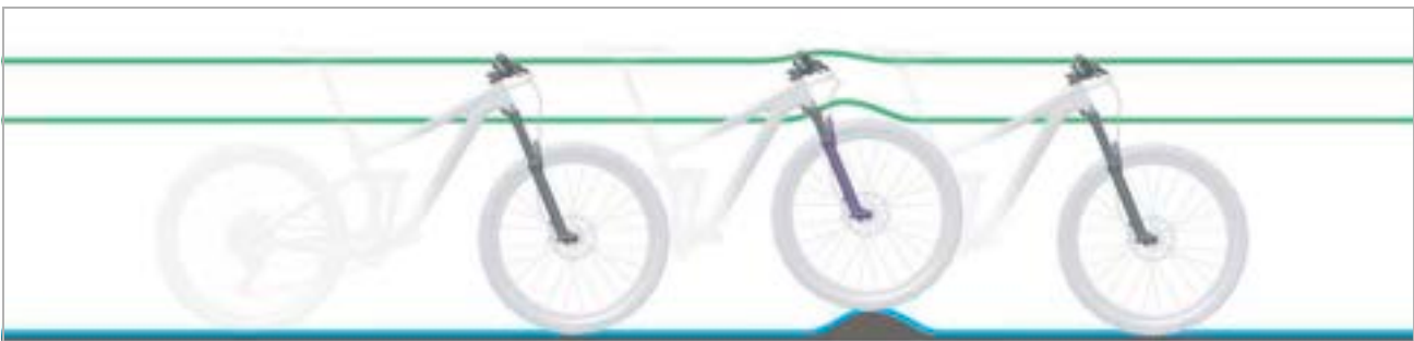
Afbeelding 15: Optimaal rijgedrag van de vork bij oneffenheden
