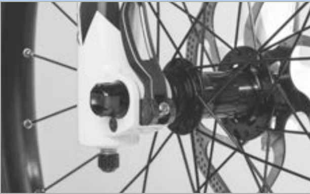
Afbeelding 85: Perfecte stand van de spanhendel
