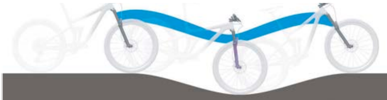
Afbeelding 116: Optimaal rijgedrag van de vork in heuvelachtig terrein
