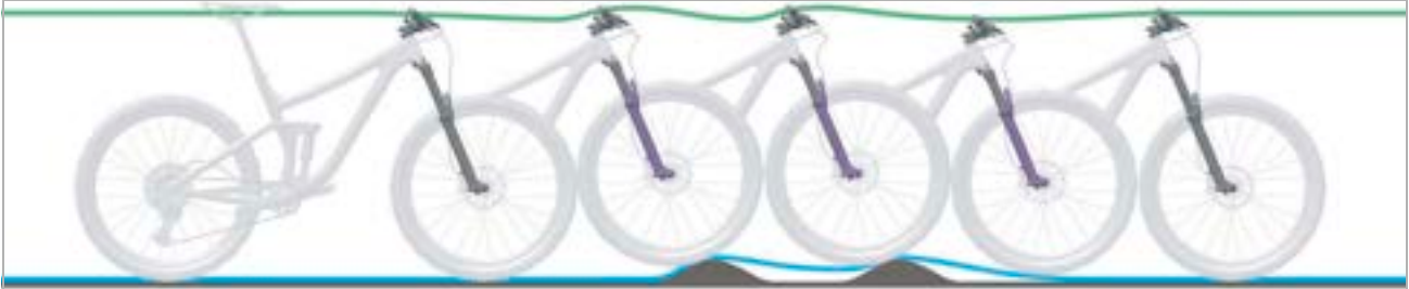
Afbeelding 189: Te langzaam uitveren van de verende voorvork
