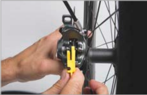
Afbeelding 154: Remvoering in gemonteerde toestand controleren met behulp van de transportbeveiliging
