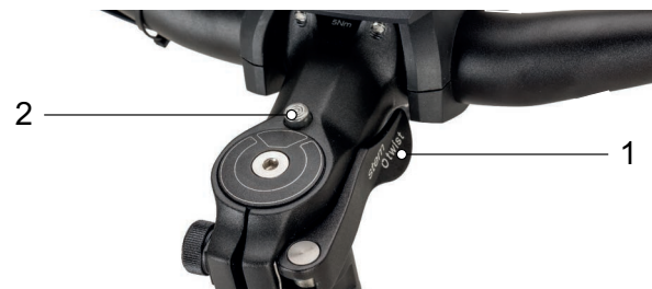
Abbildung 2: Vorbau, Ausführung II mit Spannhebel des Vorbau-Schnellspanners (1) und Entspercknopf (2)
