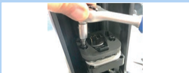
Abbildung 56: Akkuhalter Schrauben lösen
