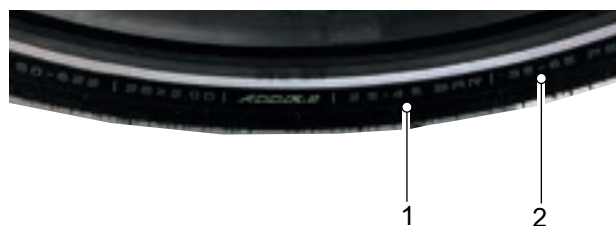
Abbildung 149: Fülldruck in bar (1) und psi (2)
