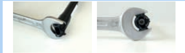
Abbildung 183: Gegen Verdrehen sichern
