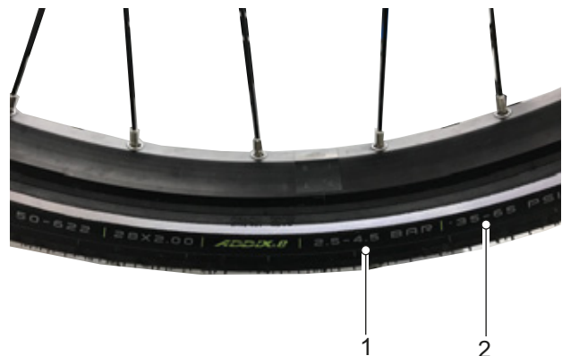
Afbeelding 126: Vuldruk in bar (1) en psi (2)
