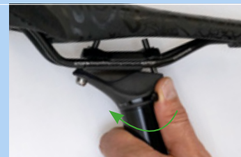
Illustration 198 : Fermer le réglage de la hauteur
