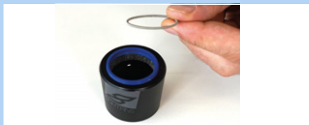
Illustration 186 : Rondelle élastique retirée
