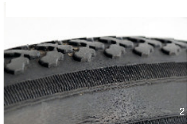
Illustration 130 : Exemples de fissures de fatigue (1) et de fissures d'âge (2)
