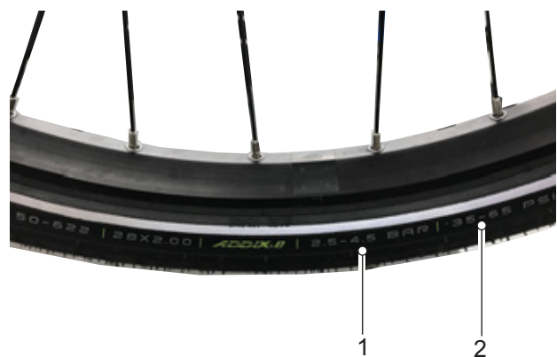
Illustration 128 : Pression des pneus en bar (1) et psi (2)
