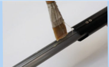
Illustration 196 : Appliquer de la graisse
