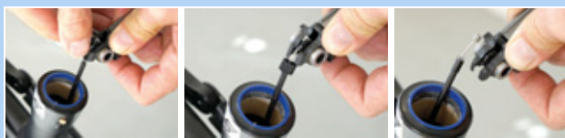
Illustration 183 : Retirer le câble Bowden
