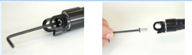
Illustration 162 : Retirer le capuchon de valve
