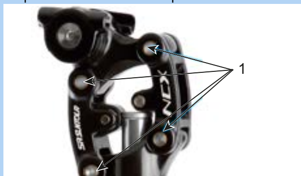
Illustration 141 : Points de lubrification de la tige de selle suspendue SR Suntour
