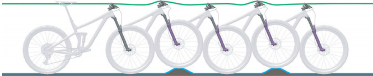
Illustration 8 : Comportement optimal de la fourche
