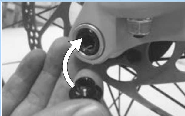
Illustration 53 : Enfoncez le levier d'attache rapide dans l'axe
