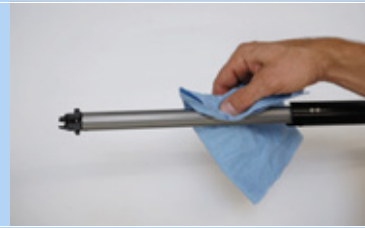
Illustration 195 : Nettoyer la rainure de guidage longitudinale
