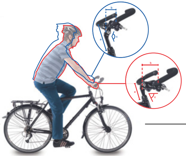
Illustration 84 : Position sur vélo de ville (en bleu) et sur vélo tout chemin (en rouge) avec modification de l'angle
