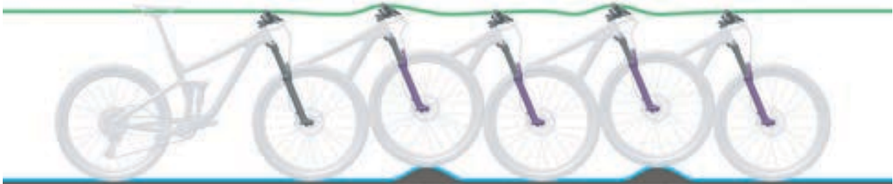
Abbildung 20: Optimales Fahrverhalten der Gabel
