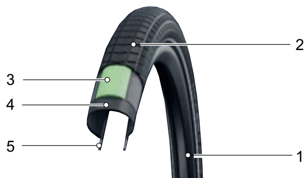
Abbildung 31: Aufbau offener Reifen
