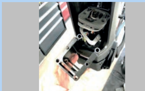
Abbildung 72: PowerTube Adapter herausziehen
