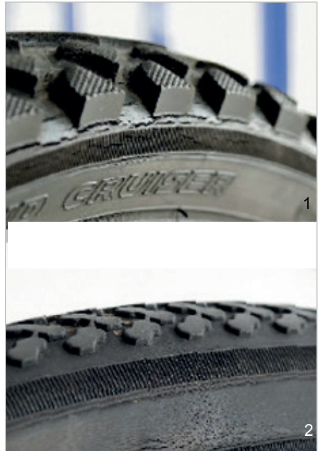
Abbildung 194: Beispiele für Ermüdungsrisse (1) und Alterungsrisse (2)
