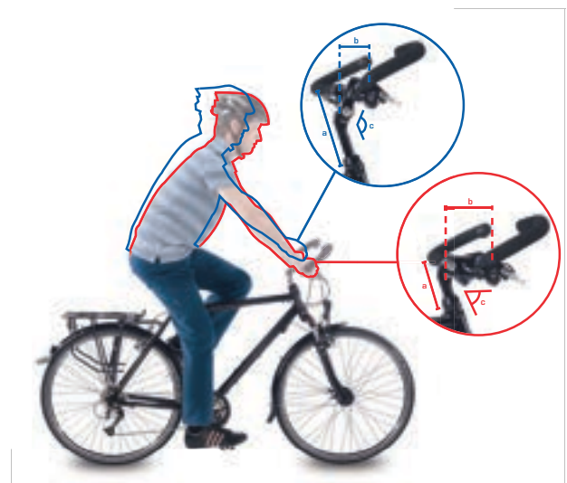
Abbildung 124: Citybike (blau) und Trekkingrad Position (rot) durch Winkeländerung
