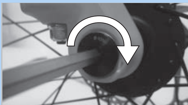
Abbildung 84: Achse in Pfeilrichtung anziehen
