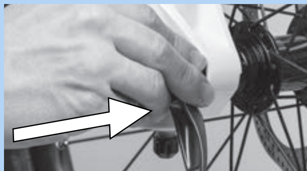
Abbildung 94: Schnellspanner in Pfeilrichtung einschieben
