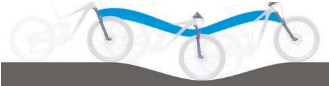
Abbildung 19: Optimales Fahrverhalten der Gabel im hügeligen Gelände
