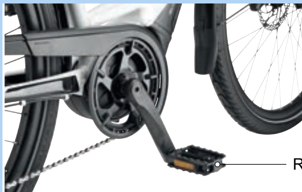
Abbildung 101: R-Pedal im rechten Kurbelarm
