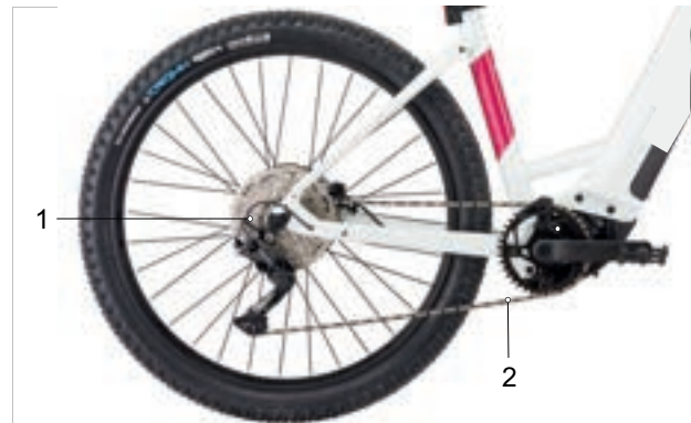
Abbildung 53: Schema Kettenantrieb mit Kettenschaltung
