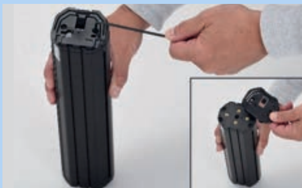
Abbildung 75: Demontage oberes Interface
