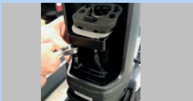
Abbildung 70: 4 mm 6-Kant-Schrauben entfernen
