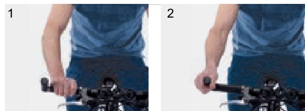
Abbildung 163: Griffpositionen am Bar End
