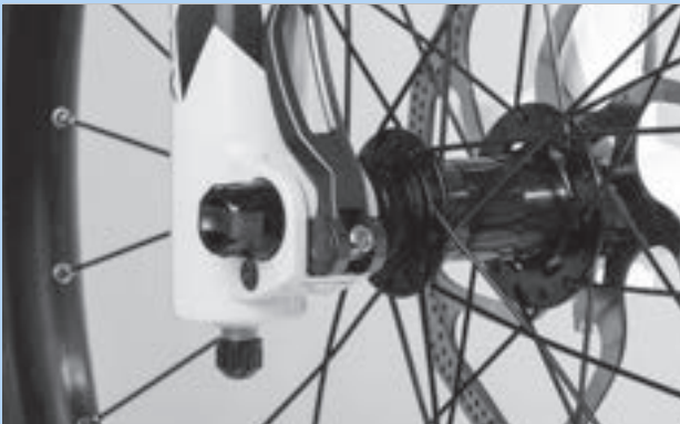
Abbildung 91: Perfekte Lage des Spannhebels
