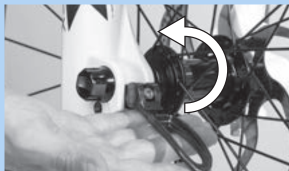
Abbildung 90: Schnellspannhebel in Pfeilrichtung drücken
