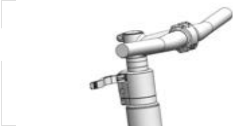
Abbildung 168: Beispiel All Up mit geöffnetem Vorbau-Spannhebel
