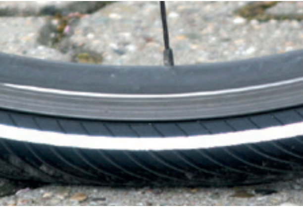
Abbildung 126: Korrekter Fülldruck. Der Reifen ist unter der Last des Körpergewichts kaum verformt
