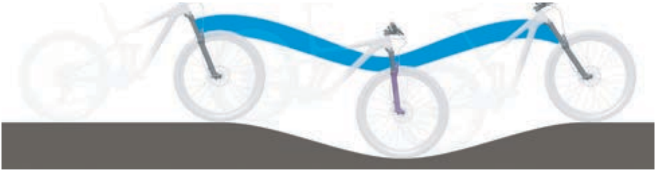
Abbildung 134: Optimales Fahrverhalten der Gabel im hügeligen Gelände
