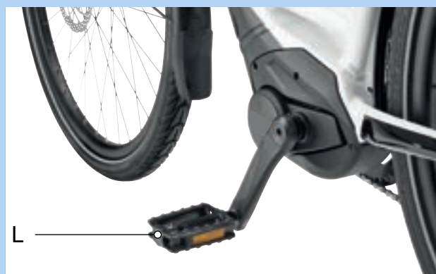
Abbildung 100: L-Pedal im linken Kurbelarm
