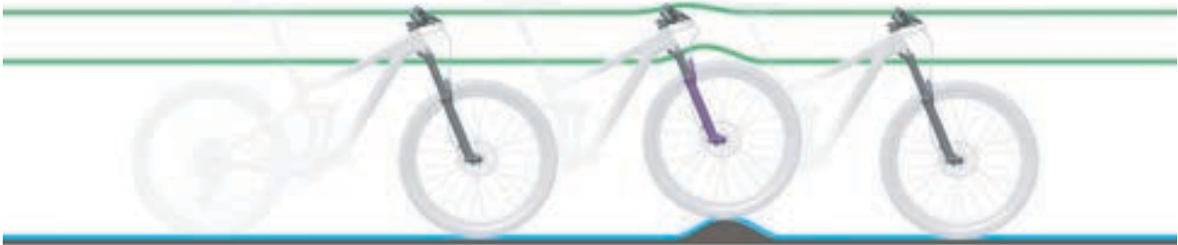
Abbildung 135: Optimales Fahrverhalten der Gabel bei Unebenheiten
