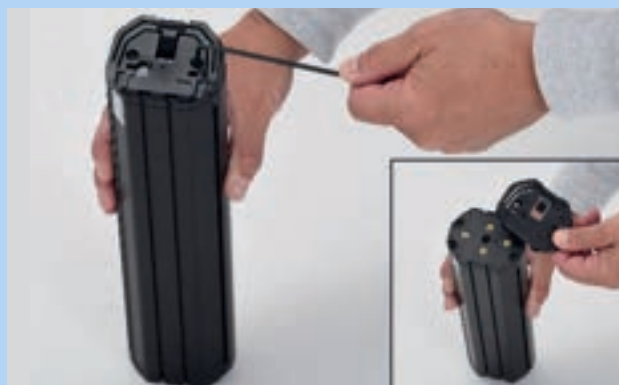
Abbildung 78: Demontage oberes Interface
