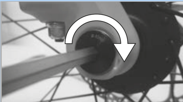
87. ábra: A tengely meghúzása nyírányban
