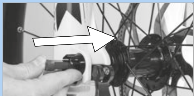
92. ábra: Piros kar betolása nyílrányban
