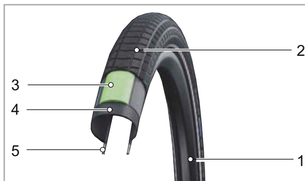
21. ábra: Nyitott gumiabroncsok felépítése
