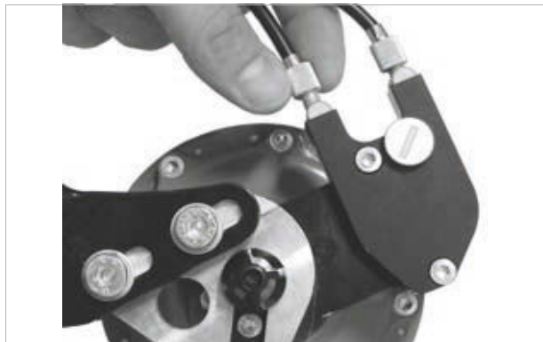
184. ábra: Külső váltóvezérléssel rendelkező ROHLOFF agyváltozatok húzásbeállítója a kötéldobozon van, ami a bal oldalon található
