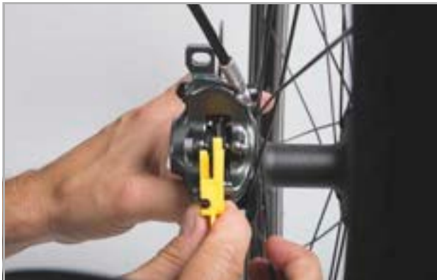
179. ábra: Fékbetét ellenőrzése beépített állapotban a szállítási rögzítés segítségével
