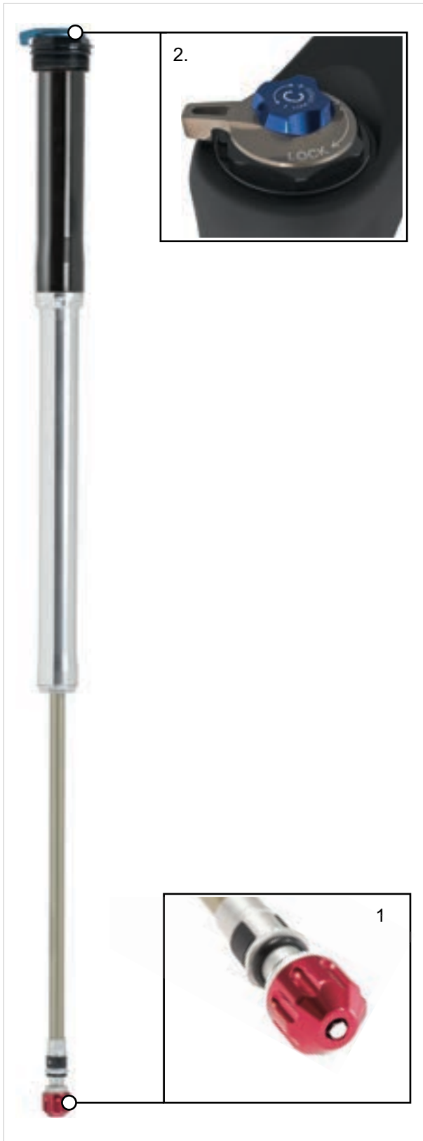
Abbildung 20: Bedienelemente des HLO
