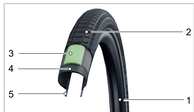
Abbildung 23: Aufbau offener Reifen
