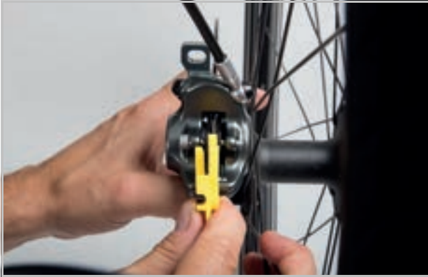
Abbildung 153: Bremsbelag im eingebauten Zustand mithilfe der Transportsicherung prüfen
