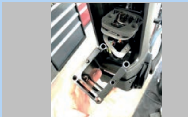
Abbildung 65: PowerTube Adapter herausziehen
