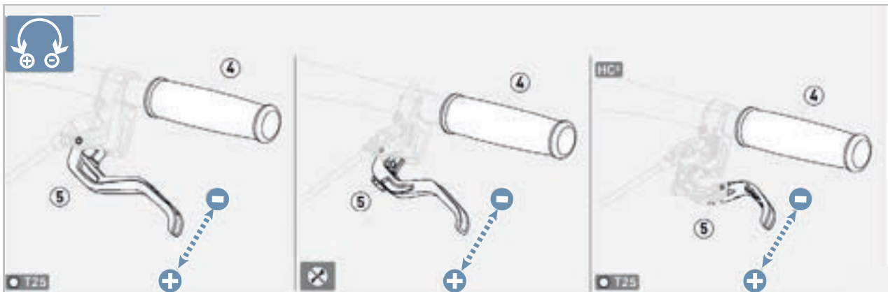
Abbildung 110: Griffweite Handbremse MAGURA Scheibenbremse einstellen
