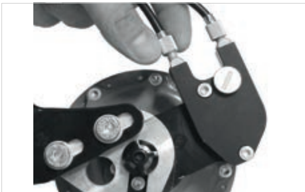
Abbildung 179: ROHLOFF-Naben Versionen mit externer Schaltansteuerung haben die Zugeinsteller an der Seilbox, die sich auf der linken Seite befindet
