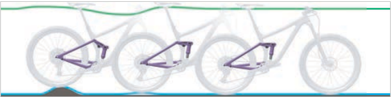
Abbildung 192: Zu schnelles Ausfedern des Hinterbau-Dämpfers
