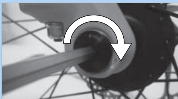
Abbildung 77: Achse in Pfeilrichtung anziehen
