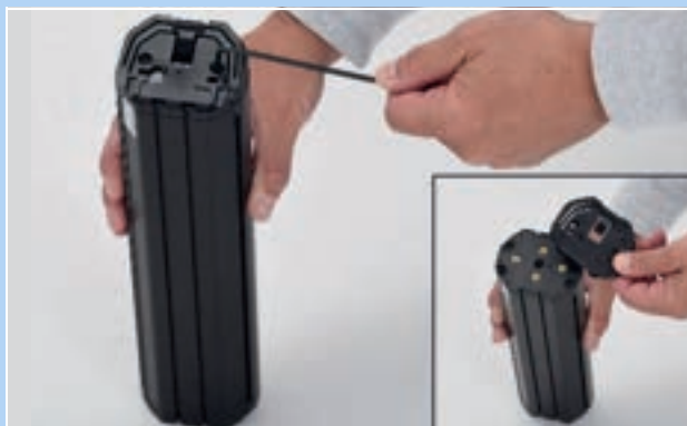
Abbildung 68: Demontage oberes Interface
