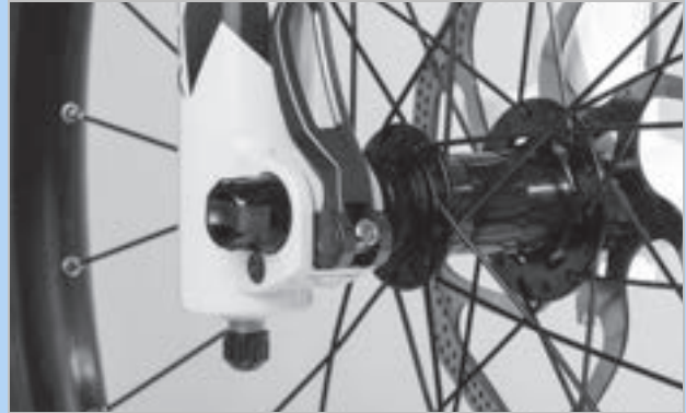
Abbildung 182: Spannkraft des Schnellspanners einstellen
