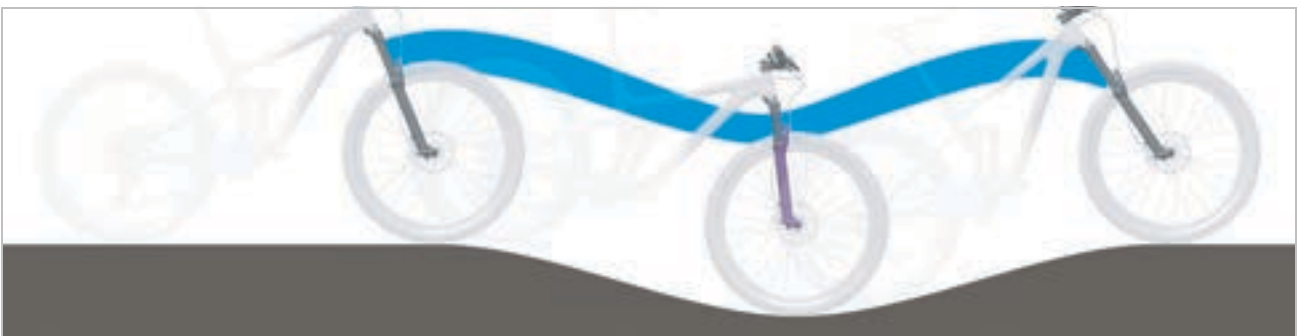
Abbildung 14: Optimales Fahrverhalten der Gabel im hügeligen Gelände
