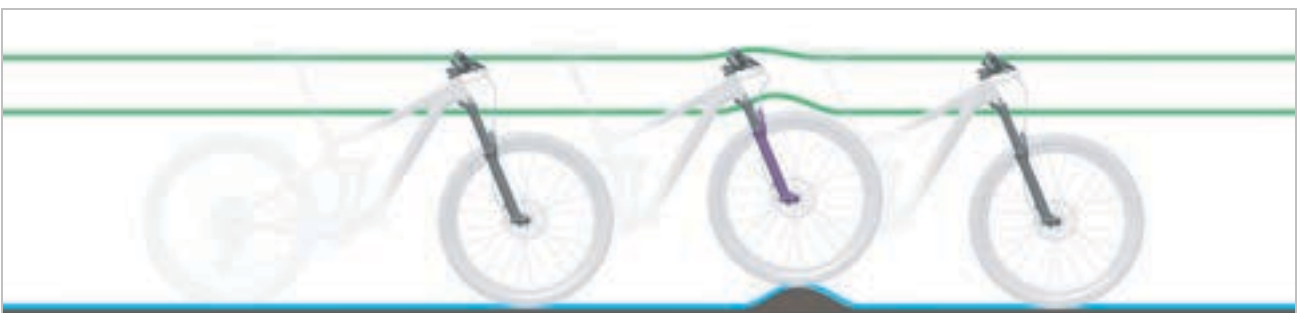
Optimales Fahrverhalten der Gabel bei Unebenheiten
