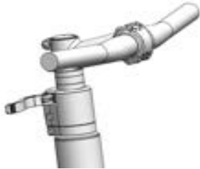
Abbildung 144: All Up mit geöffnetem Vorbau-Spannhebel
