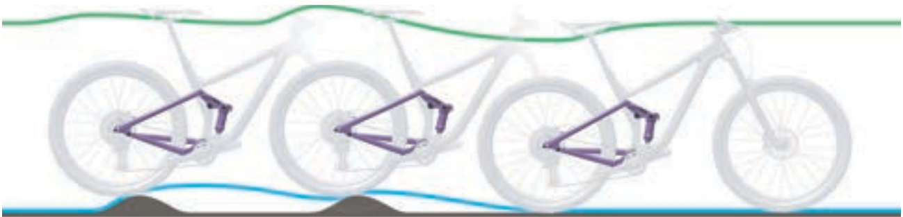
Abbildung 194: Zu langsames Ausfedern des Hinterbau-Dämpfers
