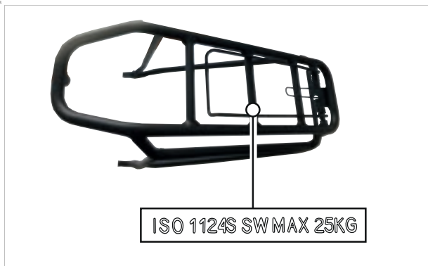
Abbildung 129: Auf dem Gepäckträger ist seine maximale Tragfähigkeit ausgewiesen
