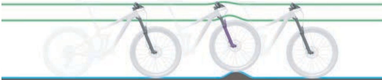
Abbildung 116: Optimales Fahrverhalten der Gabel bei Unebenheiten
