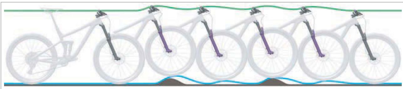
Figura 172: Corsa di estensione troppo veloce della forcella ammortizzata
