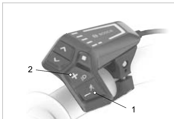
Figura 127: Ubicazione del pulsante più e del pulsante meno
