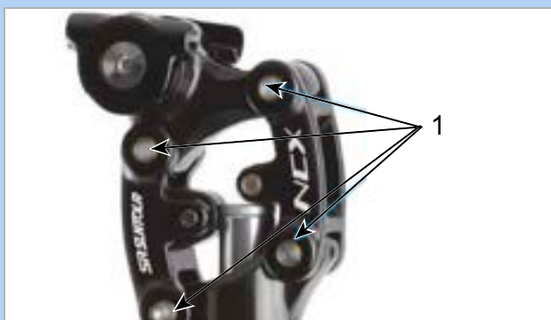
Figura 170: Punti di lubrificazione del canotto reggisella ammortizzato SR SUNTOUR
