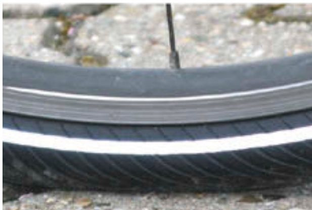
Figura 96: Corretta pressione di gonfiaggio. Lo pneumatico quasi non si deforma sotto il peso corporeo
