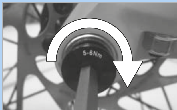
Figura 56: Serraggio della vite di sicurezza
