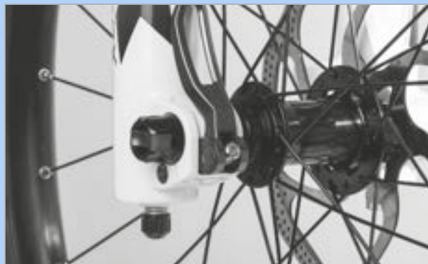
Figura 168: Regolazione della forza di serraggio del bloccaggio rapido
