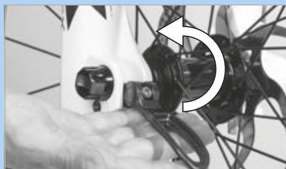
Figura 60: Spinta della leva del bloccaggio rapido nel verso della freccia
