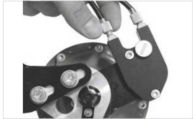
Figura 165: Le versioni del mozzo ROHLOFF con comando esterno del cambio hanno i regolatori del tensionamento sulla scatola dei cavi situata sul lato sinistro
