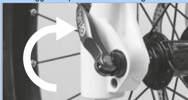
Figura 66: Chiusura del bloccaggio rapido
