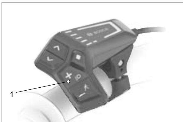
Figura 124: Ubicazione del tasto luce di marcia (1)
