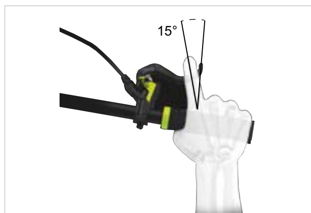
Figura 98: Posizione del freno a mano
