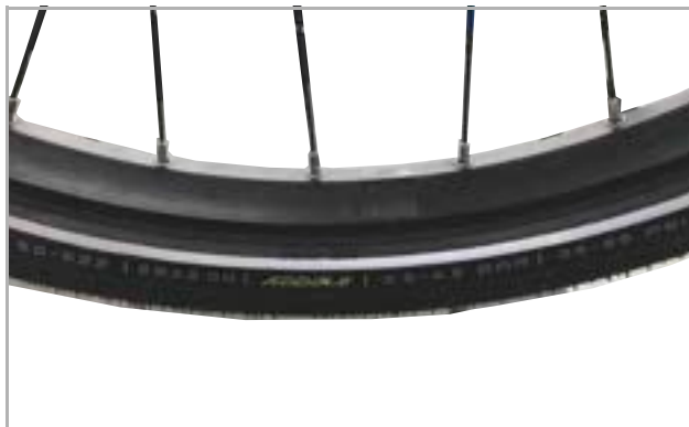
Figura 20: Esempio: Informazioni riportate sullo pneumatico
