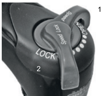
Abbildung 78: Suntour-Druckstufeneinsteller mit den Positionen OPEN (1) und LOCK (2)
