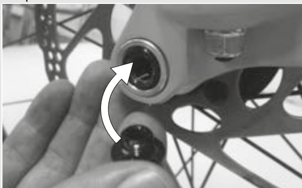
Figura 28: Applicazione della leva del bloccaggio rapido nel perno
