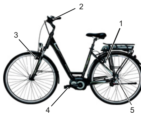
Figura 12: Sistema frenante di un pedelec con un freno a contropedale, esempio
