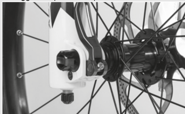
Figura 86: Regolazione della forza di serraggio del bloccaggio rapido
