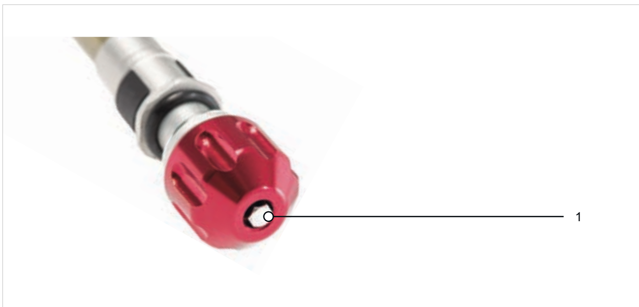
Illustration 190 : Exemple d'une vis de détente SR SUNTOUR (1)
