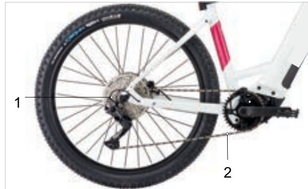
Illustration 46 : Schéma de l'entraînement à chaîne avec dérailleur
