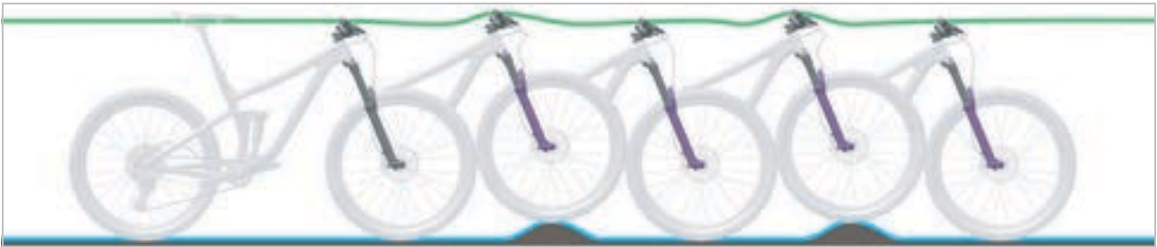
Illustration 16 : Comportement optimal de la fourche
