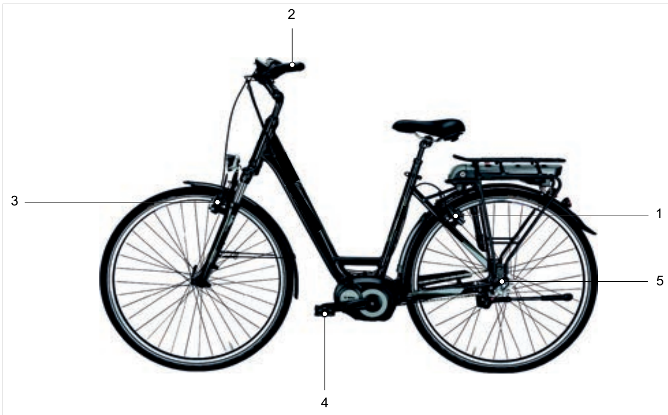
Illustration 44 : Système de frein avec un frein à rétropédalage, exemple
