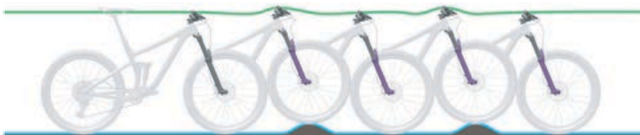
Illustration 115 : Comportement optimal de la fourche
