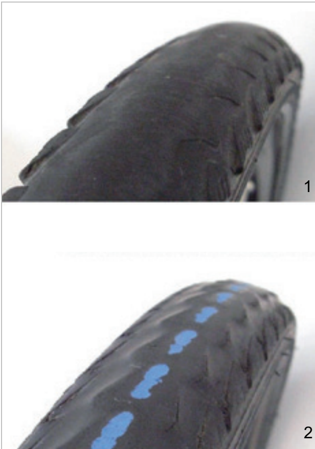
Illustration 152 : Pneu sans profil pouvant être changé (1) et pneu avec protection anti-crevaison visible (2) devant être changé
