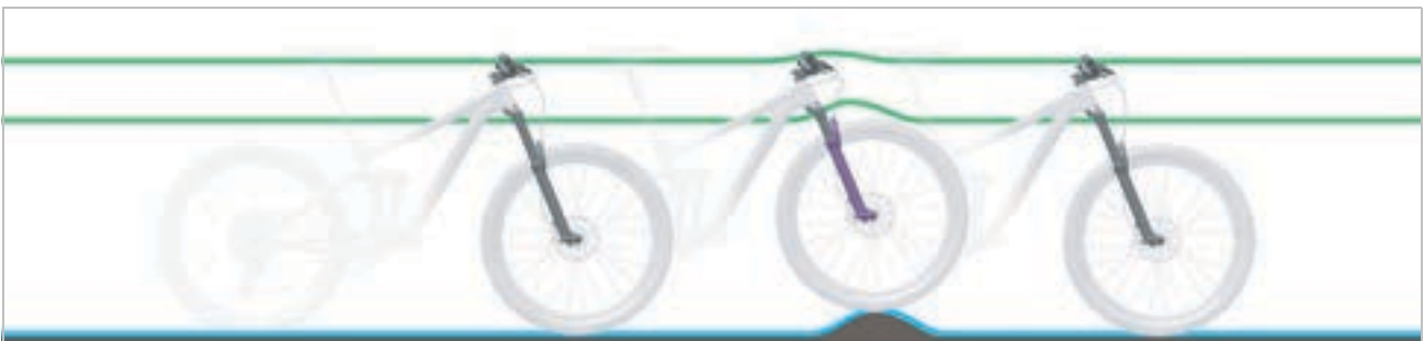
Illustration 15 : Comportement optimal de la fourche sur les irrégularités
