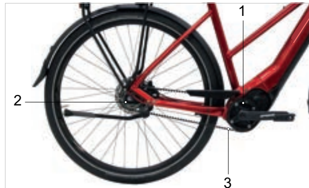
Illustration 47 : Schéma de l'entraînement à courroie
