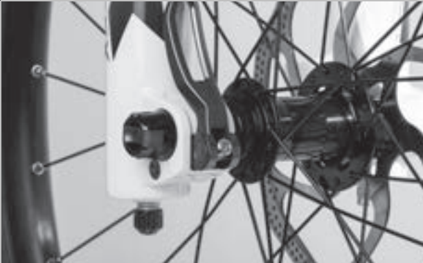
Illustration 85 : Position parfaite du levier de serrage
