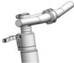
Illustration 145 : All Up avec levier de serrage de la potence ouvert
