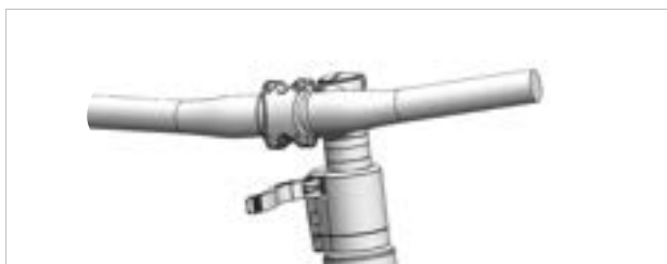
Illustration 127 : Exemple d'un All Up avec levier de serrage de la potence ouvert
