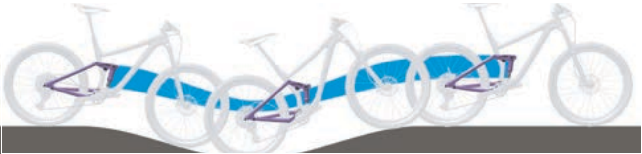
Illustration 197 : Suspension trop souple de l'amortisseur arrière dans les côtes
