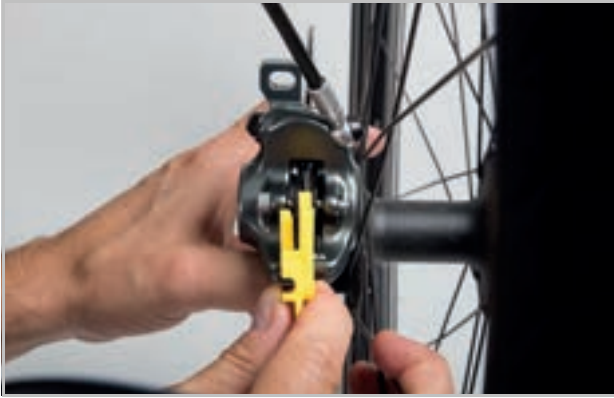
Illustration 154 : Contrôler la plaquette de frein montée à l'aide de la cale de transport
