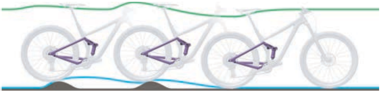
Illustration 195 : Détente trop lente de l'amortisseur arrière
