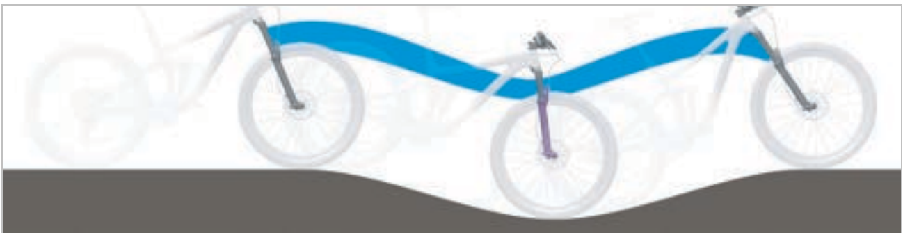
Illustration 14 : Comportement optimal de la fourche en terrain vallonné
