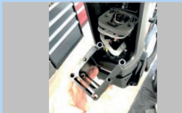
Illustration 66 : Retirer l'adaptateur PowerTube
