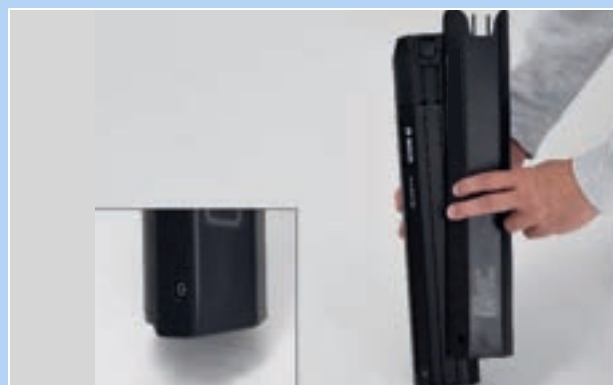
Illustration 75 : Enfoncer le capot de batterie sur la batterie
