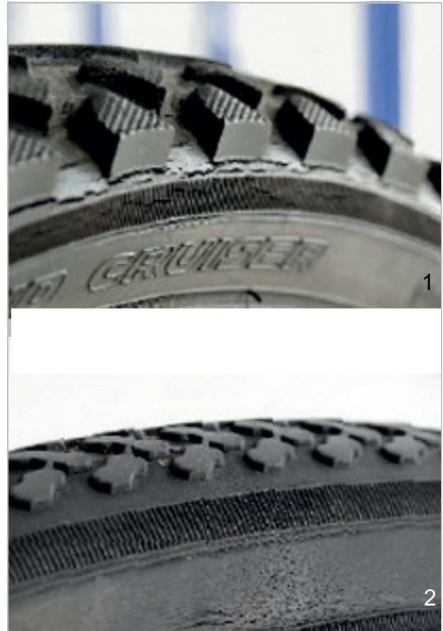
Illustration 153 : Exemples de fissures de fatigue (1) et de fissures d'âge (2)
