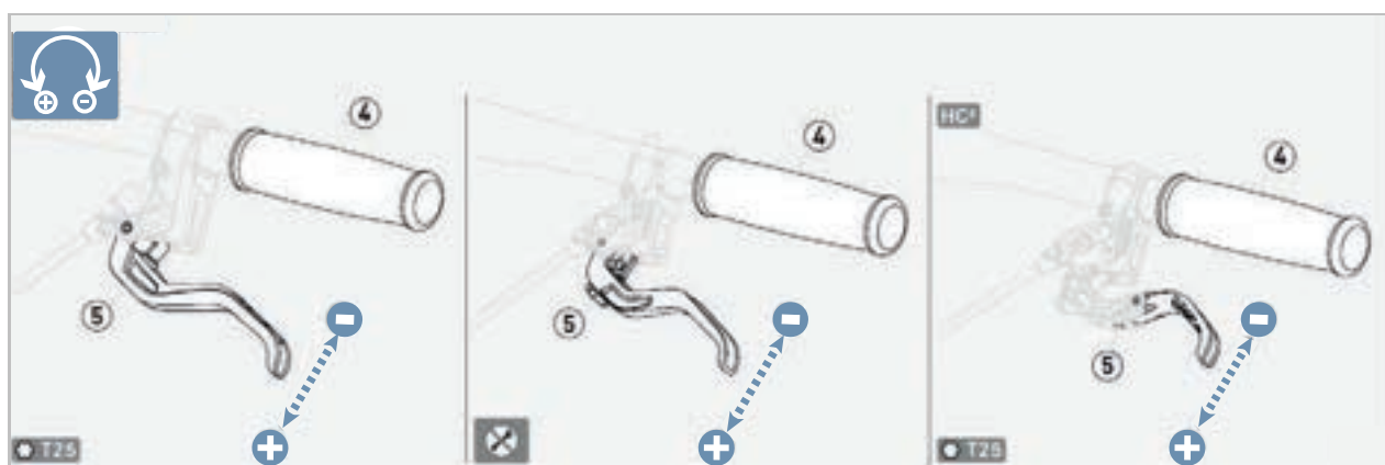
Illustration 111 : Régler la garde d'un levier de frein à disque MAGURA
