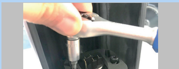
Illustration 63 : Desserrez les vis du logement de batterie
