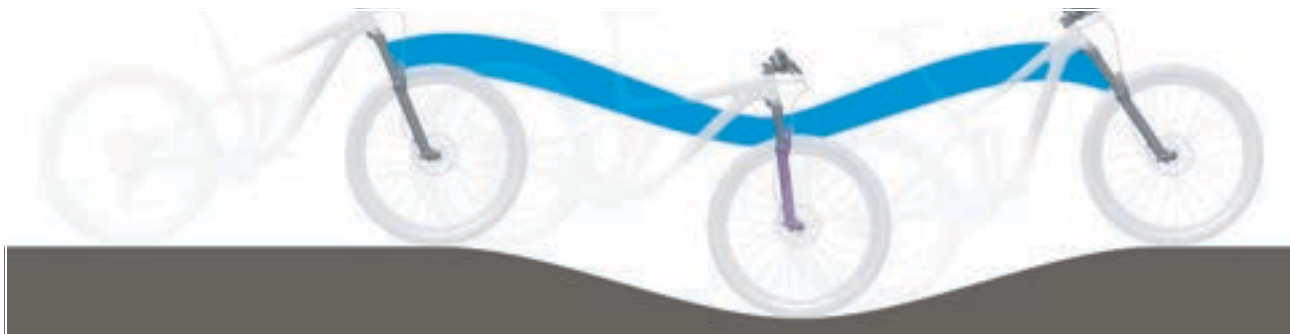
Illustration 116 : Comportement optimal de la fourche en terrain vallonné
