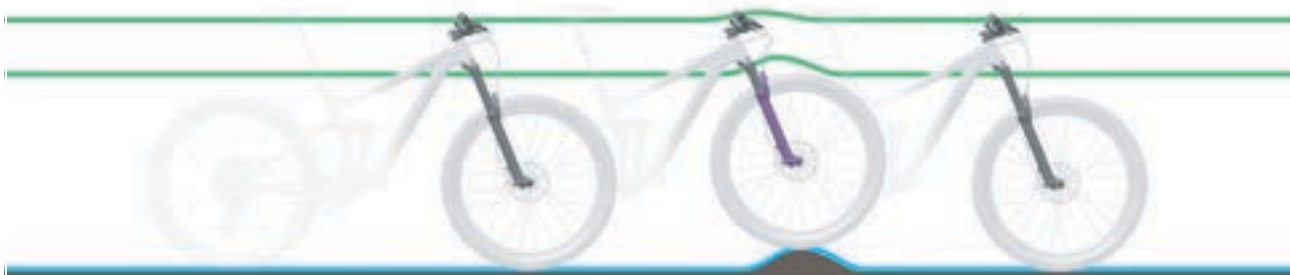
Illustration 117 : Comportement optimal de la fourche sur les irrégularités
