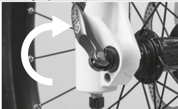
Rysunek 40: Zamykanie zacisku szybko mocującego
