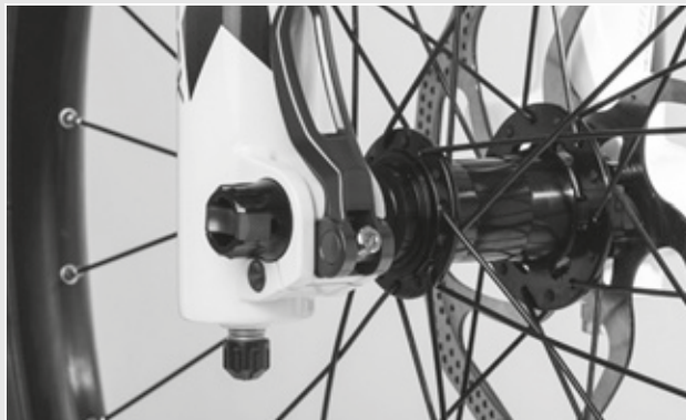
Rysunek 84: Ustawianie siły mocowania zacisku szybkomocującego
