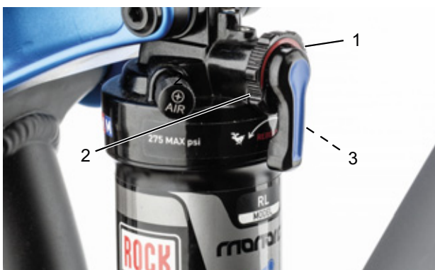
Rysunek 79: Ustawianie twardości tłumika odbicia za pomocą pokrętła regulacyjnego (1)
