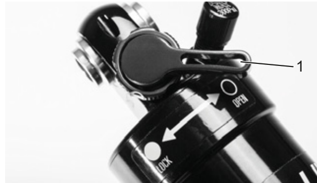
Rysunek 77: Nastawnik dobicia Suntour w pozycji otwartej (1)
