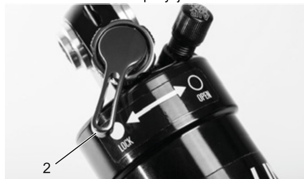
Rysunek 78: Nastawnik dobicia Suntour w pozycji zamkniętej (2)
