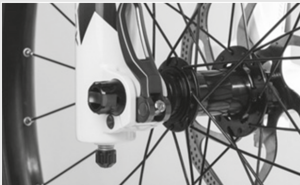
Rysunek 35: Optymalne położenie dźwigni mocującej
