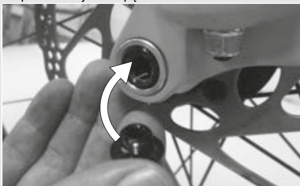
Rysunek 27: Sposób wsuwania dźwigni zacisku szybko mocującego w oś
