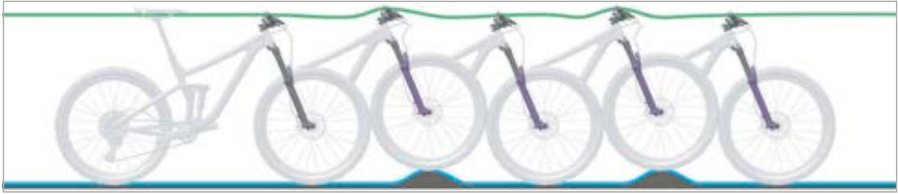
134. ábra: A villa optimális menetviselkedése
