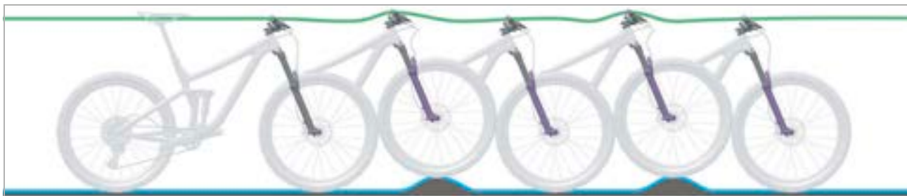
18. ábra: A villa optimális menetviselkedése
