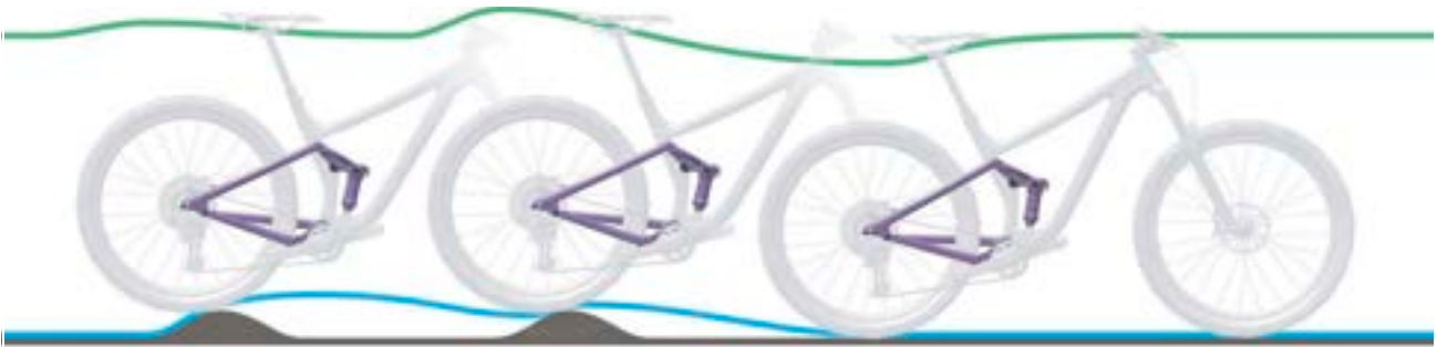
236. ábra: A hátsó lengéscsillapító túl lassú kirugózása
