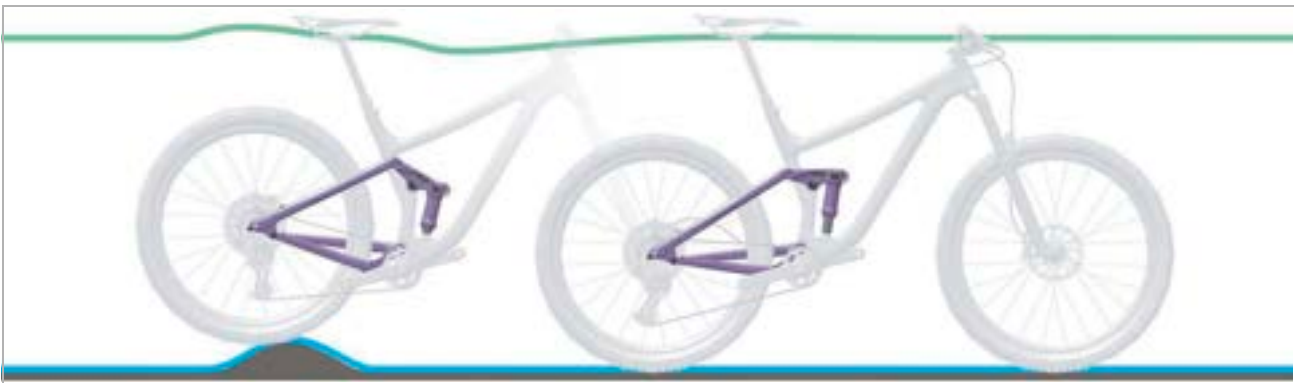
168. ábra: A hátsó lengéscsillapító optimális menetviselkedése egyenetlenségeknél
