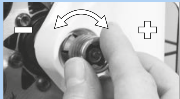
96. ábra: A feszítés beállítása
