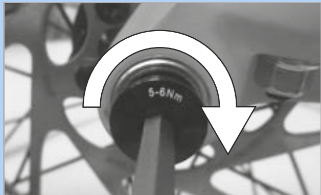
87. ábra: A rögzítőcsavar meghúzása
