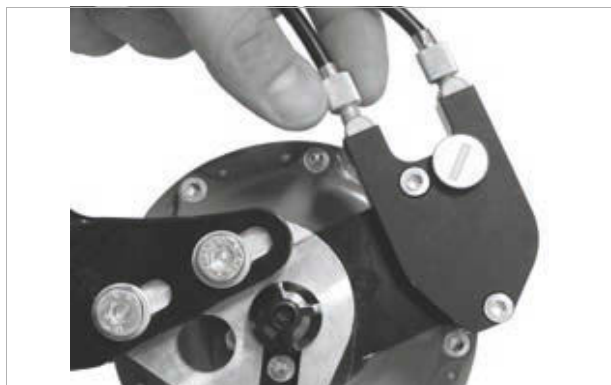
221. ábra: Külső váltóvezérléssel rendelkező ROHLOFF agyváltózatok húzásbeállítója a kötéldobozon van, ami a bal oldalon található
