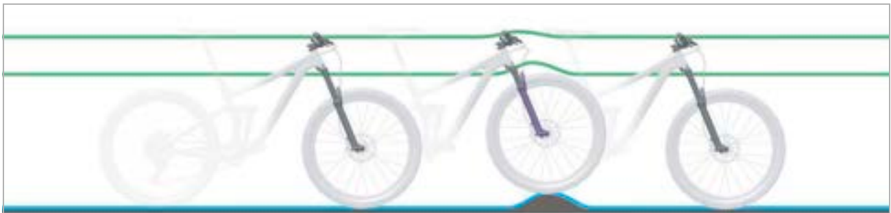
136. ábra: A villa optimális menetviselkedése egyenetlenségek esetén
