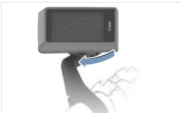
153. ábra: A kijelző elforgatása az óramutató járásával egyező irányban
