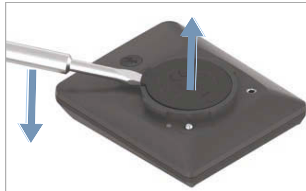
150. ábra: Elemrekesz-fedél felemelése
