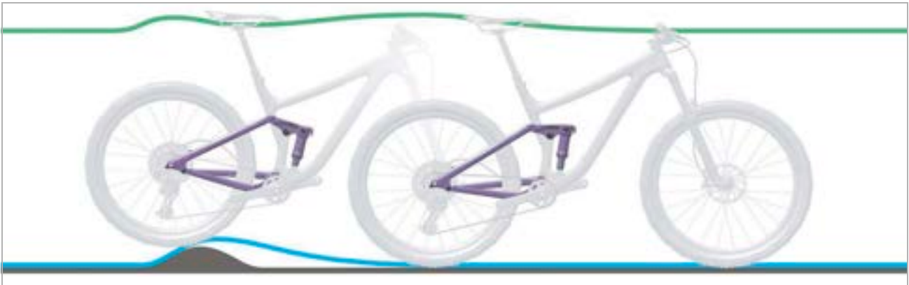
240. ábra: A hátsó lengéscsillapító túl kemény csillapítása egyenetlenségeknél
