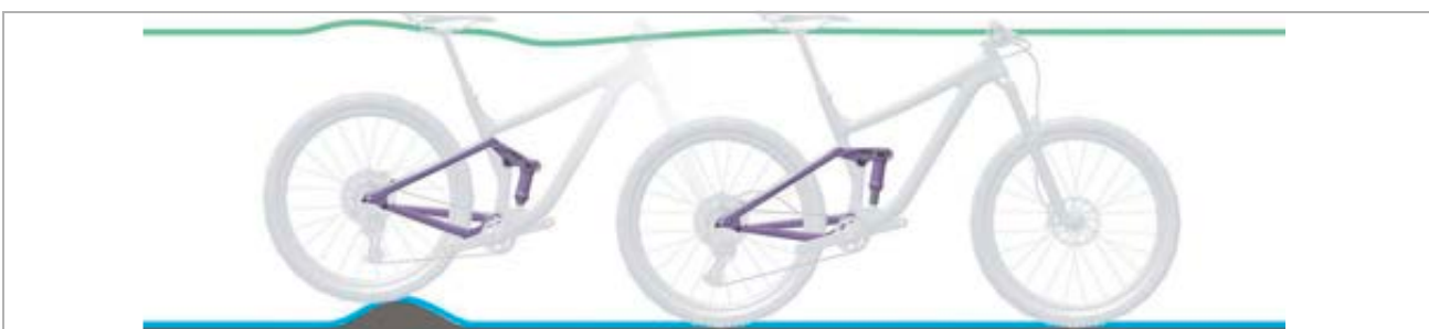
141. ábra: A hátsó lengéscsillapító optimális menetviselkedése egyenetlenségeknél
