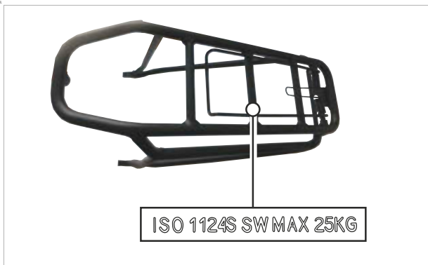
161. ábra: A csomagtartón fel van tüntetve a maximális teherbírása
