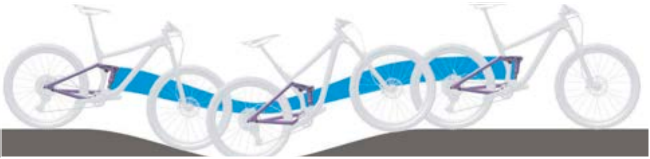
238. ábra: A hátsó lengéscsillapító túl puha rugózása hegymenetben
