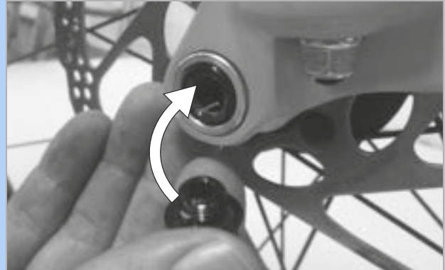
86. ábra: Rögzítőcsavar beszerelése
