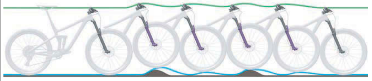
228. ábra: A teleszkópos villa túl gyors kirugózása
