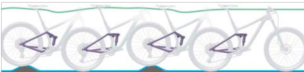
5. ábra: A hátsó lengéscsillapító optimális menetviselkedése
