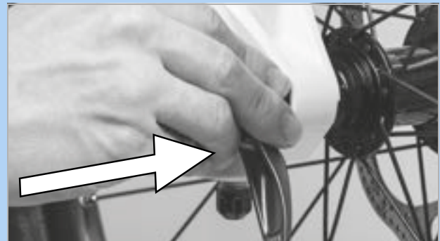
95. ábra: A gyorsár betolása nyilirányban
