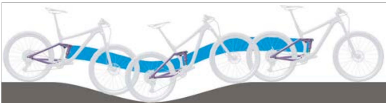
6. ábra: A hátsó lengéscsillapító optimális menetviselkedése dombos terepen
