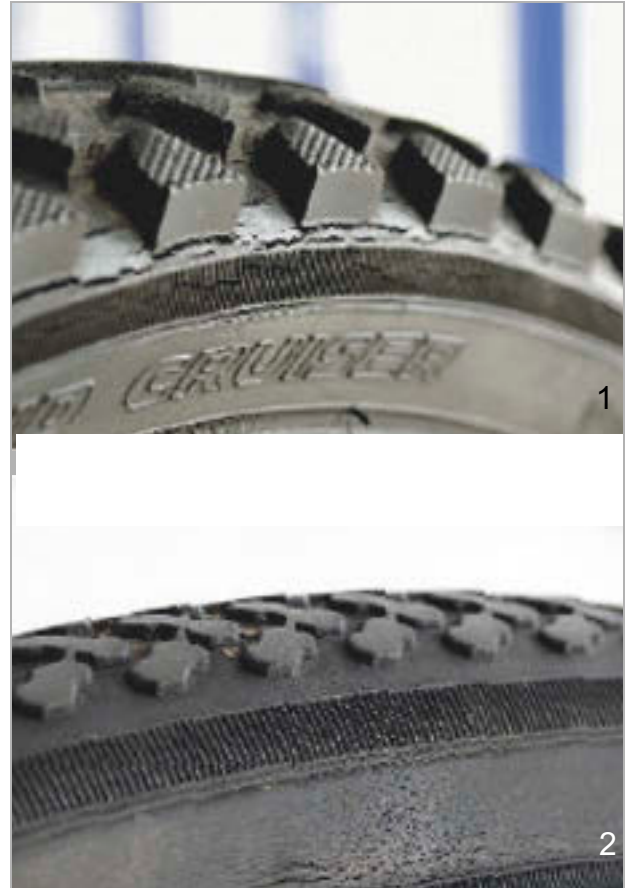
195. ábra: Példák kifáradási repedésekre (1) és öregedési repedésekre (2)
