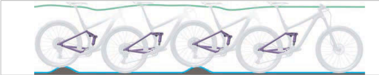
139. ábra: A hátsó lengéscsillapító optimális menetviselkedése
