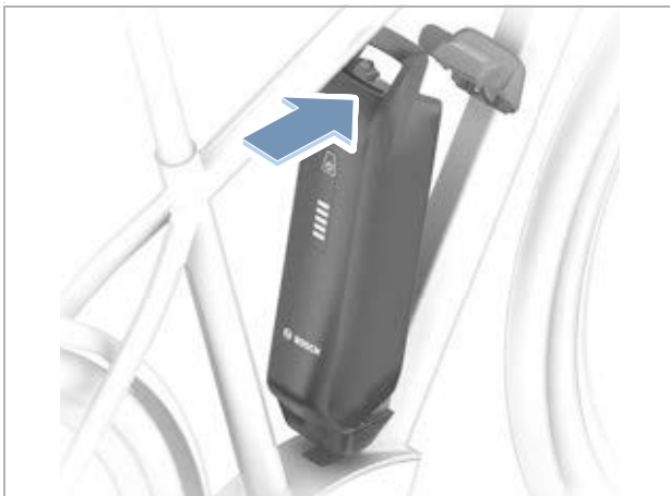
173. ábra: PowerPack akkumulátor felfelé hajtása
