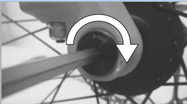
85. ábra: A tengely meghúzása nyírányban
