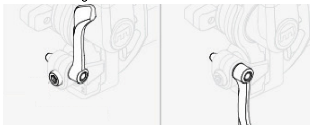
Illustration 10 : Levier de verrouillage du frein de jante, fermé (1) et ouvert (2)
