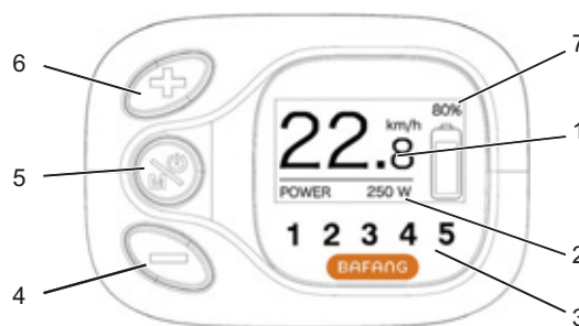
Illustration 16 : Aperçu de la structure et des éléments de commande de l'écran
