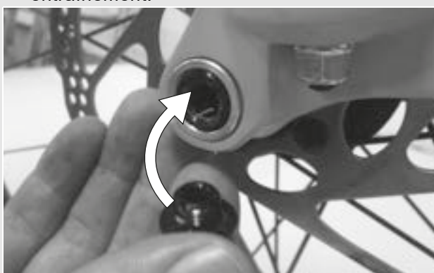
Illustration 22 : Enfoncer le levier d'attache rapide dans l'axe
