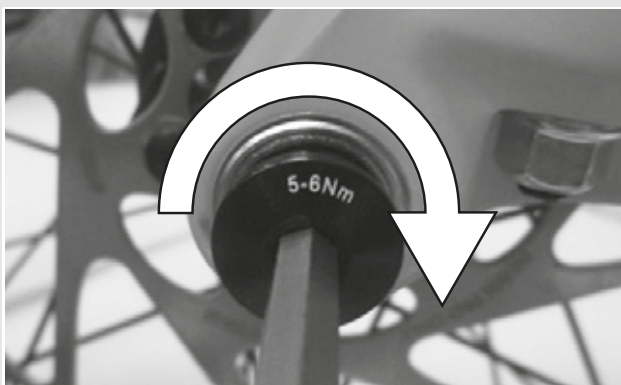
Illustration 23 : Serrer la vis de blocage
