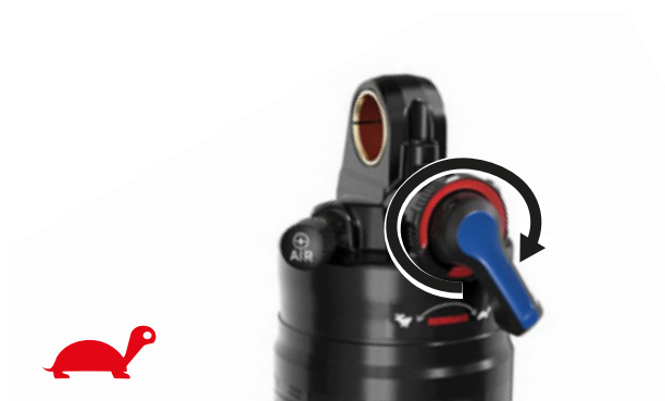
Figura 66: Riduzione della velocità di estensione
