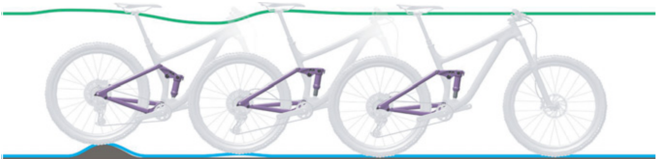
Figura 97: Corsa di estensione troppo veloce dell'ammortizzatore del carro posteriore
