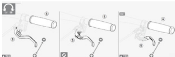
Figura 51: Regolazione dell'ampiezza di presa della leva del freno Magura con freno a disco
