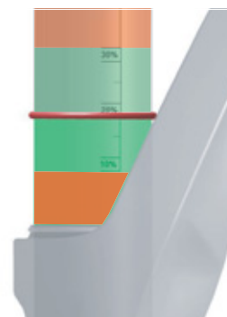
Figura 58: Intervallo prescritto della SAG (verde) e intervallo vietato della SAG
