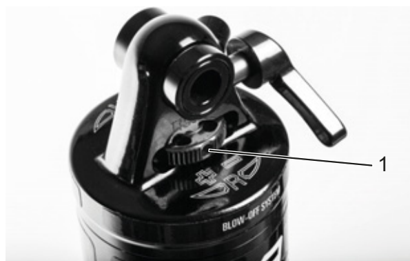
Figura 64: Regolatore del rebound Suntour (1) sull'ammortizzatore del carro posteriore
