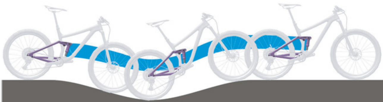
Figura 68: Comportamento di marcia ottimale dell'ammortizzatore del carro posteriore su un terreno con dossi
