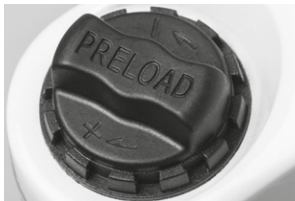
Figura 53: Manopola di regolazione della SAG sulla corona della forcella ammortizzata
