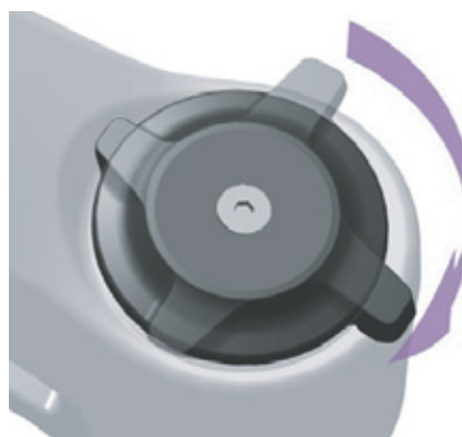
Figura 78: Regolazione più rigida del regolatore dello stadio di compressione
