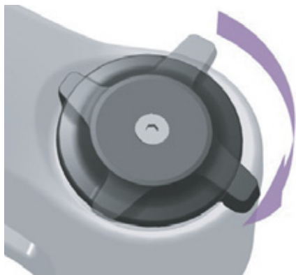
Figura 94: Regolazione più rigida del regolatore dello stadio di compressione
