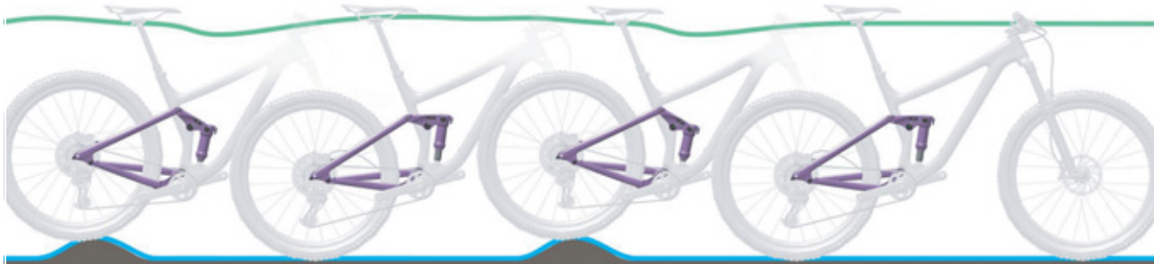
Figura 10: Comportamento di marcia ottimale dell'ammortizzatore del carro posteriore
