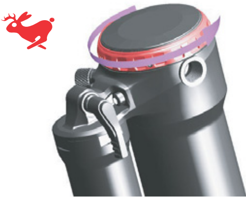
Figura 100: Rotazione dell'ammortizzatore a stadi di trazione in direzione lepre
