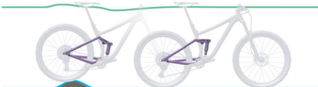
Figura 12: Comportamento di marcia ottimale dell'ammortizzatore del carro posteriore su asperità
