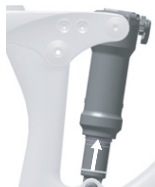
Figura 60: Spostamento dell'O-ring sull'ammortizzatore del carro posteriore
