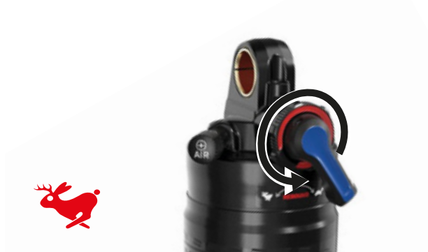
Figura 67: Aumento della velocità di estensione
