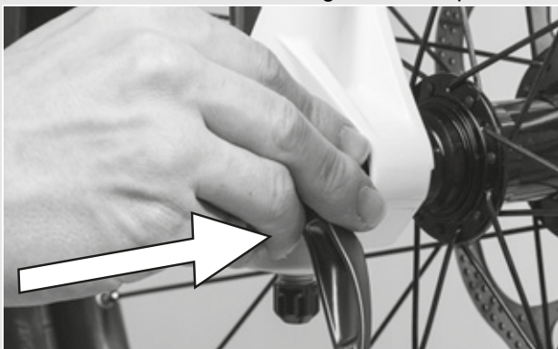
Figura 35: Inserimento del bloccaggio rapido
