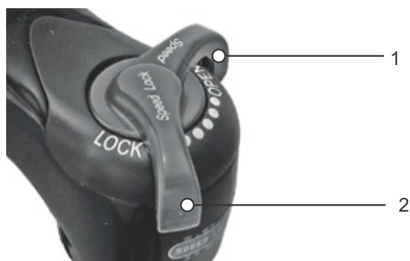
Figura 77: Ammortizzatore a stadi di pressione Suntour in posizione aperta (1) e chiusa (2)
