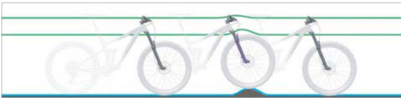
Afbeelding 106: Optimaal rijgedrag van de vork bij oneffenheden
