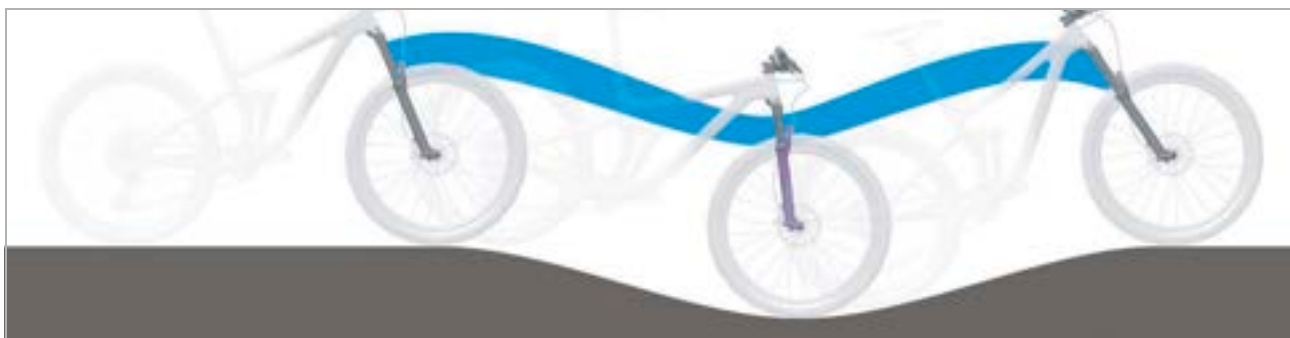
Afbeelding 105: Optimaal rijgedrag van de vork in heuvelachtig terrein
