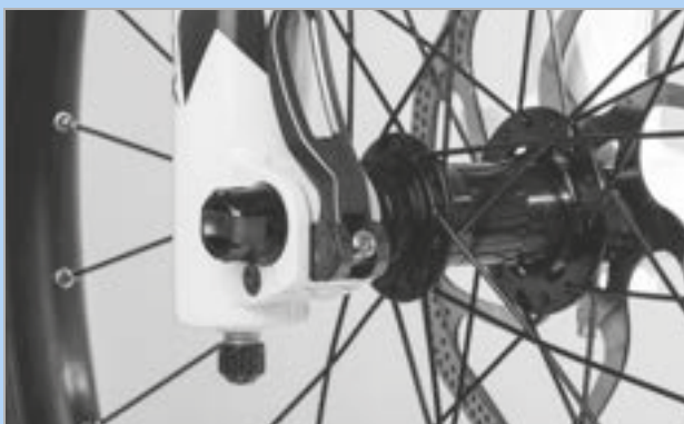
Afbeelding 61: Perfecte stand van de spanhendel
