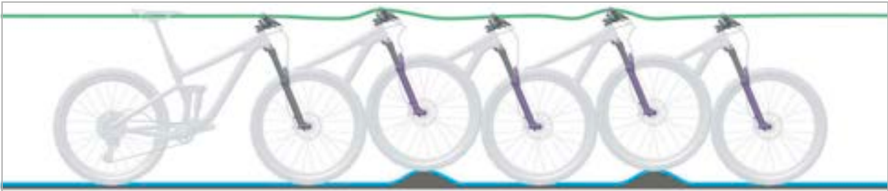
Afbeelding 12: Optimaal rijgedrag van de vork
